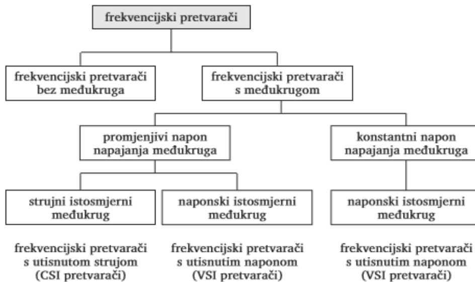
Slika 2.1. Podjela frekventnih pretvarača [2]
