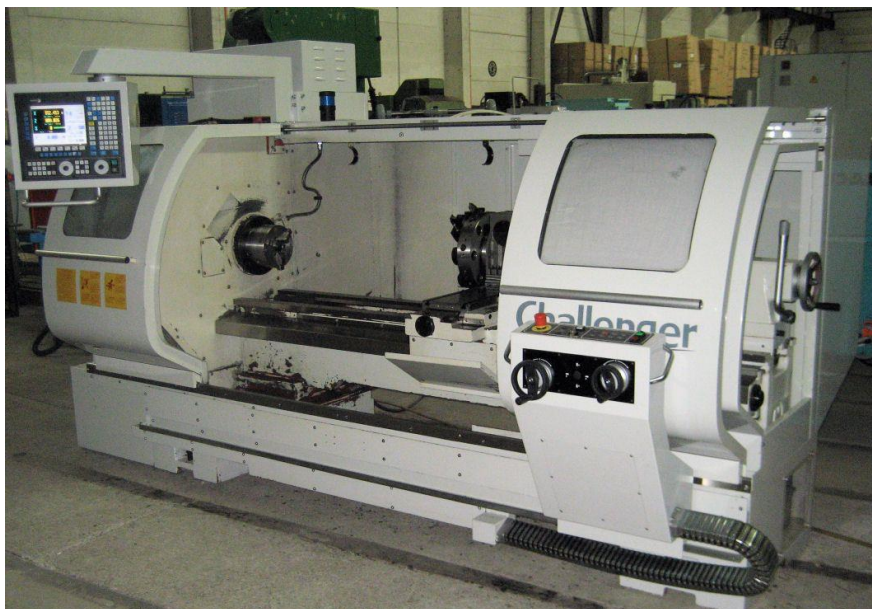
Slika 18. CNC Microcut tokarilica
