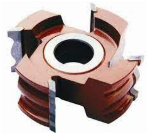
Slika 11. Glodalo s lemljenim pločicama
