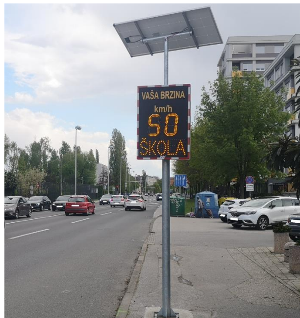
Slika 6.3. Radar s pokazivačem brzine [36]
