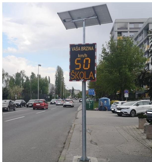
Slika 6.3. Radar s pokazivačem brzine
