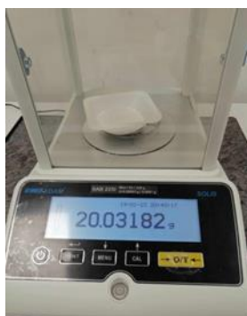
Slika 5. Analitička vaga (Adam Equipment, Kina) Izvor: vlastita fotografija
