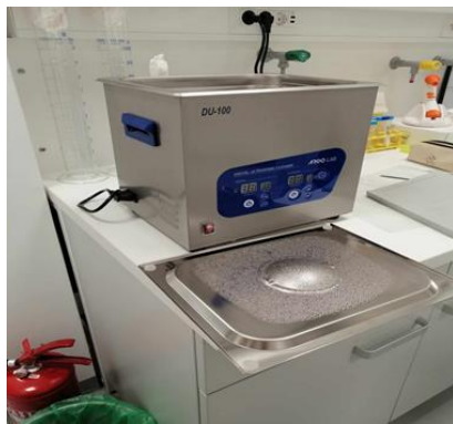
Slika 8. Ultrazvučna kupelj (Argolab, Italija) Izvor: vlastita fotografija
