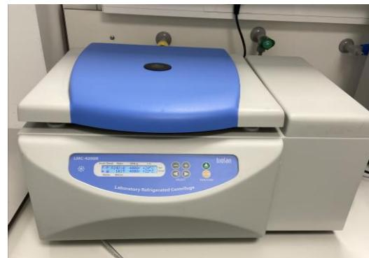
. Centrifuga (LCM-4200R, Biosan, Latvija)
