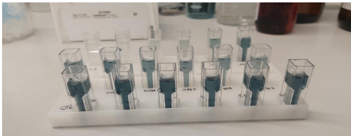
Slika 11: Mjerenje ukupnih polifenola u uzorku lišća
