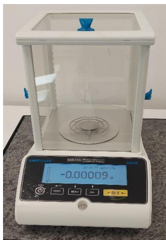
Analitička vaga Adam Equipment Ujedinjeno Kraljevstvo
