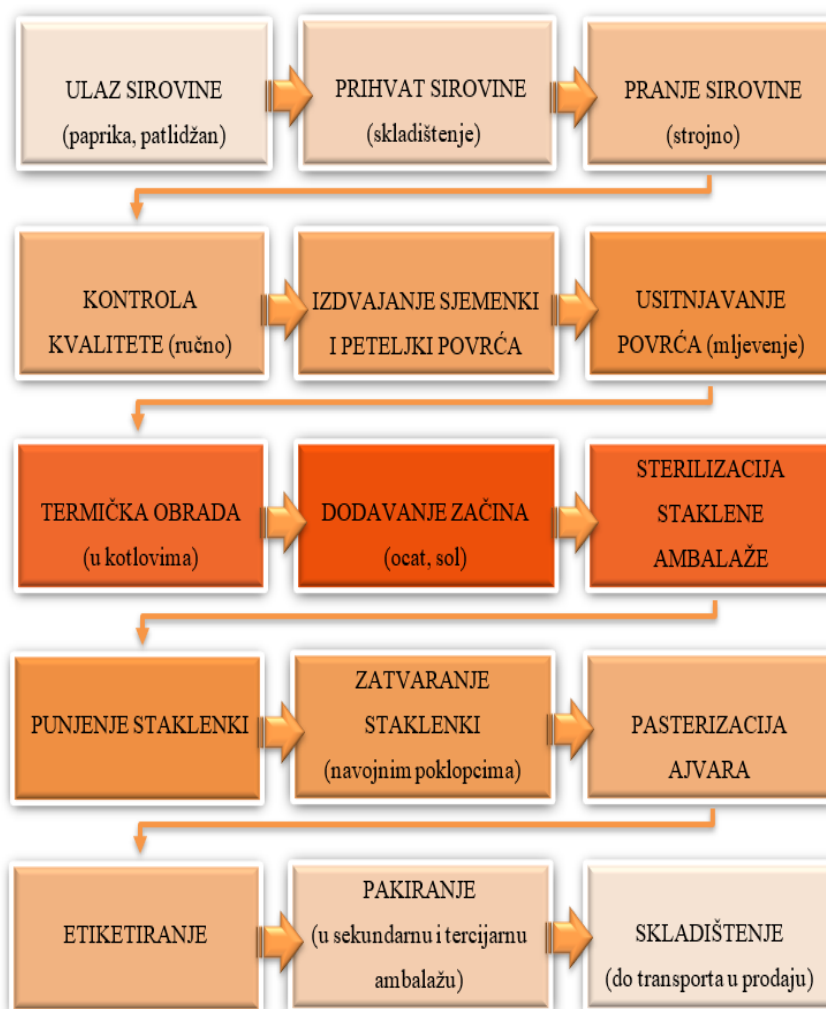
Slika 8. Procesna shema izrade ajvara, izvor: izrada autora
