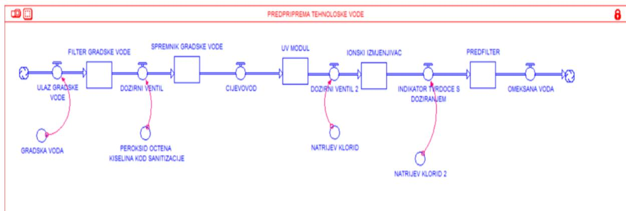
*Slika 25. Računalni model predpripreme tehnološke vode (Izvor:Autor)*
