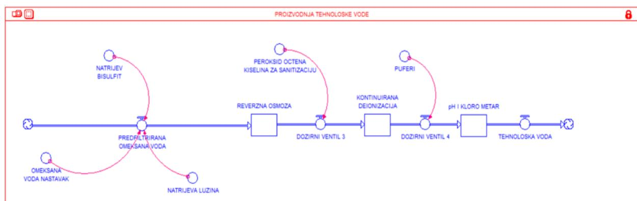
Slika 26. Računalni model proizvodnje tehnološke vode (Izvor:Autor)
