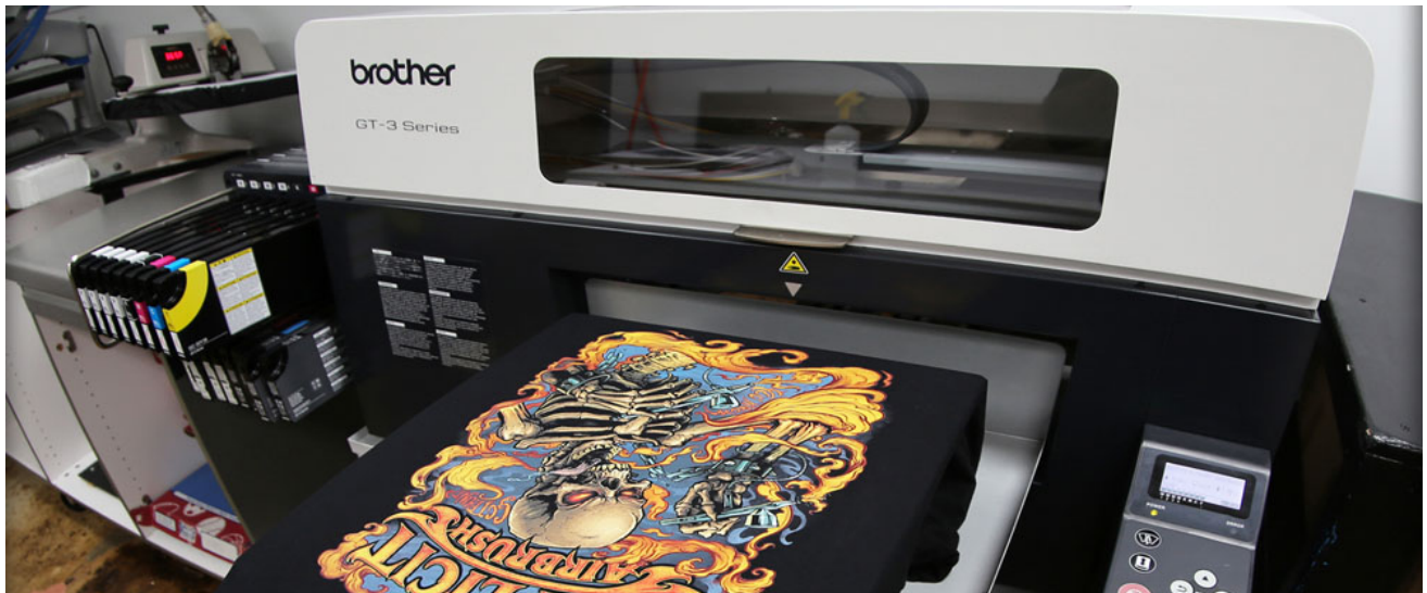
Slika 12. Primjer DTG tiska.
