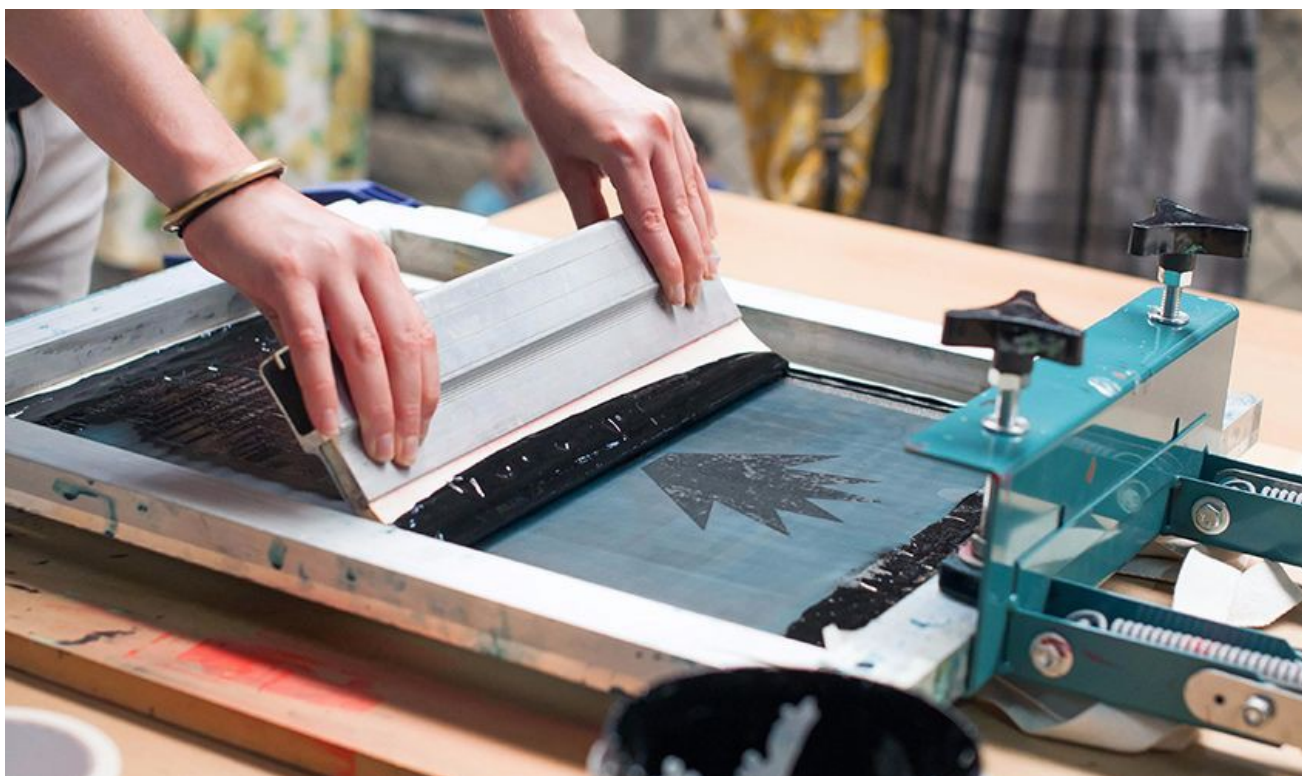
Slika 10. Pritiskanje boja rakelom.
