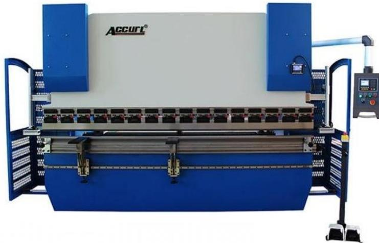
Slika 29. Hidraulična akpant preša [5]
