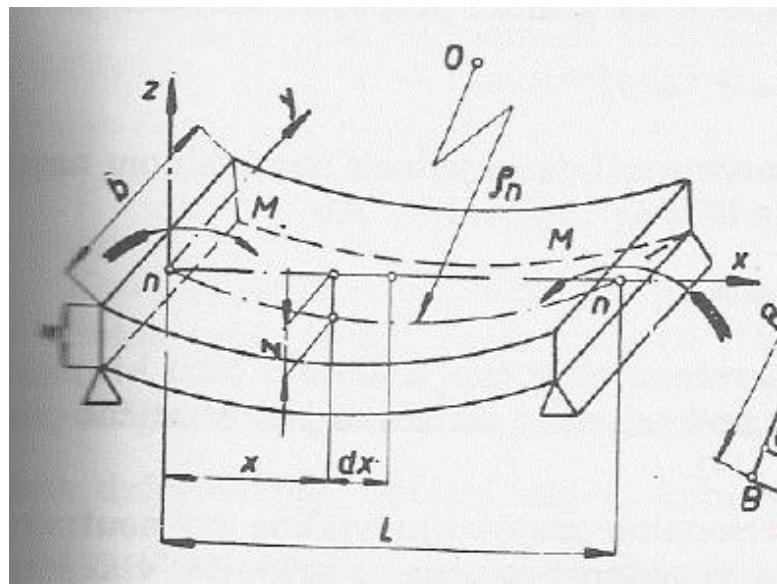
Slika 40. Savijanje nosača [2]
