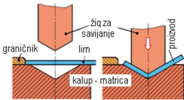
Slika 33. Savijanje s pravocrtnim gibanjem alata [4]
