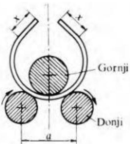
Slika 23. Postupak savijanja na savijalici s tri valjka [2]
