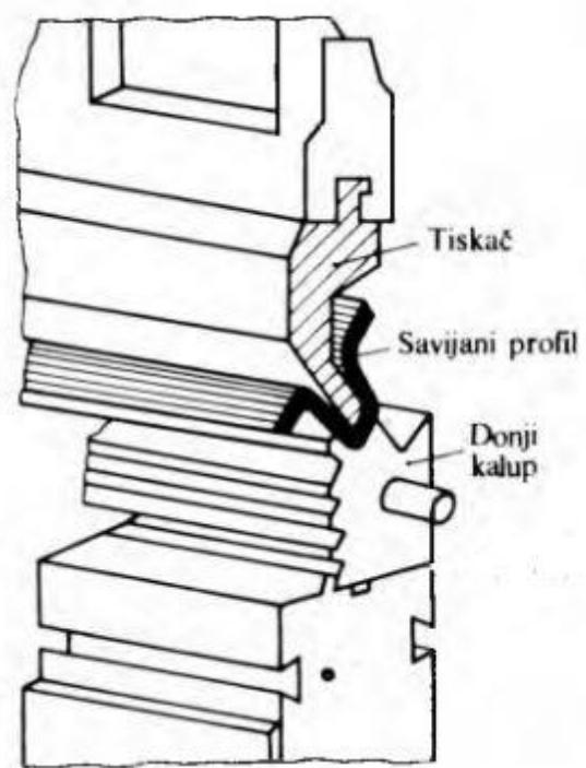
Slika 28. Primjer postupnog savijanja trake [2]
