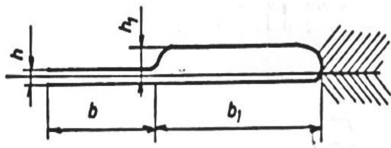
Slika 10. Shematski prikaz kanala za vijenac [2]
