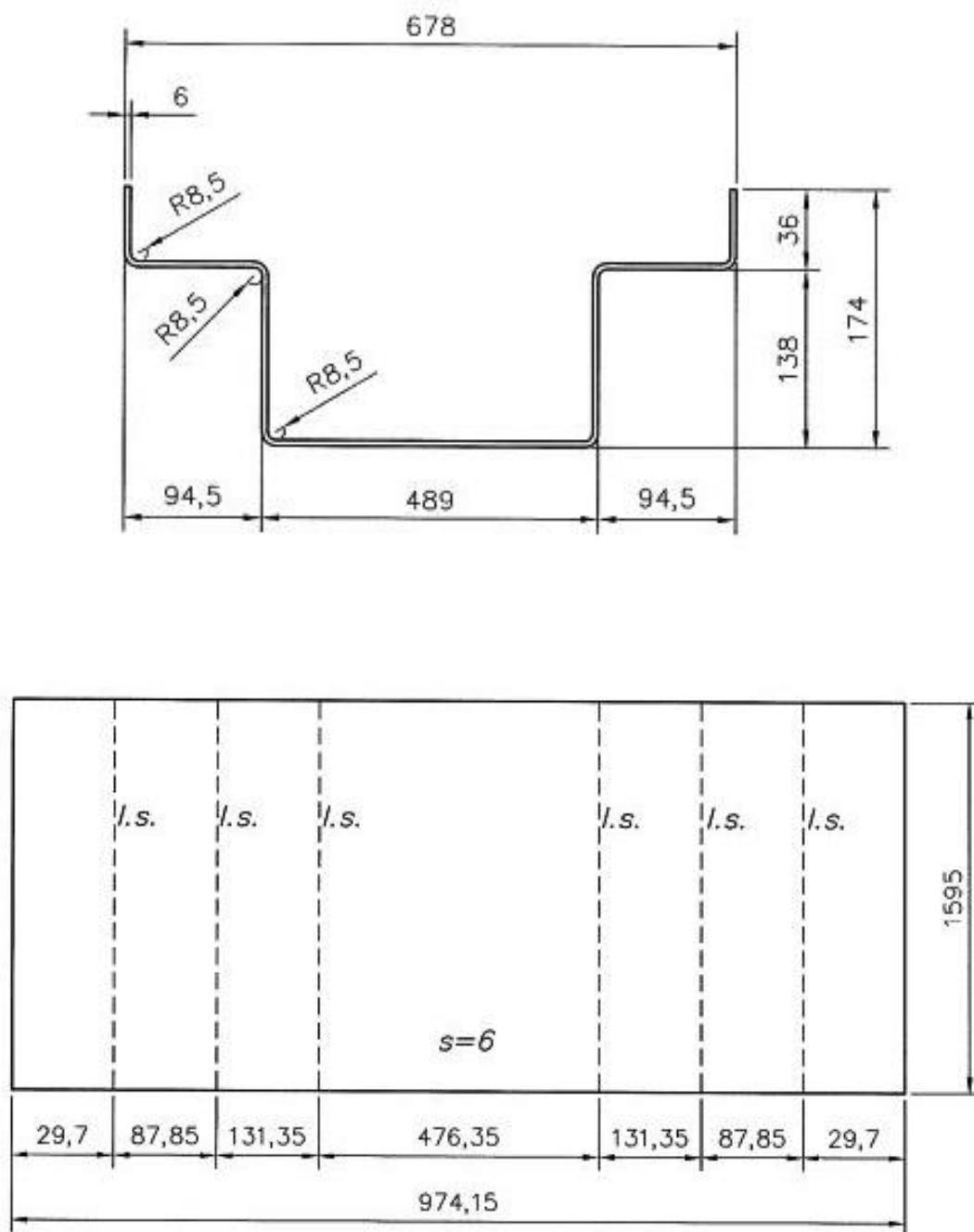
Slika 52. Razvijene mjere profiliranog dna 1;  $K = 0,32$
