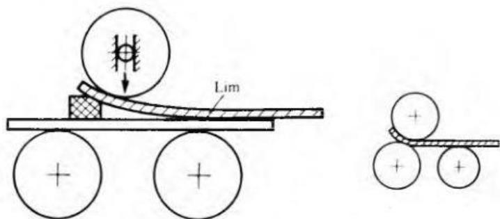
Slika 24. Postupak predsavijanja krajeva lima: a) pomoću grede i b)
