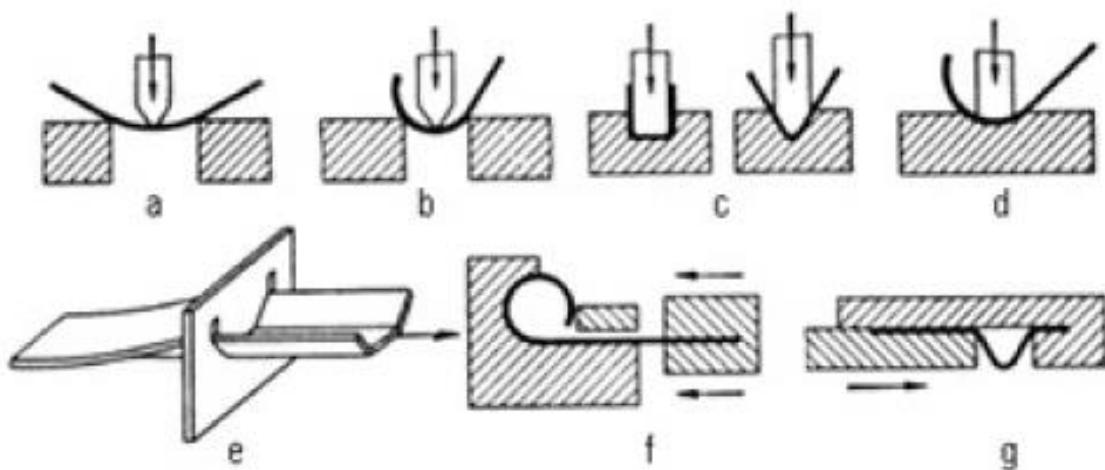
Slika 34. Postupci savijanja s pravocrtnim gibanjem alata [4]
