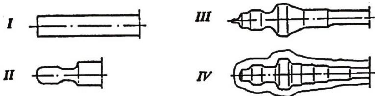
Slika 9. Shematski prikaz postupnog oblikovanja osovine različitim poprečnih presjeka [2]
