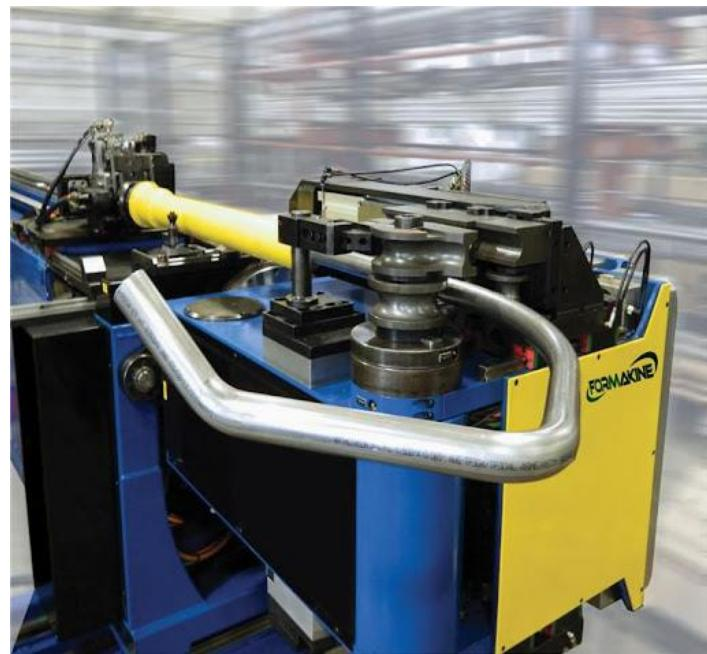
Slika 31. Savijanje cijevi [7]
