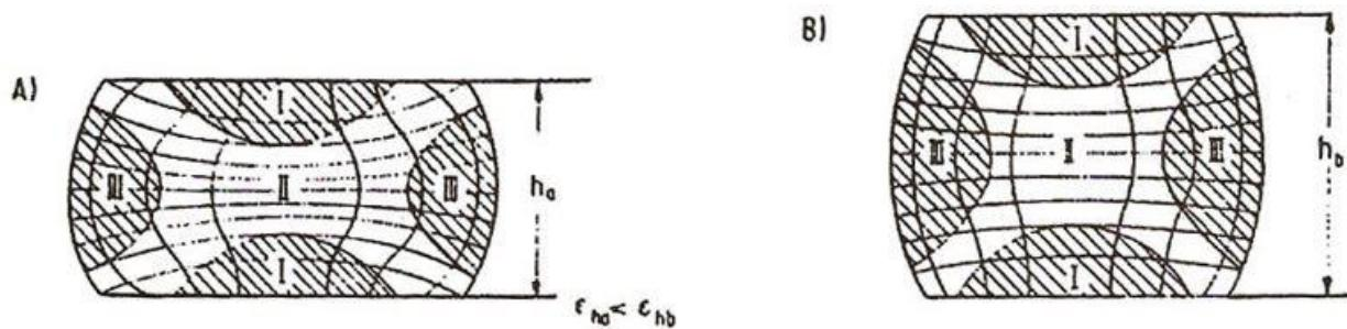
Slika 4. Postupak sabijanja i raspodjela tvrdoće zbog nejednakosti deformacija uslijed trenja: A) Velika deformacija; B) Mala deformacija [2]
