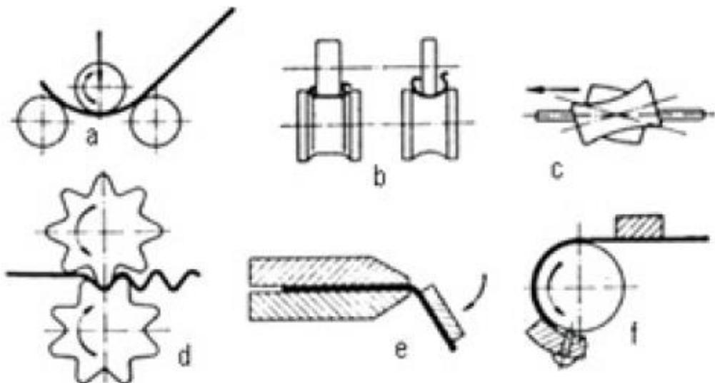
Slika 35. Postupci savijanja s kružnim gibanjem alata [4]
