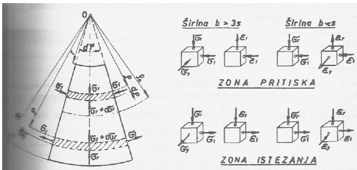
Slika 42. Shema opterećenja i odnos naprezanja i deformacija [2]
