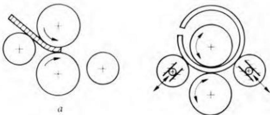
Slika 25. Savijalica s četiri valjka: a) predsavijanje i b) savijanje [2]
