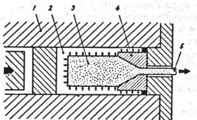
Slika 22. Postupak hidrauličkog istiskivanja profila [2]
