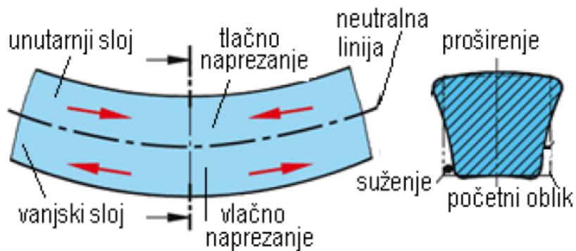
Slika 39. Naprezanje na savijanje i deformacija [4]
