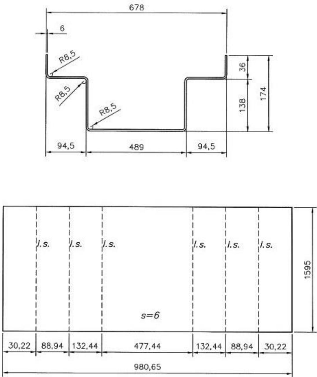
Slika 54. Razvijene mjere profiliranog dna 2;  $K = 0,434$
