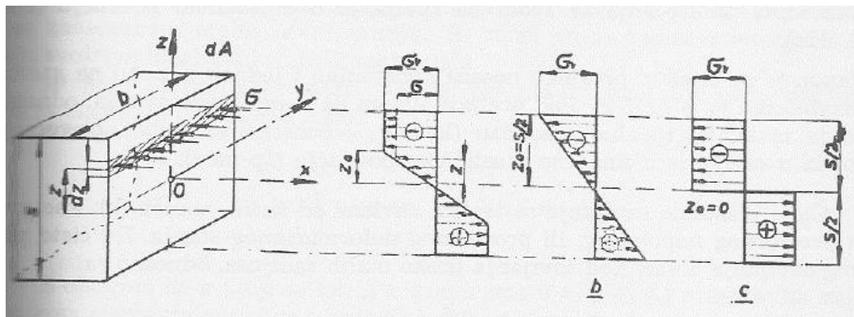
Slika 41. Naprezanja kod savijanja u elastično-plastičnom području [2]
