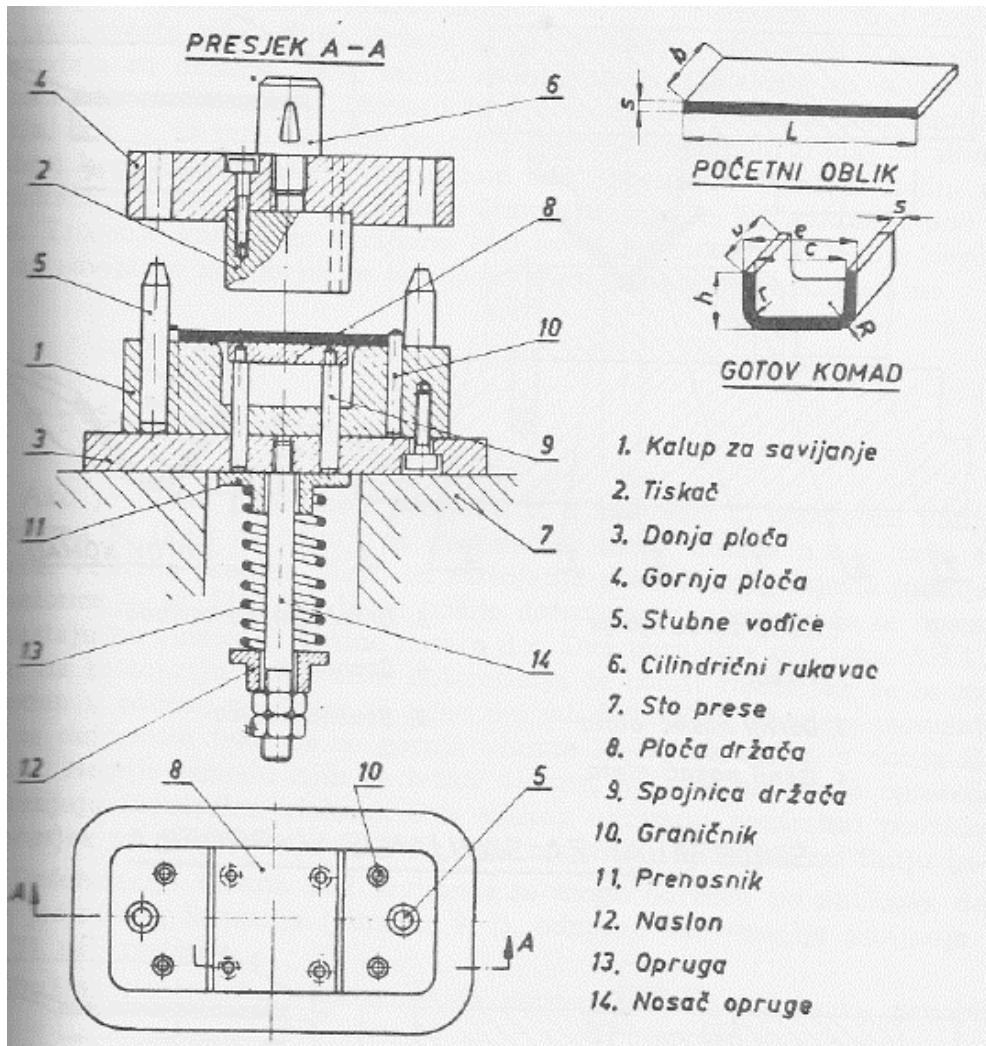
Slika 36. Alat za savijanje U – profila [2]
