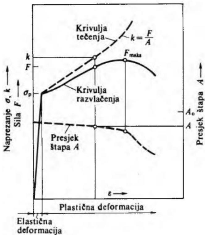
Slika 2. Krivulja razvlačenja i naprezanja plastičnog tečenja [2]
