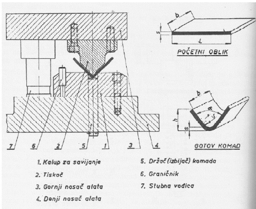
Slika 37. Alat za savijanje V – profila [2]
