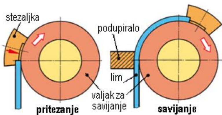
Slika 32. Savijanje s kružnim gibanjem alata [4]
