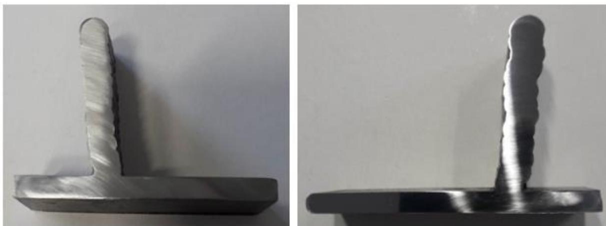
**Slika 47. Obradena površina ispitnog uzorka navarenog strujom jakosti 140 A (lijevo) i strujom jakosti 150 A (desno)**
