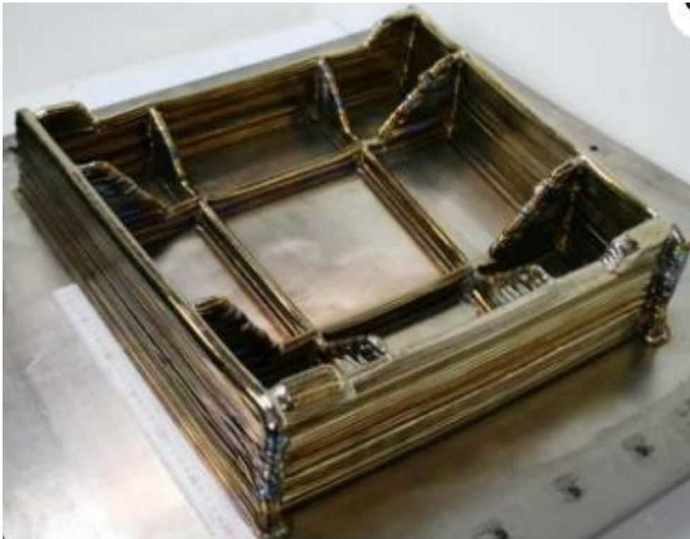
**Slika 13. Nosač kotača aviona izrađen WAAM postupkom [35]**
