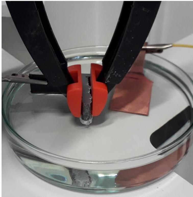
**Slika 49. Elektrokemijska reakcija površine uzorka u solnoj kiselini**
