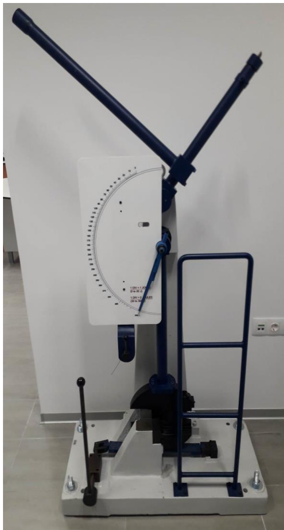
Slika 25. Charpyjev bat Pendulum impact charpy tester
