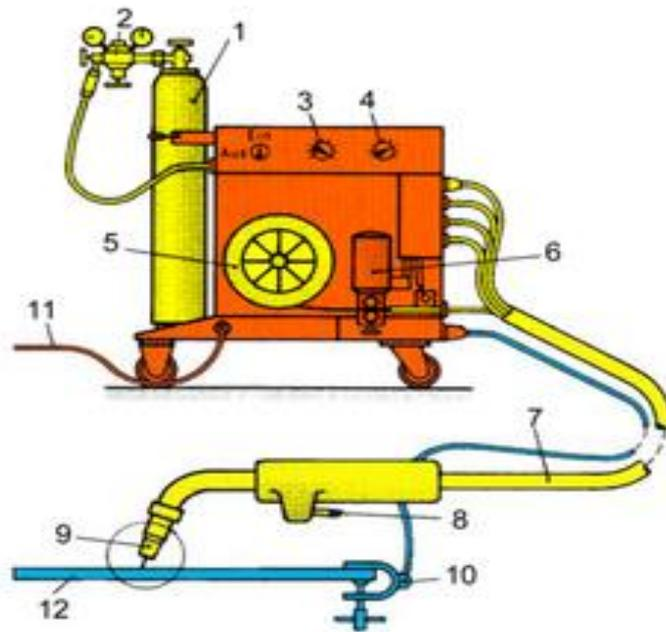
**Slika 17. Sustav za MIG postupak zavarivanja [47]**
