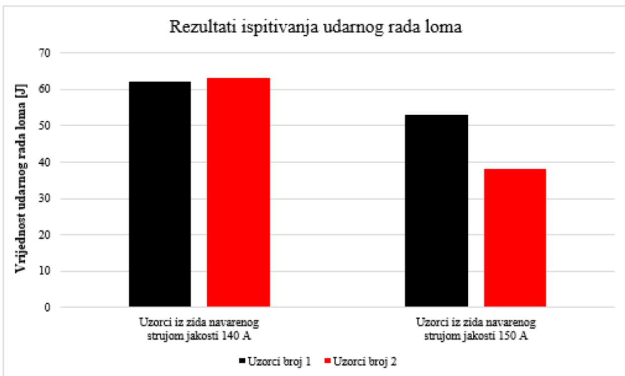
**Slika 61. Graf usporedbe rezultata ispitivanja udarnog rada loma**
