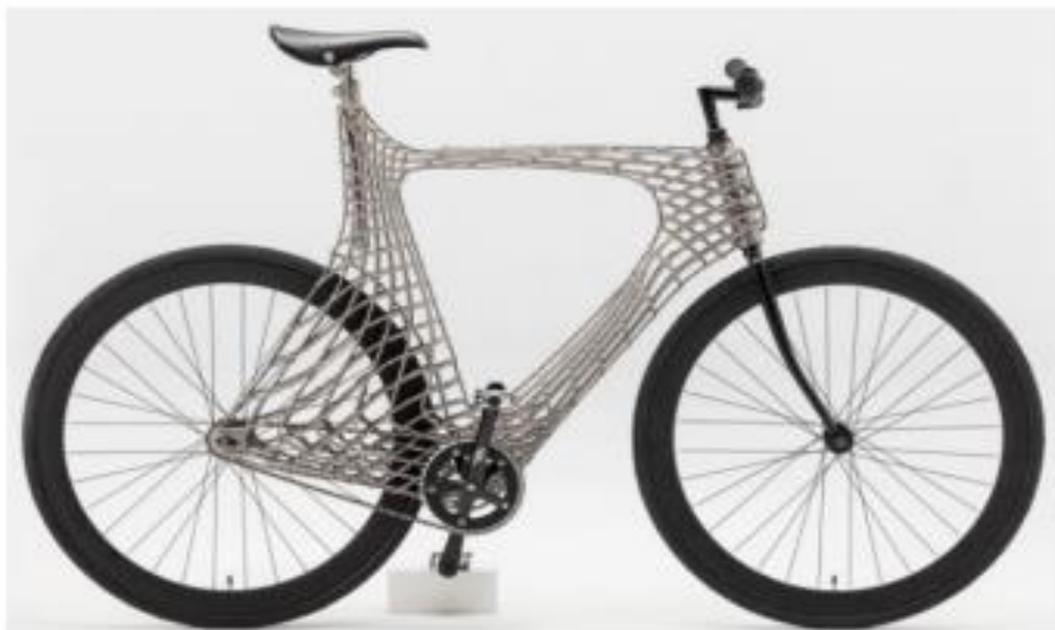
Slika 9. Arc Bike I od nehrđajućeg čelika [30]
