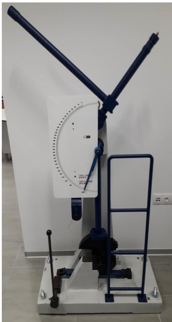
Slika 25. Charpyjev bat Pendulum impact charpy tester
