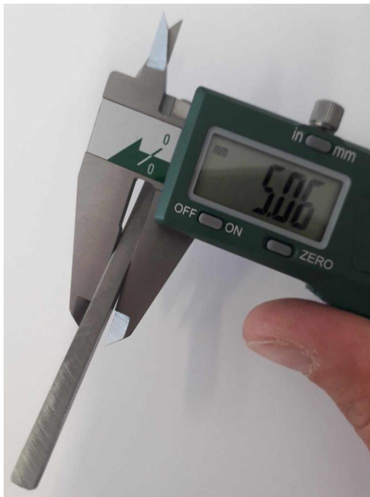
**Slika 55. Dimenzije poprečnog presjeka ispitnog uzorka**
