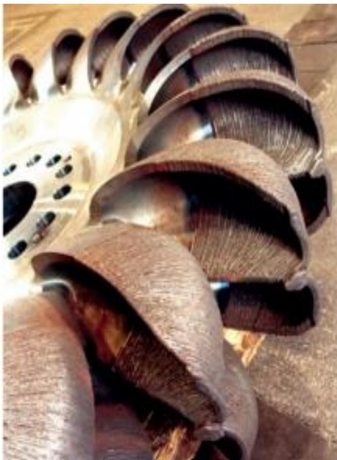
**Slika 15. Lopatice vodene turbine izrađene WAAM postupkom [36]**
