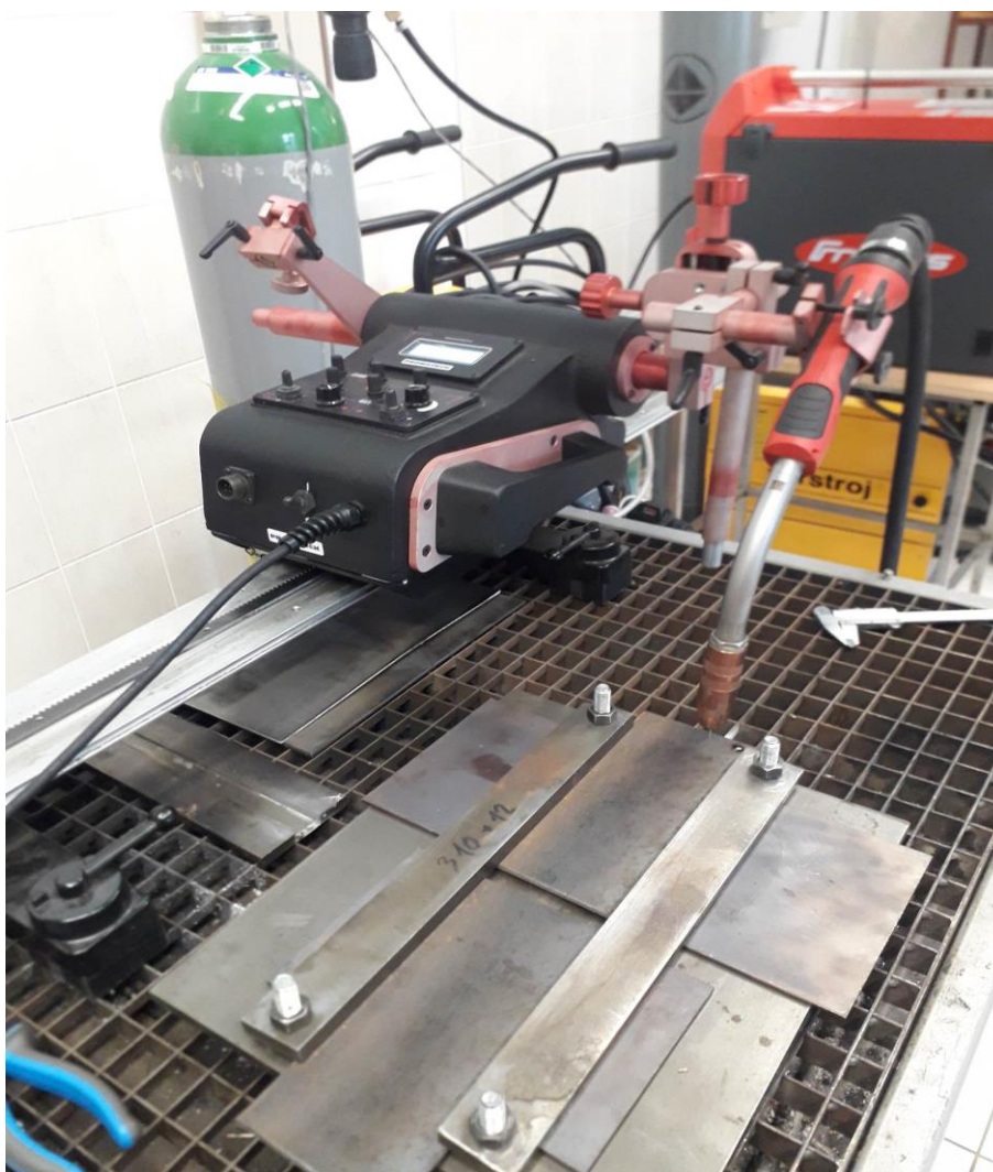
Slika 19. Radni prostor navarivanja s dijelom korištenih uređaja i materijala
