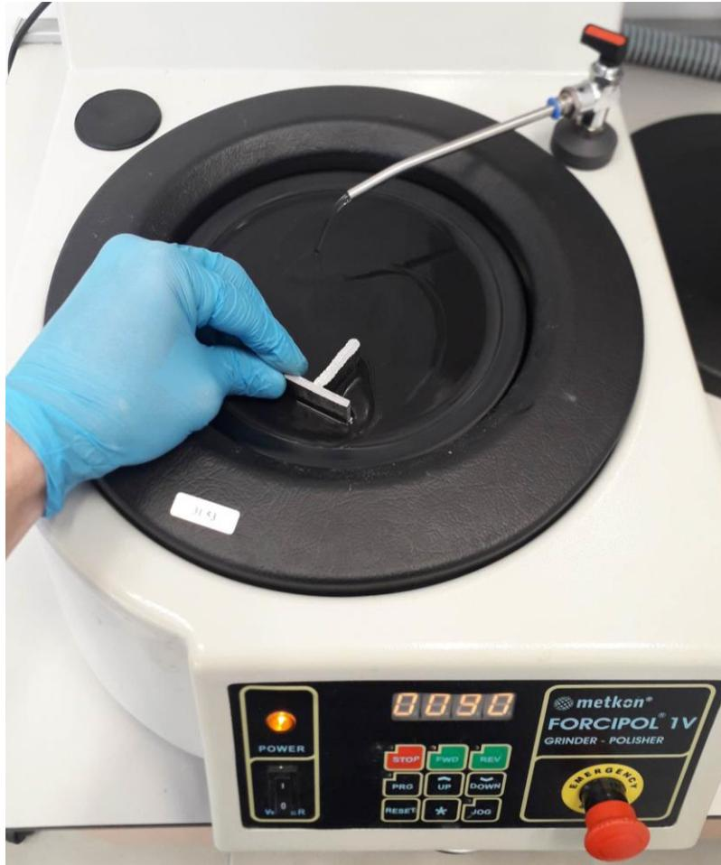
**Slika 46. Proces poravnavanja površine uzoraka za ispitivanje**
