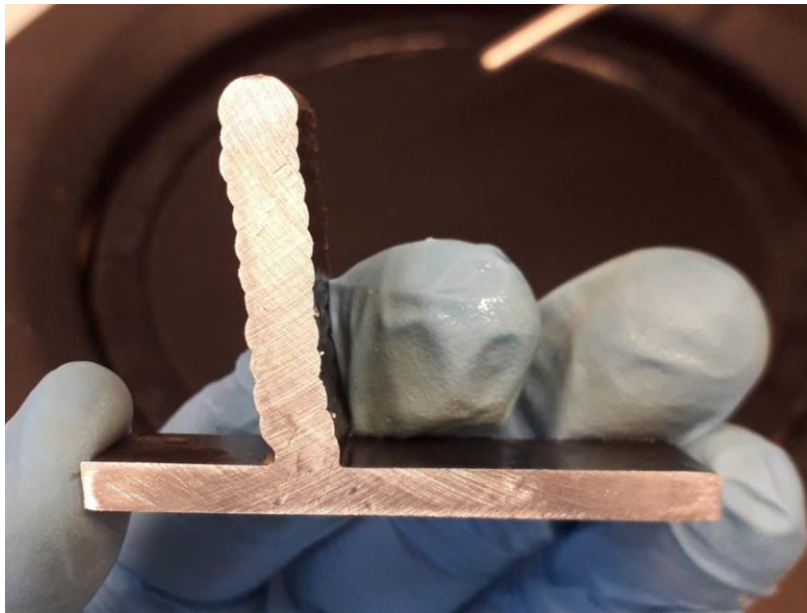
Slika 44. Ispitni uzorak za analizu makrostrukture tijekom faze grubog brušenja
