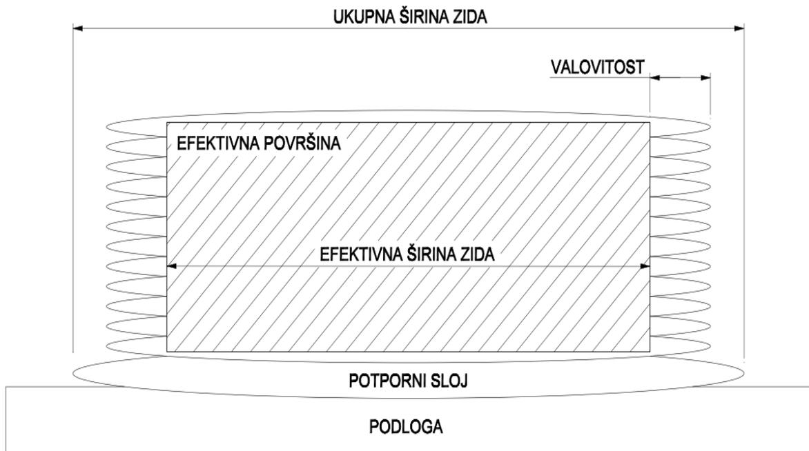
**Slika 7. Presjek zida dobivenog WAAM tehnologijom proizvodnje [21]**
