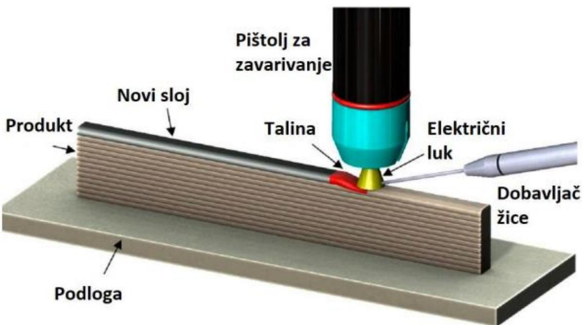
Slika 6. WAAM postupak proizvodnje metalnog zida [7]
