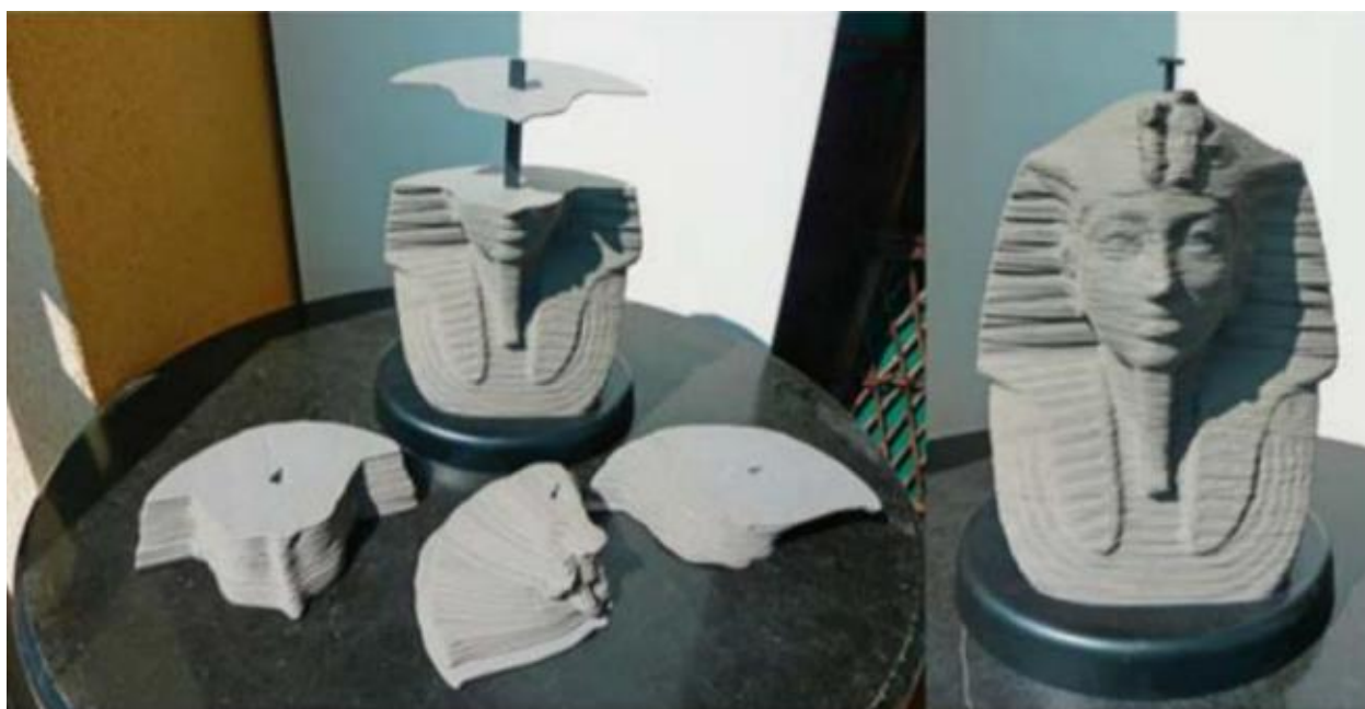
Slika 1. Faze nastanka elementa primjenom procesa aditivne proizvodnje [7]
