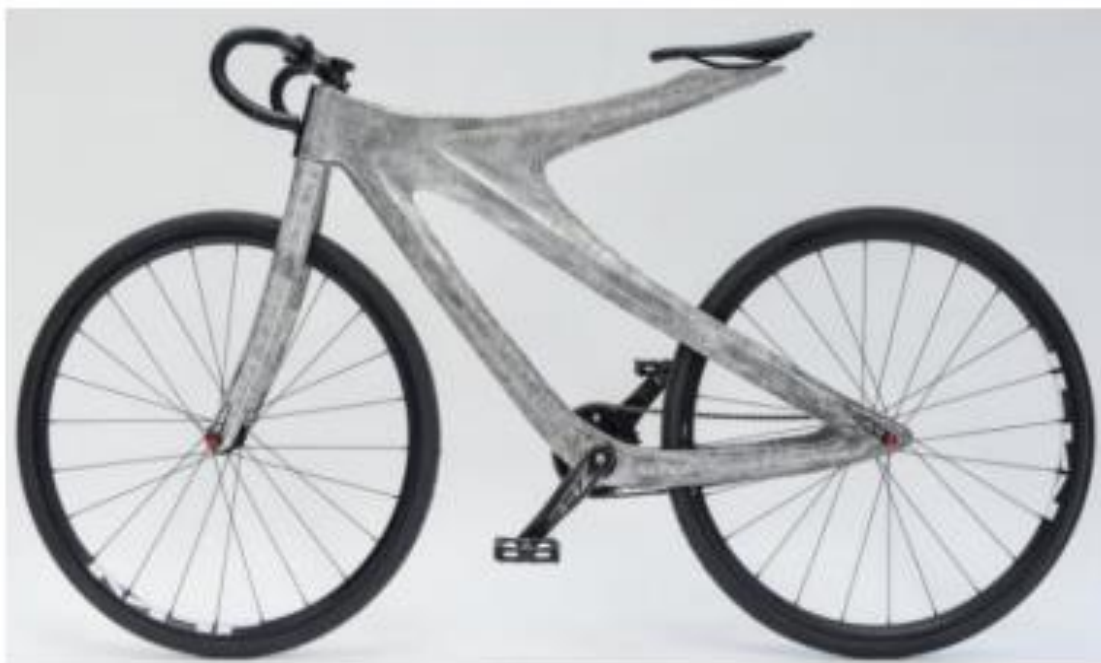
Slika 8. Arc Bike II od aluminija [30]
