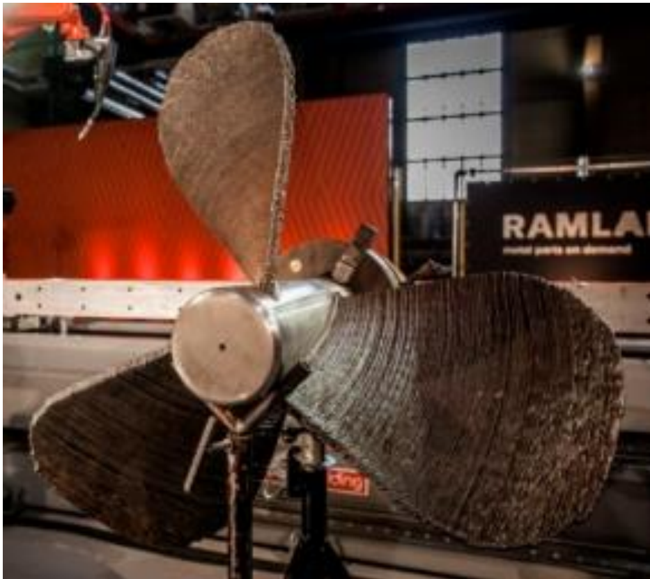
Slika 14. Propeler s tri lopatice izrađen WAAM postupkom [36]
