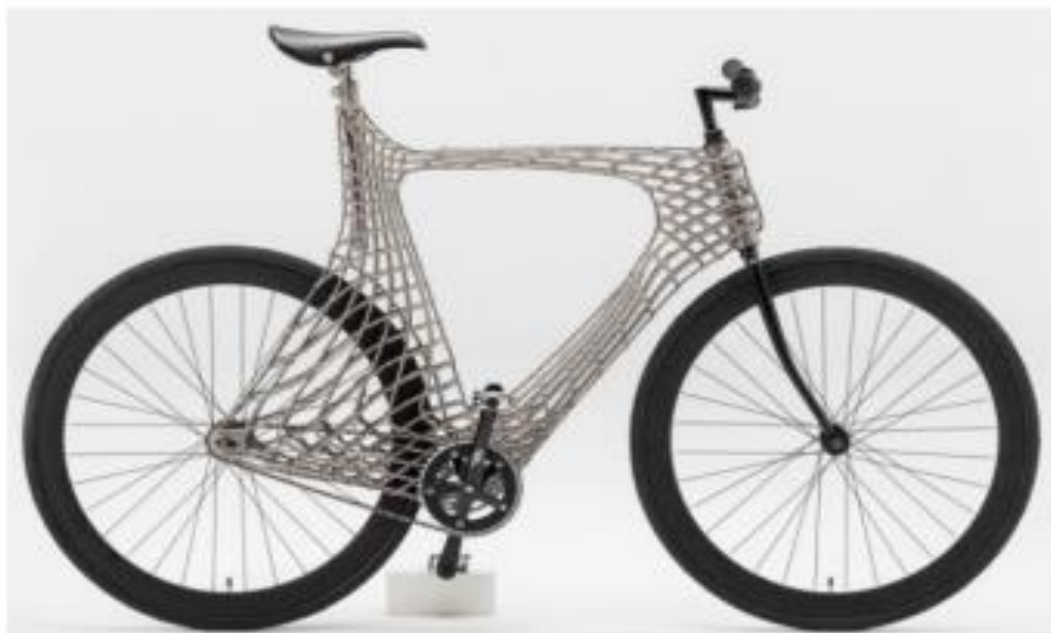
Slika 9. Arc Bike I od nehrđajućeg čelika [30]
