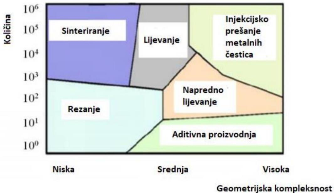
**Slika 5. Karakteristike proizvodnje metalnih komponenti [4, 15]**
