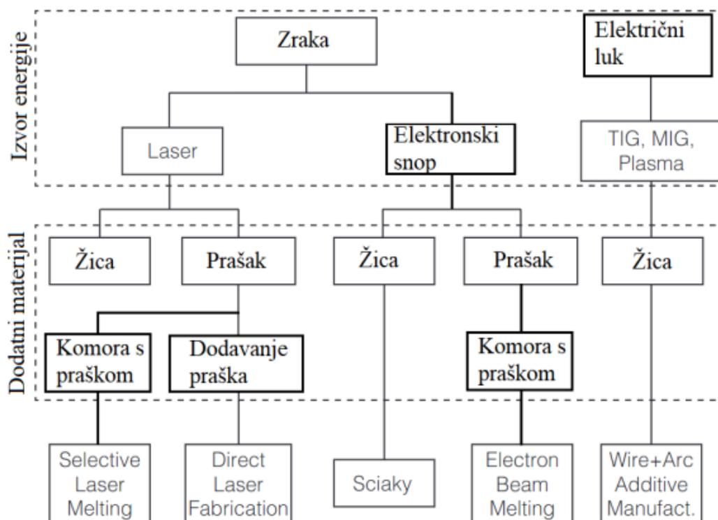
Slika 4. Podjela postupaka aditivne proizvodnje primjenom metala [16]
