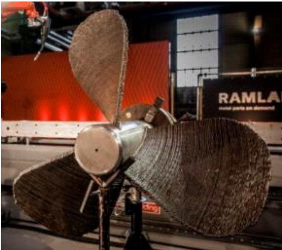
**Slika 14. Propeler s tri lopatice izrađen WAAM postupkom [36]**
