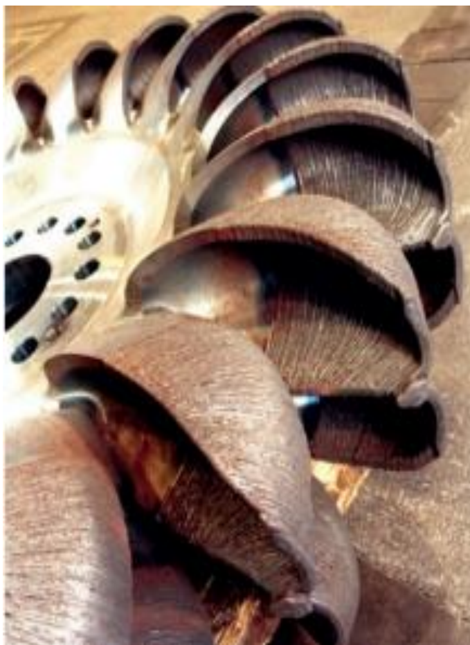
Slika 15. Lopatice vodene turbine izrađene WAAM postupkom [36]
