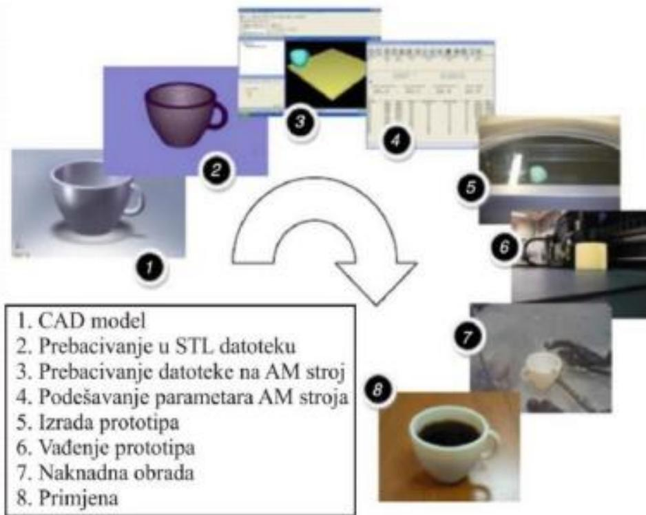
**Slika 3. Faze izrade elementa procesom aditivne proizvodnje [6, 7]**
