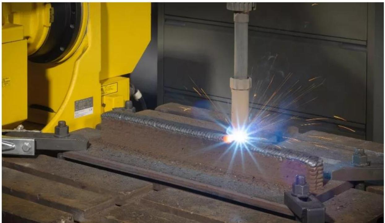
**Slika 2. Proces aditivne proizvodnje metalne komponente [10]**
