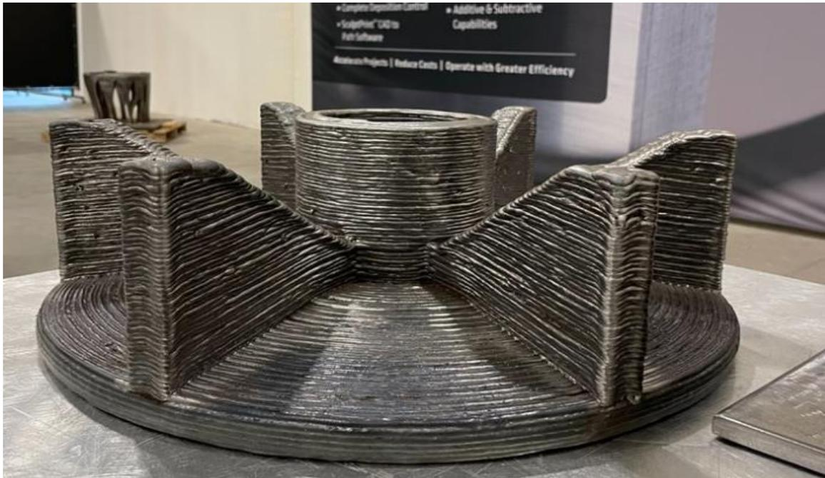
**Slika 11. Zamjenska komponenta stroja izrađena WAAM postupkom [34]**
