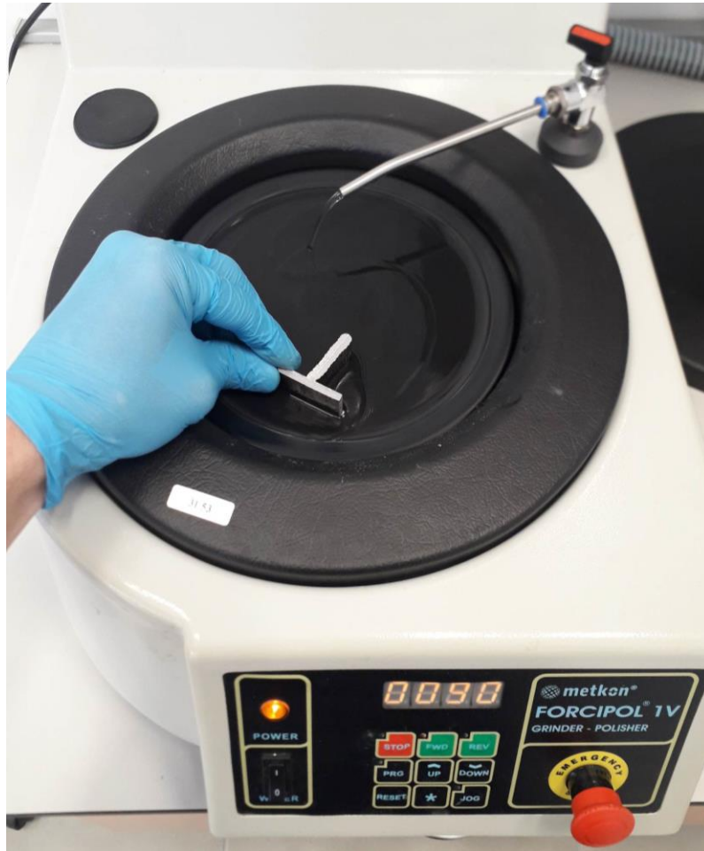
Slika 46. Proces poravnavanja površine uzoraka za ispitivanje
