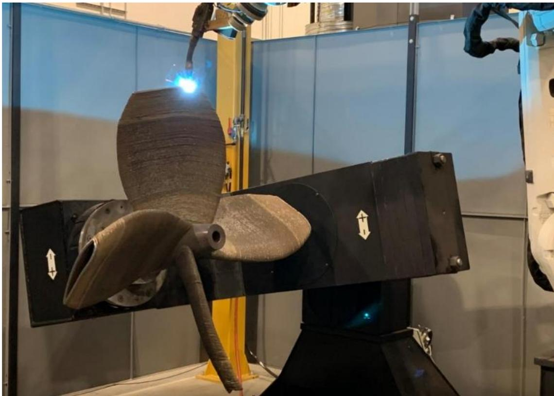
**Slika 12. WAAM postupak izrade propelera sa šupljim lopaticama [10]**
