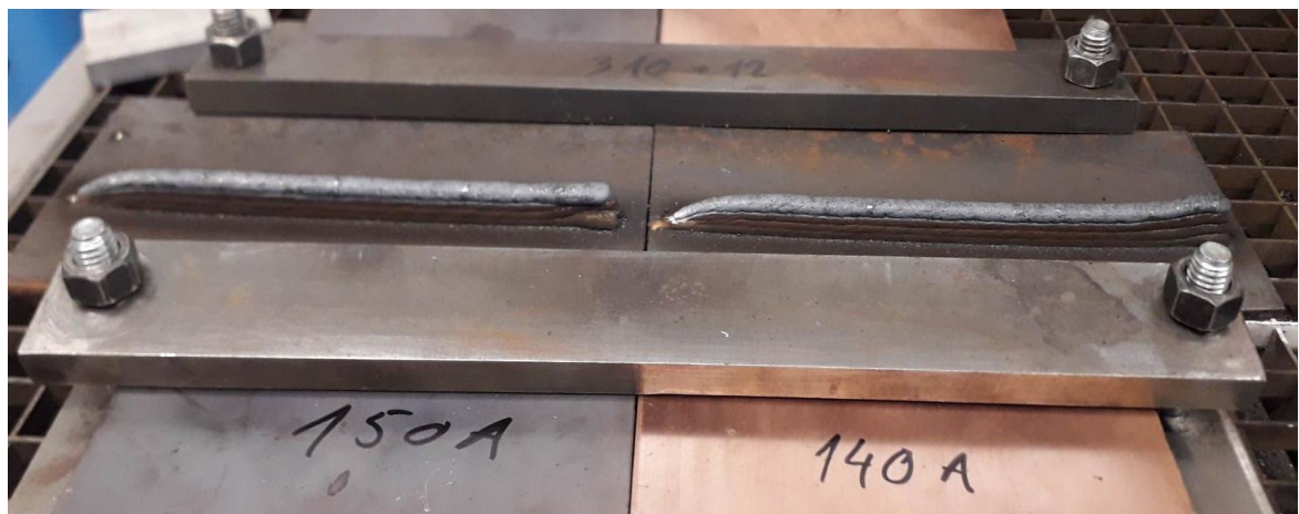
Slika 35. Uzorci zidova s četiri navarena sloja
