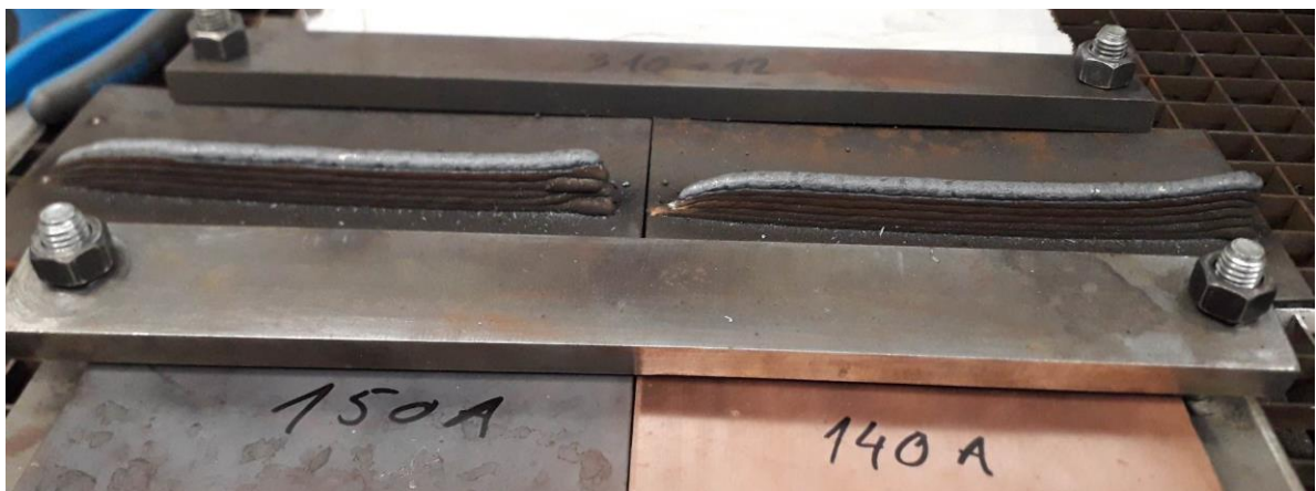
Slika 36. Uzorci zidova sa šest navarenih slojeva
