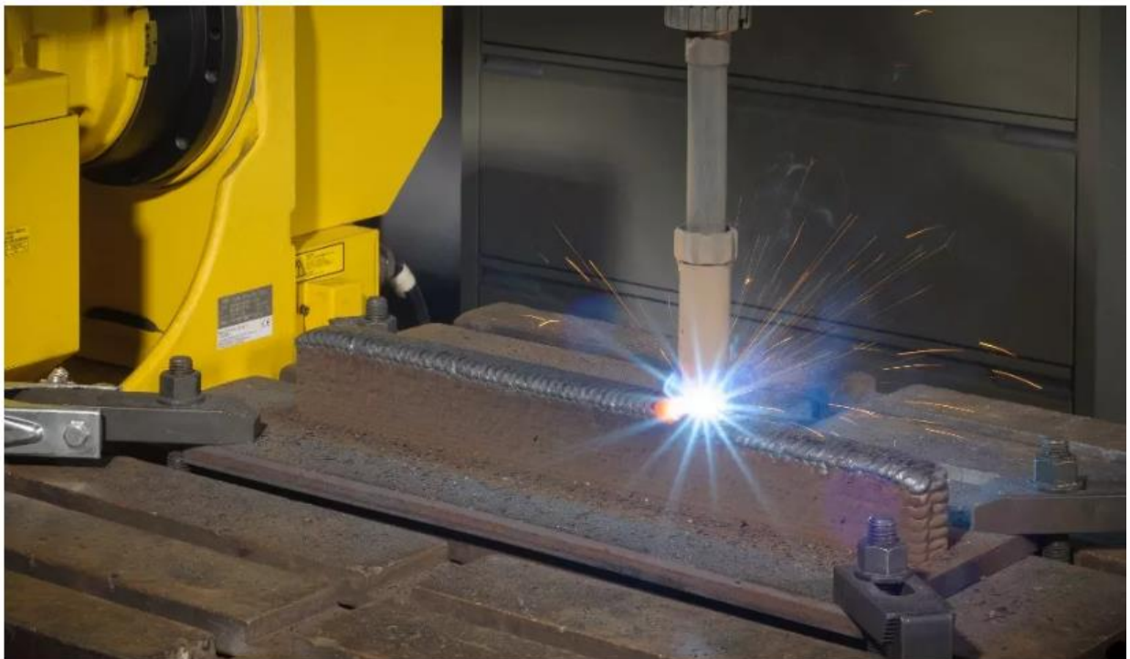
Slika 2. Proces aditivne proizvodnje metalne komponente [10]
