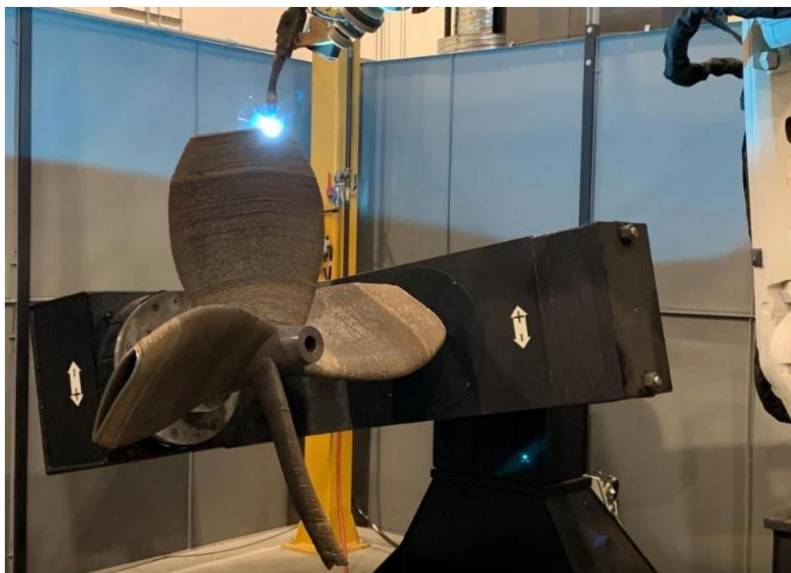
Slika 12. WAAM postupak izrade propelera sa šupljim lopaticama [10]
