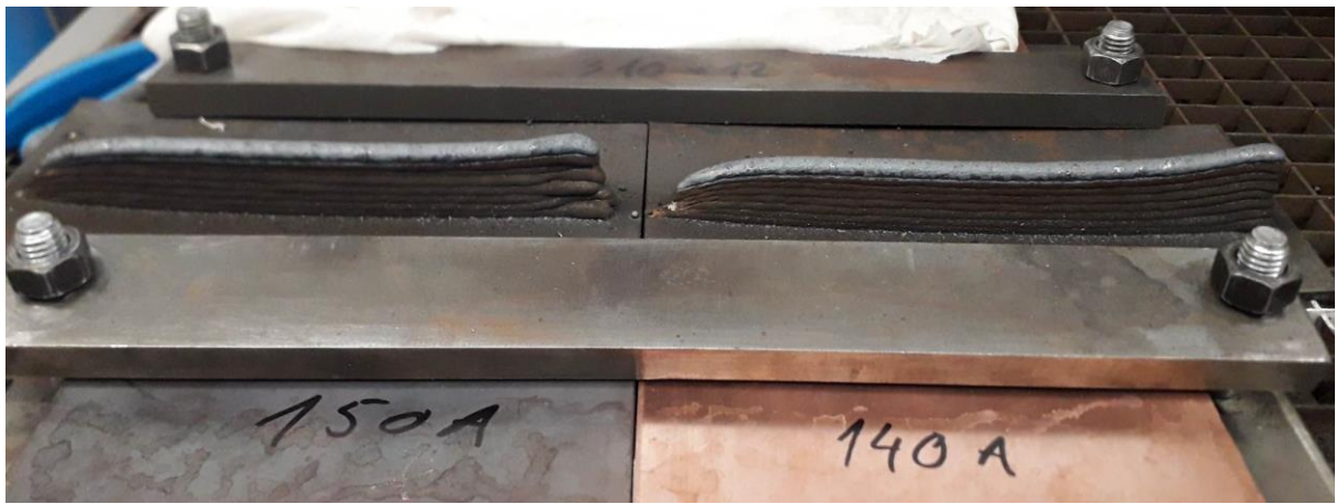
Slika 37. Uzorci zidova s osam navarenih slojeva
