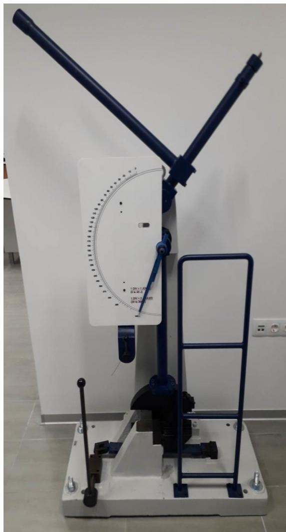
**Slika 25. Charpyjev bat *Pendulum impact charpy tester***
