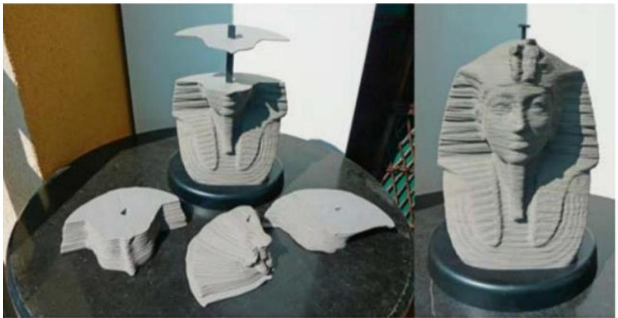
Slika 1. Faze nastanka elementa primjenom procesa aditivne proizvodnje [7]
