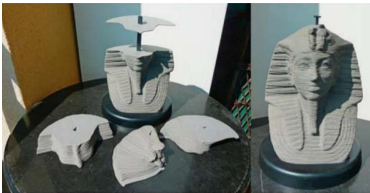
Slika 1. Faze nastanka elementa primjenom procesa aditivne proizvodnje [7]
