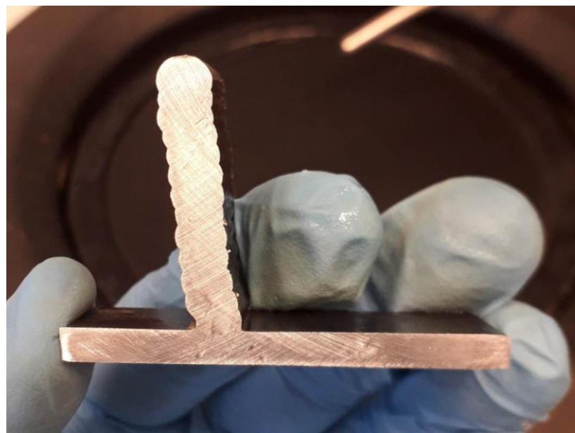
Slika 44. Ispitni uzorak za analizu makrostrukture tijekom faze grubog brušenja
