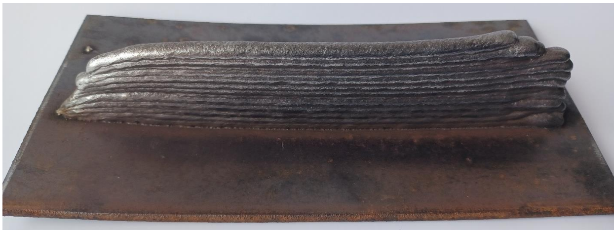
Slika 41. Ohlađen uzorak zida navaren strujom jakosti 150 A
