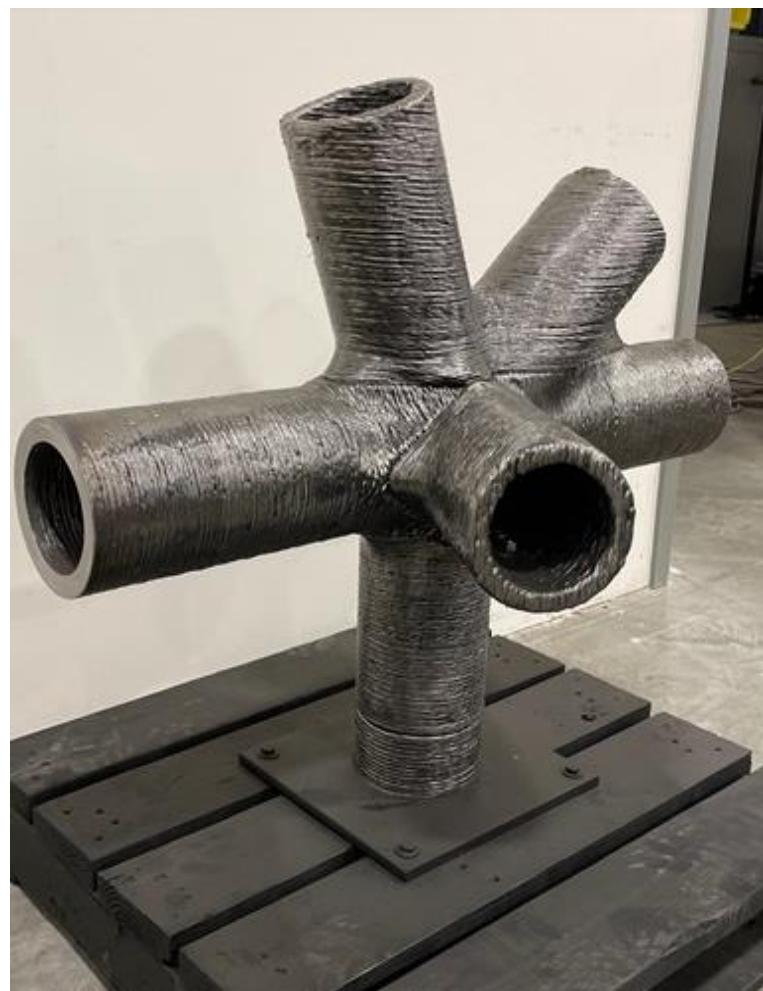
**Slika 10. Spojni element za naftne platforme izrađen WAAM postupkom [34]**
