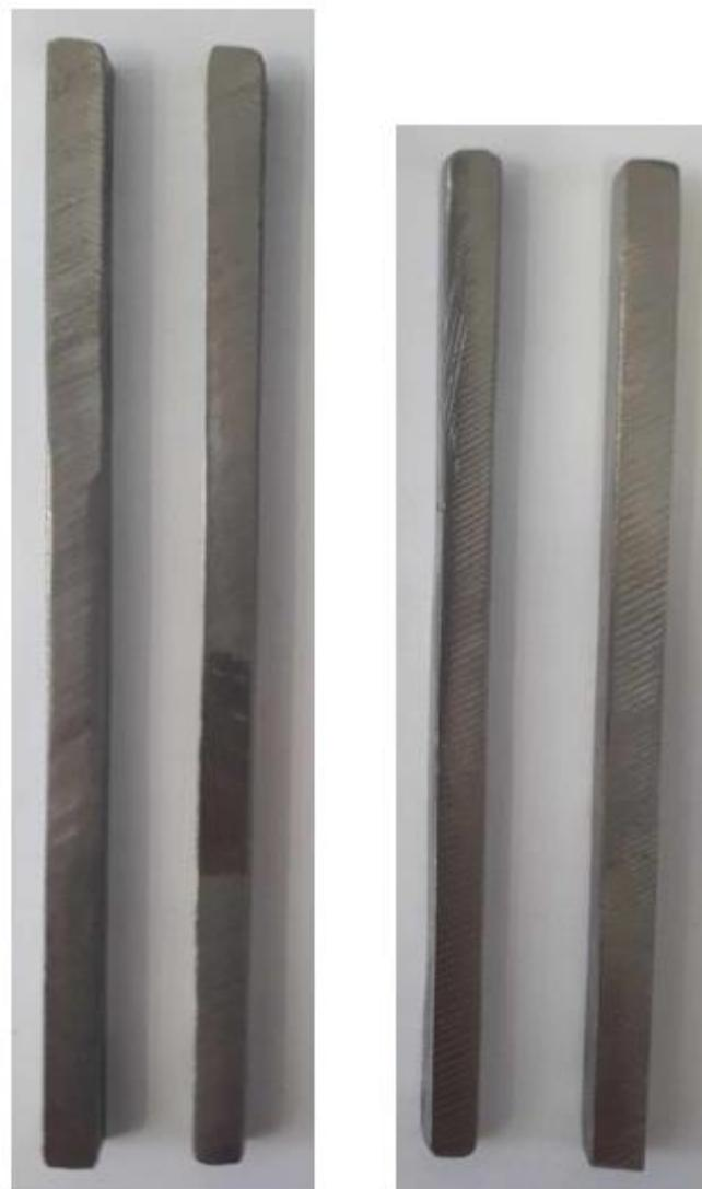
Slika 45. Uzorci za ispitivanje udarnog rada loma izrezani iz zida navarenog strujom jakosti 140 A (lijevo) i zida navarenog strujom jakosti 150 A (desno)
