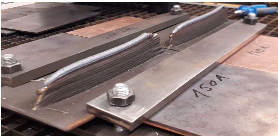
Slika 39. Uzorci zidova s 13 navarenih slojeva
