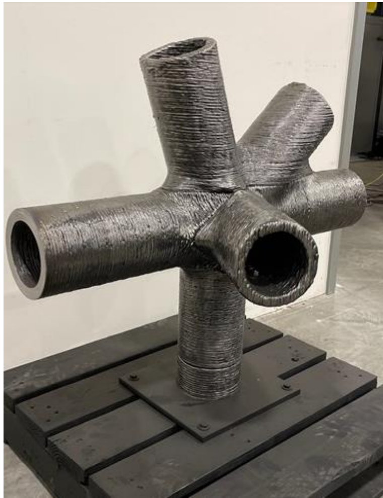
Slika 10. Spojni element za naftne platforme izraden WAAM postupkom [34]
