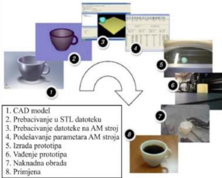
**Slika 3. Faze izrade elementa procesom aditivne proizvodnje [6, 7]**
