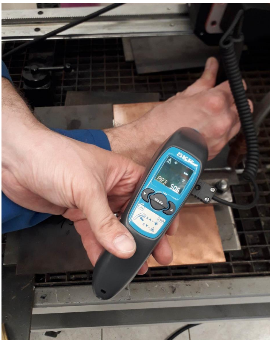
Slika 40. Mjerenje međuprolazne temperature pojedinih prolaza
