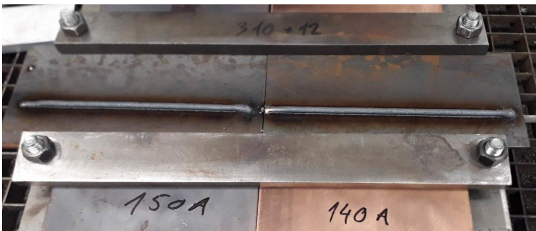
Slika 32. Prvi prolazi uzoraka s metalnim oksidima na površini
