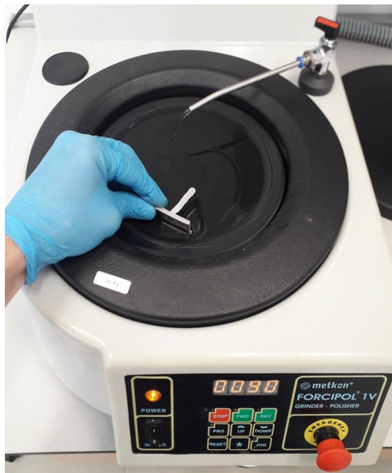
**Slika 46. Proces poravnavanja površine uzorka za ispitivanje**
