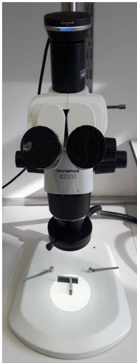
**Slika 50. Proces analize makrostrukture ispitog uzorka**
