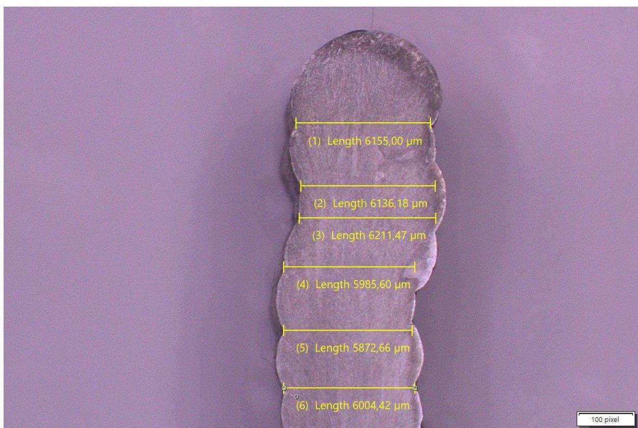
**Slika 53. Makrostruktura gornjeg dijela poprečnog presjeka ispitnog uzorka navarenog strujom jakosti 150 A**
