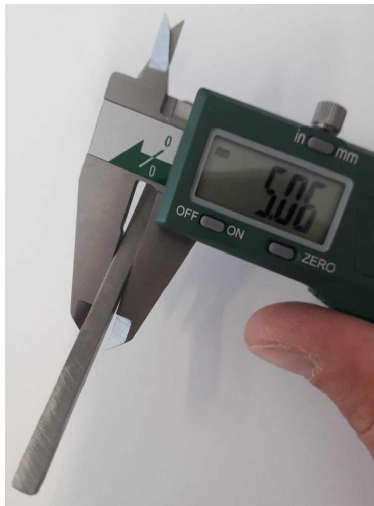
Slika 55. Dimenzije poprečnog presjeka ispitnog uzorka
