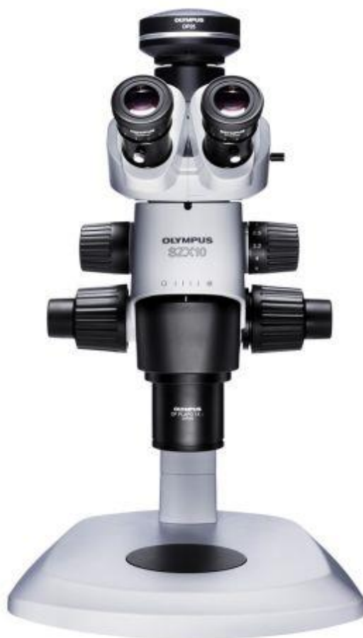
Slika 24. Stereomikroskop Olympus SZX10 [53]
