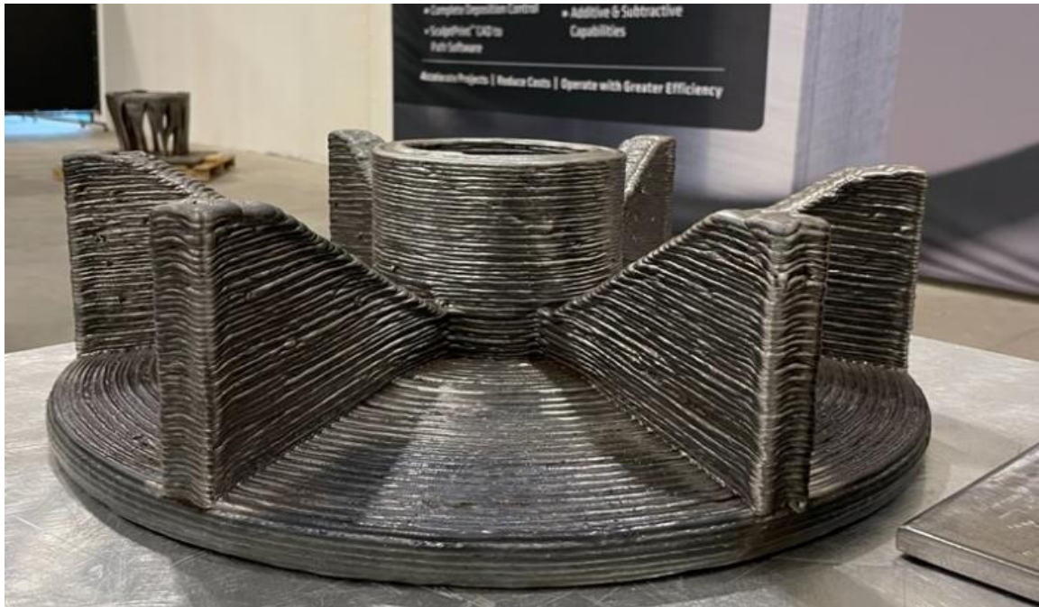
Slika 11. Zamjenska komponenta stroja izrađena WAAM postupkom [34]
