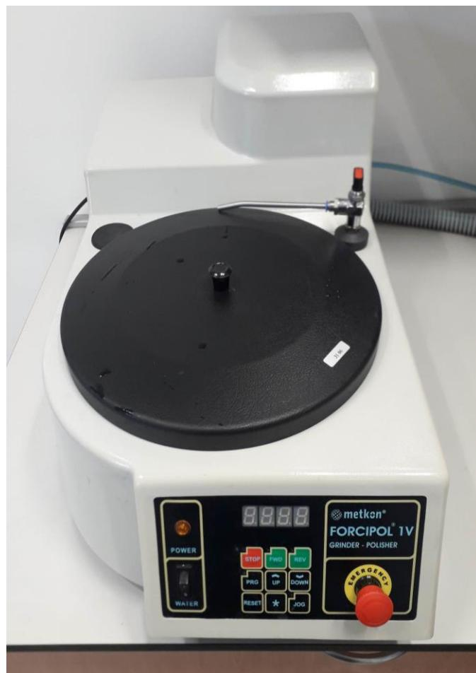
**Slika 23. Uređaj za brušenje i poliranje *Metkon Forcipol IV Grinder & Polisher***
