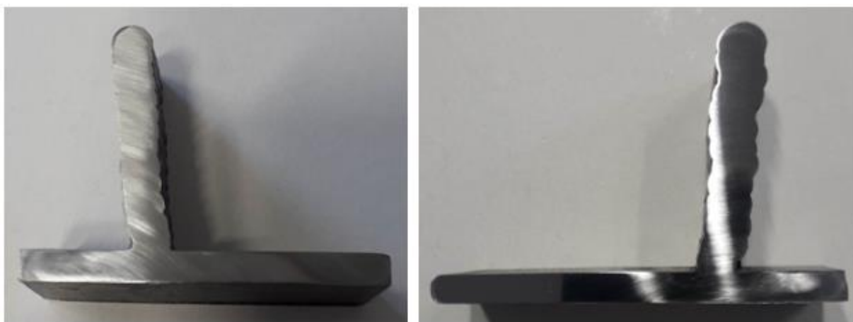
Slika 47. Obradena površina ispitnog uzorka navarenog strujom jakosti 140 A (lijevo) i strujom jakosti 150 A (desno)
