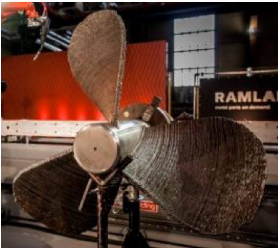
Slika 14. Propeler s tri lopatice izrađen WAAM postupkom [36]
