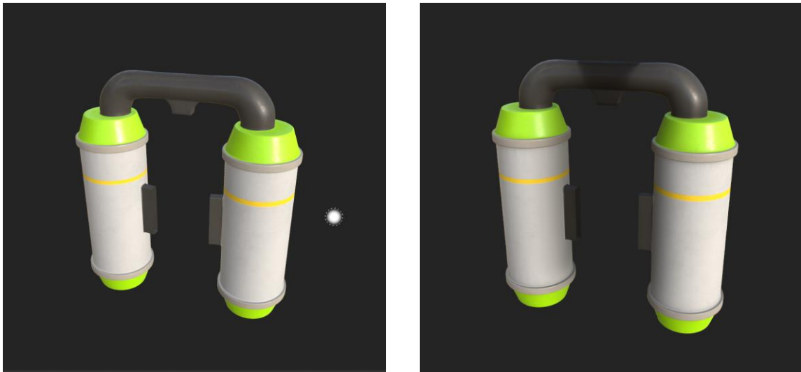
Slika 6-3: Prikaz model bez AO mape; prikaz modela s AO mapom
