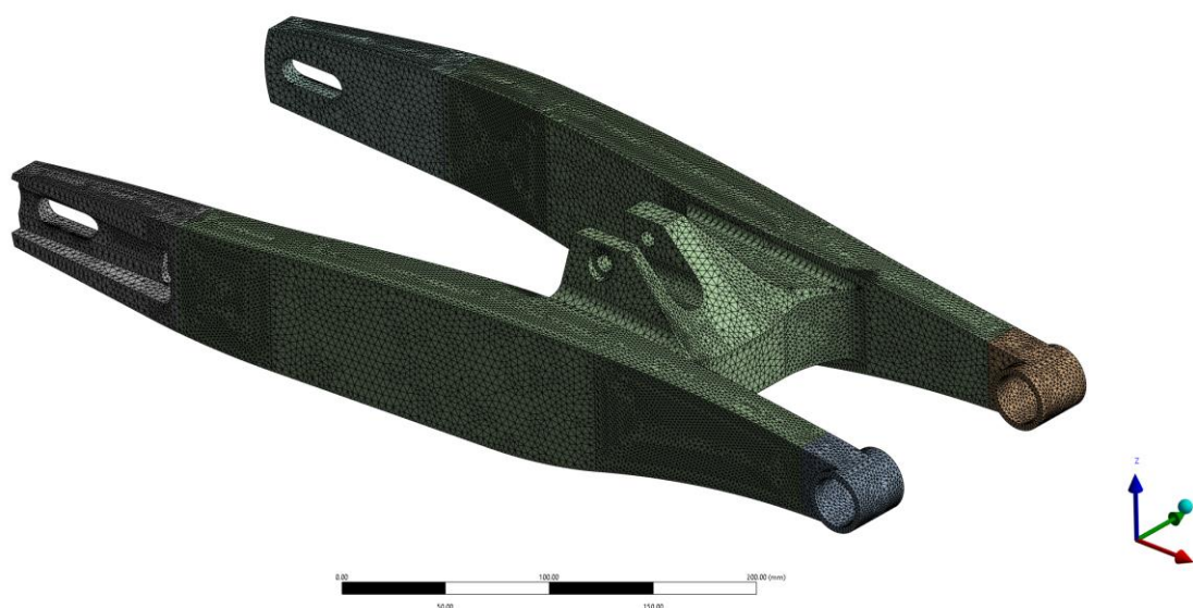
Slika 5.7 Izgled mreže modela stražnje vilice za analizu
