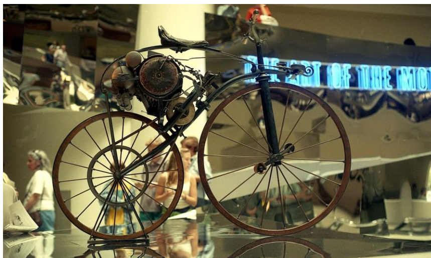
Slika 1.1 Prvi motocikl na parni pogon [3]
