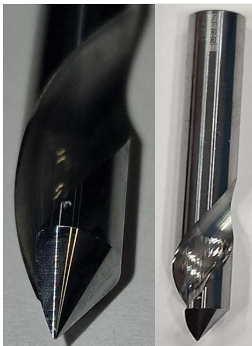
Slika 19 Glodalo za graviranje SECO 29060 [7]
