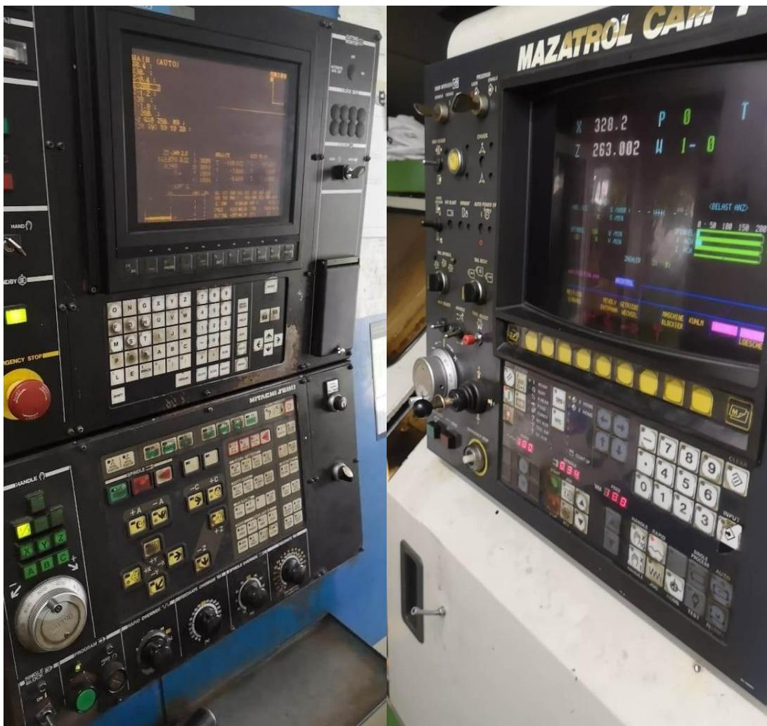
Slika 3 Upravljačke jedinice CNC strojeva [7]
