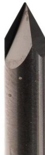
Slika 6 Alati za graviranje pomoću CNC strojeva [19]
