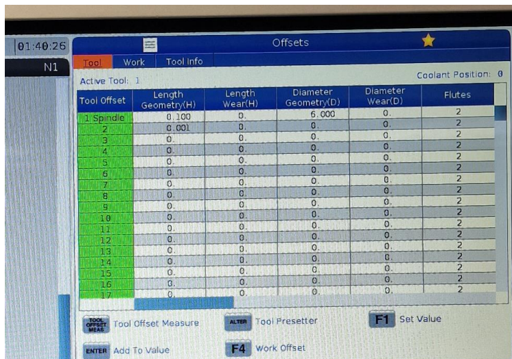
Slika 23 Prozor Offsets za upisivanje potrebnih odstupanja alata i nul-točke [7]
