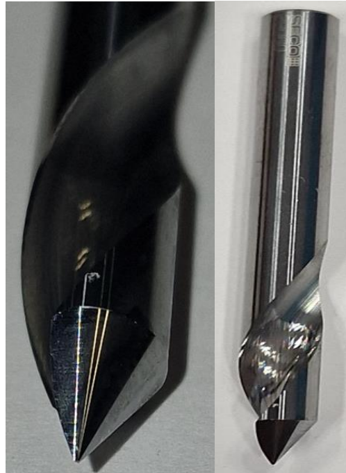
Slika 19 Glodalo za graviranje SECO 29060 [7]
