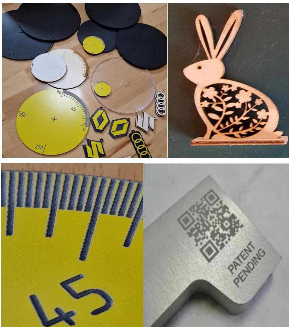
Slika 8 Primjeri izradaka izrađenih laserskim graviranjem [7, 25]
