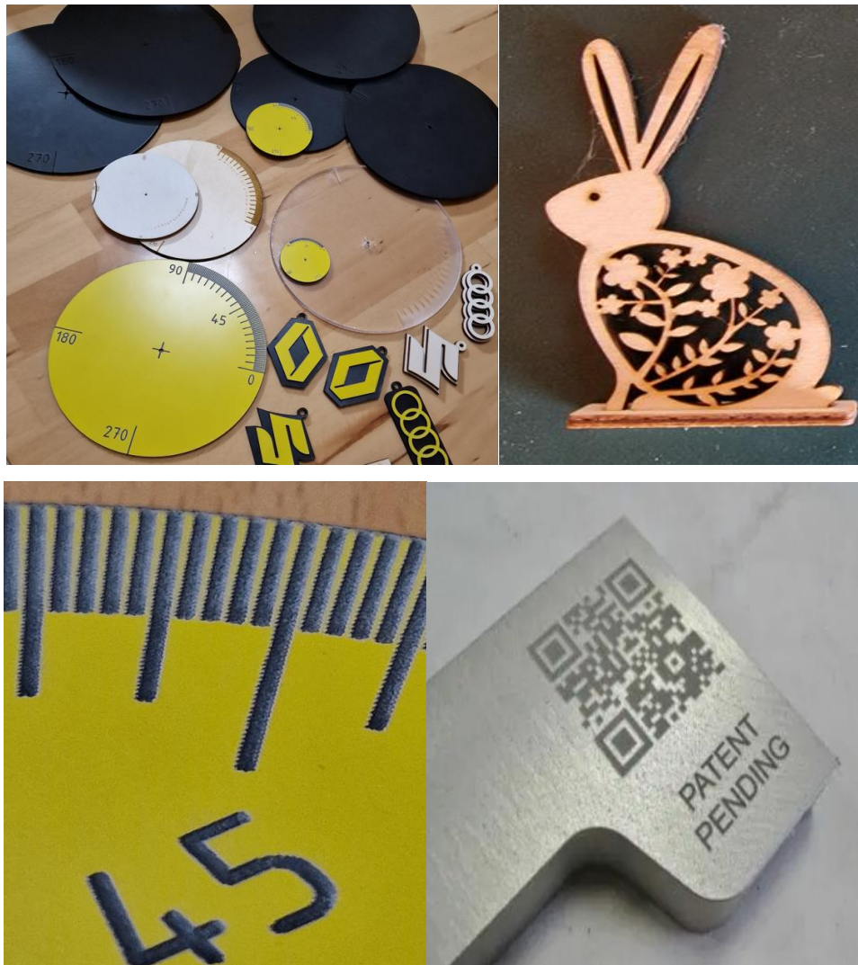
Slika 8 Primjeri izradaka izrađenih laserskim graviranjem [7, 25]
