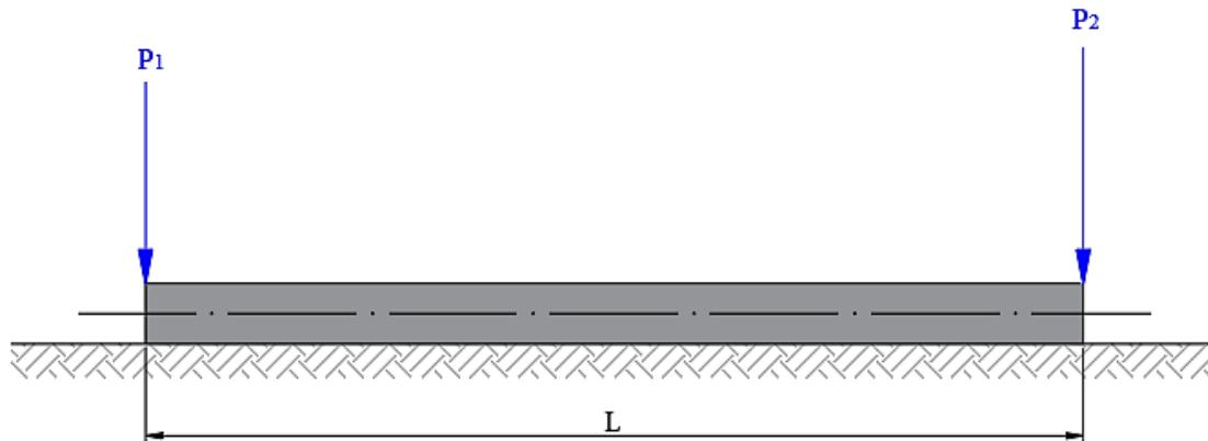
**Slika 5.8.** Shematski prikaz nosača opterećenog djelovanjem koncentriranim silama
