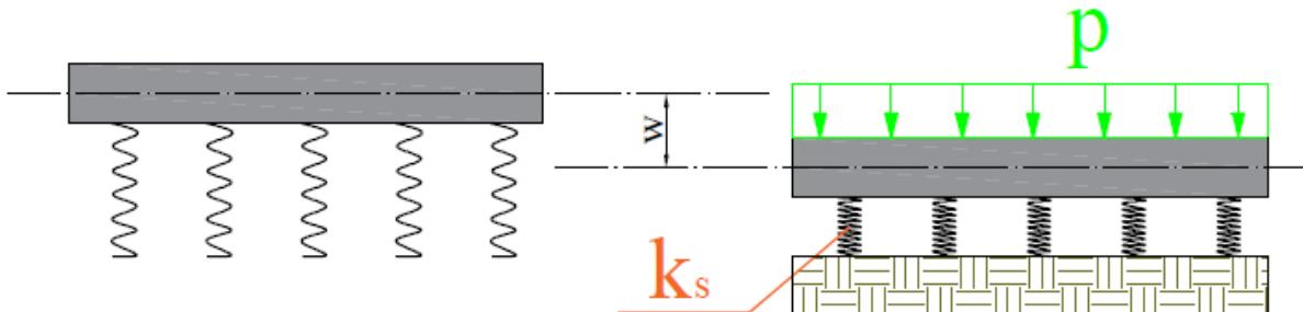
Slika 4.2. Jednoparametarski model tla
