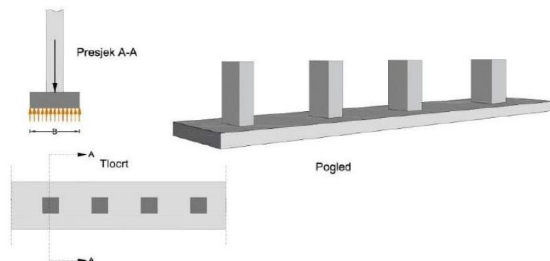
b) temeljni nosač ispod pojedinačnih stupova
