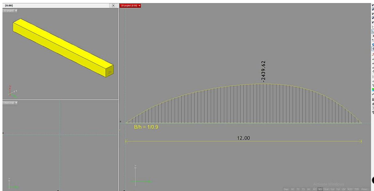
Slika 6.10. Dijagram momenta savijanja iz programa Tower 8.4. Demo
