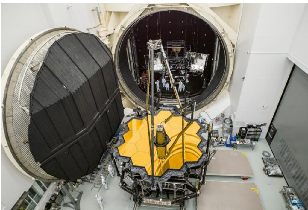
Slika 41 – Testiranje James Webb teleskopa u niskotemperaturnoj komori [42]
