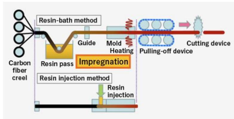
Slika 14 – Jedna od metoda impregniranja vlakana [28]
