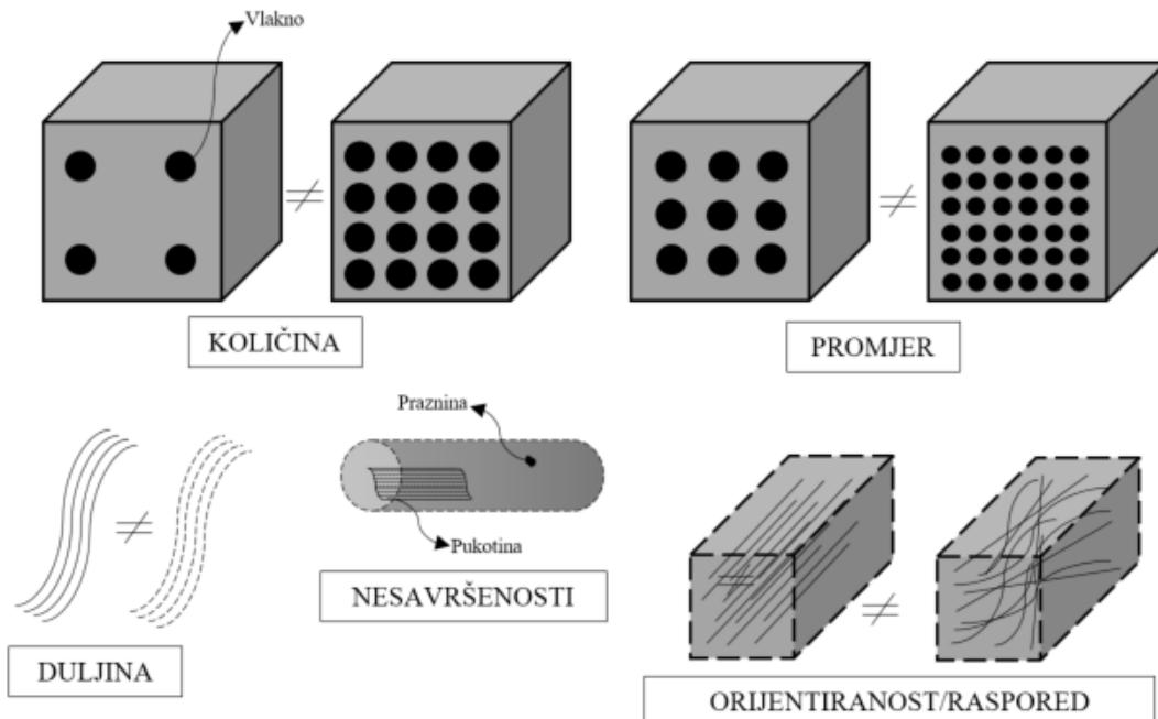
Slika 31 – Parametri vlakana koja utječu na mehanička svojstva kompozita
