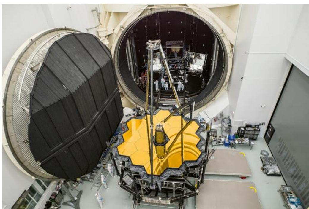
Slika 41 – Testiranje James Webb teleskopa u niskotemperaturnoj komori [42]
