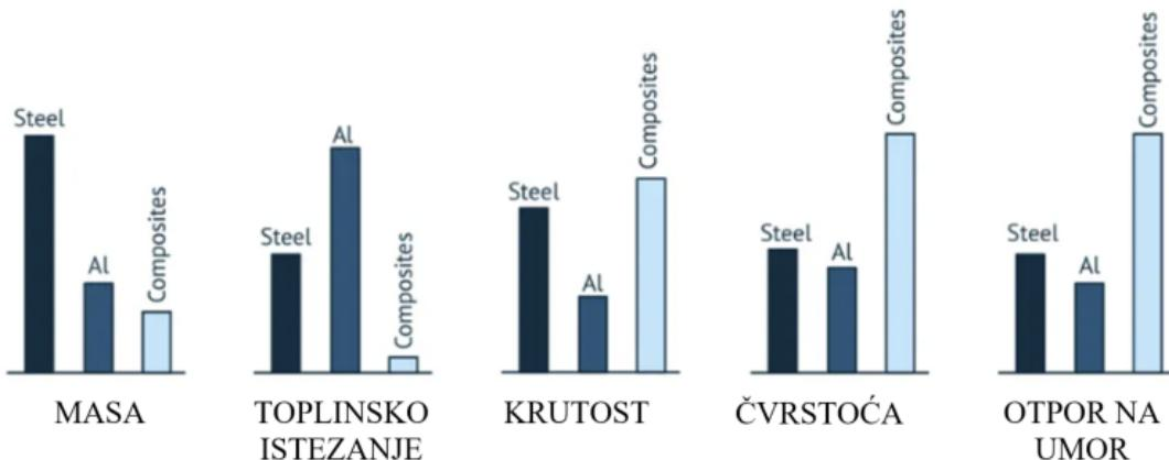
Slika 8 – Usporedbe određenih karakteristika čelika, aluminija i kompozita [9]
