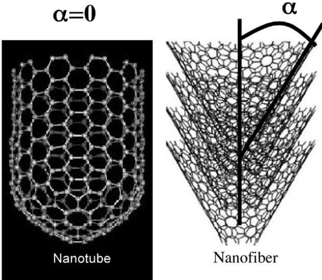
Slika 38 – Struktura ugljičnih nano-cijevi i nano-vlakana [38]
