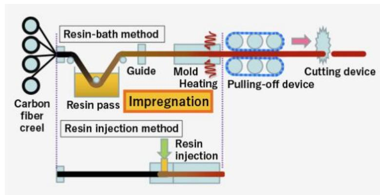
Slika 14 – Jedna od metoda impregniranja vlakana [28]
