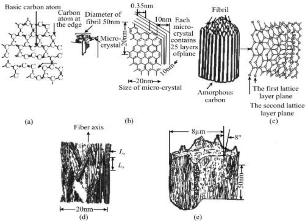
Slika 23 – Mikrostruktura ugljičnih vlakana i niti [8]
