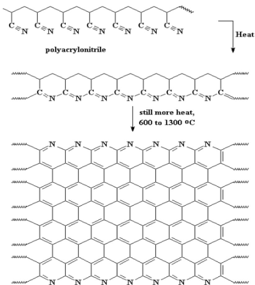
Slika 20 – Promjena kemijske strukture PAN vlakna pod utjecajem temperature [31]
