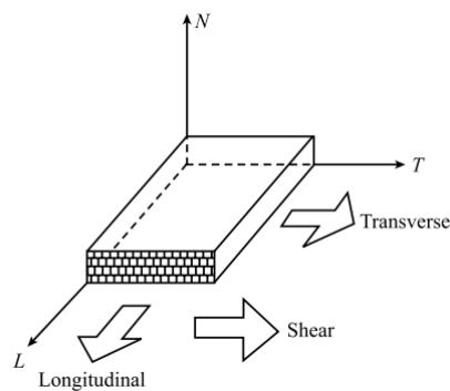
Slika 30 – Smjerovi naprezanja u kompozitnom materijalu [8]
