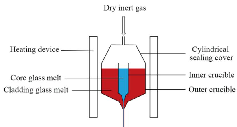
Slika 18 – Shema proizvodnje obloženih staklenih vlakana [13]
