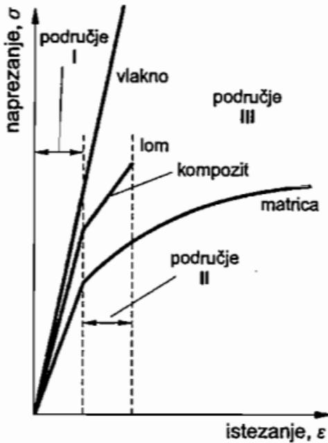
Slika 32 – Prikaz dijagrama “naprezanje-istezanje“ kompozita [46]
