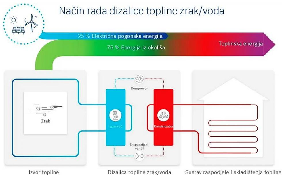
*Slika 8. Shematski prikaz rada dizalice topline zraka zrak-voda [16]*
