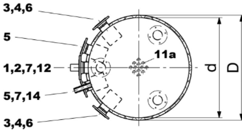
Slika 11. Tlocrt akumulacijskog spremnika [19]
