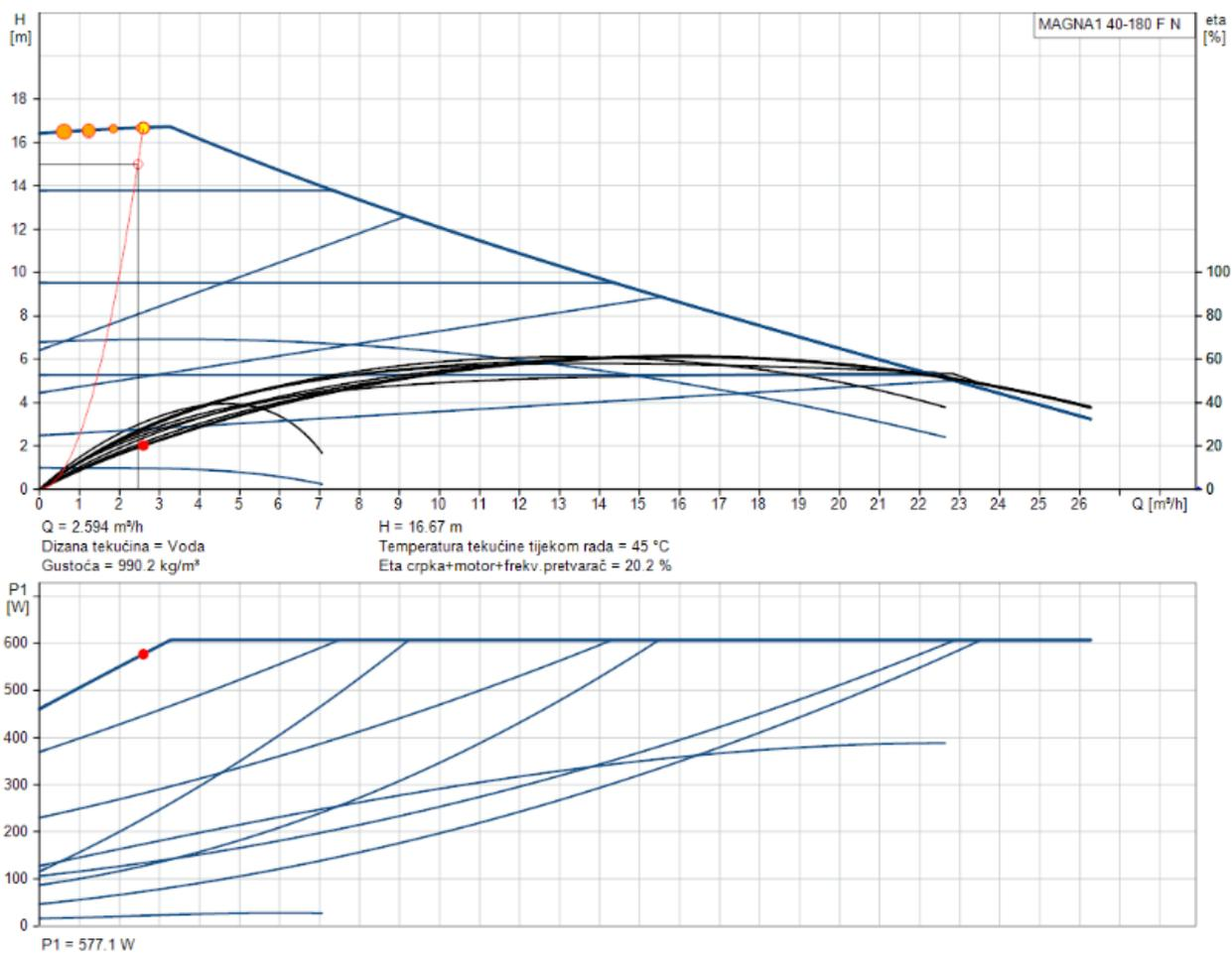
Slika 15. Karakteristika i radna točka pumpe magna1 40-180 FN [22]
