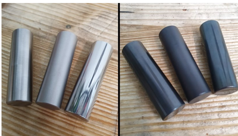
Slika 5.1. Primjer čeličnih komada prije bruniranja (lijevo) i nakon (desno) [20]
