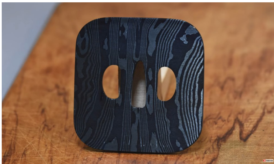
Slika 5.2. Prikaz predmeta plave prevlake dobivene bruniranjem u otopini soli [21]
