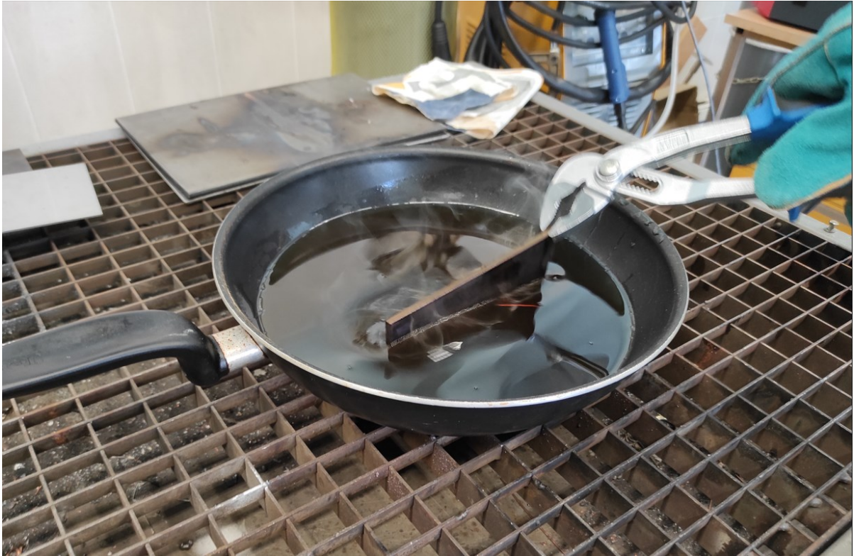
Slika 6.7. uranjanje zagrijane pločice u ulje
