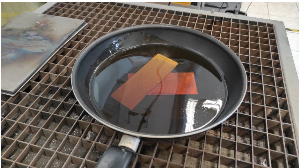
Slika 6.5. Hlađenje pločica u ulju
