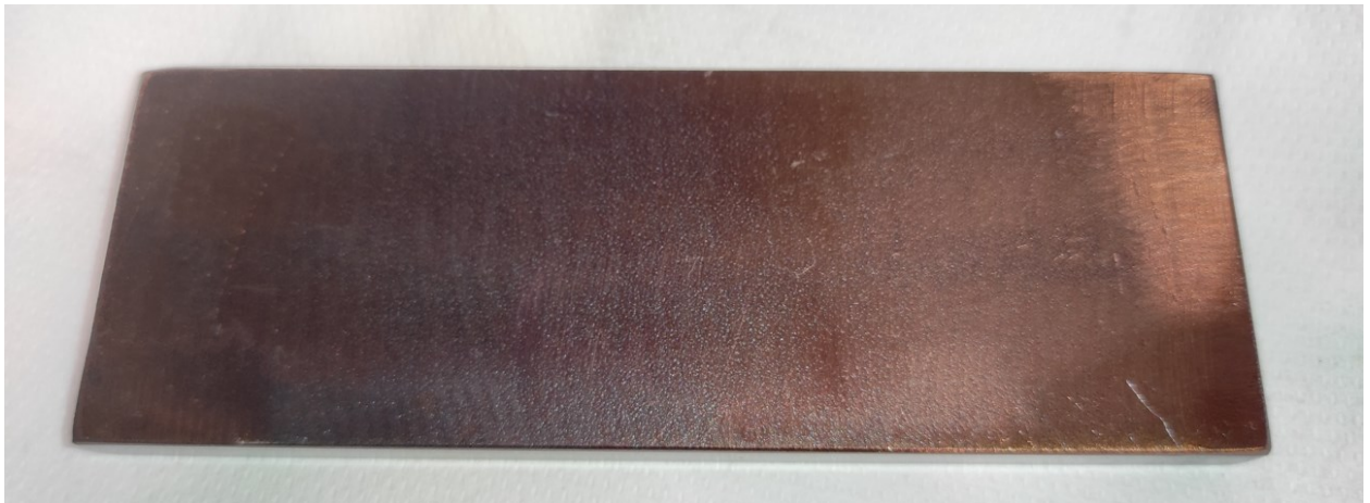
Slika 6.8. Prikaz brunirane pločice S235JR
