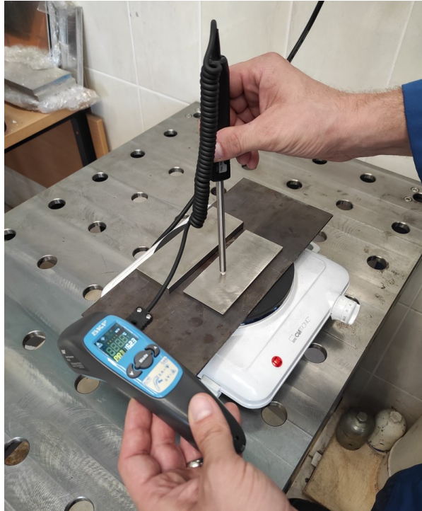
Slika 6.4. Mjerenje temperatura pločica prilikom njihovog zagrijavanja
