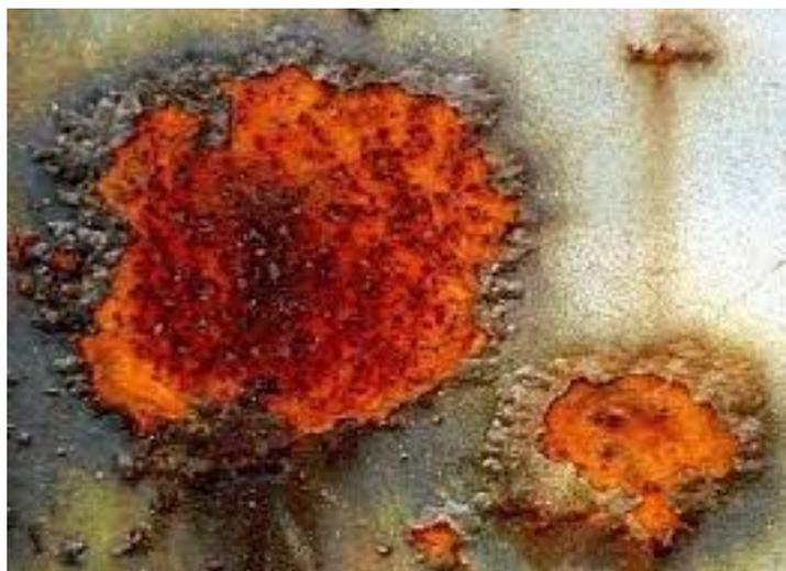
*Slika 2.9. Prikaz potpovršinske korozije [11]*
