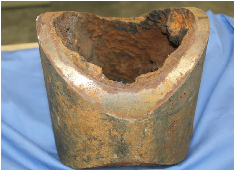
Slika 2.6. Primjer grafitizacije na cijevi od lijevanog željeza [8]
