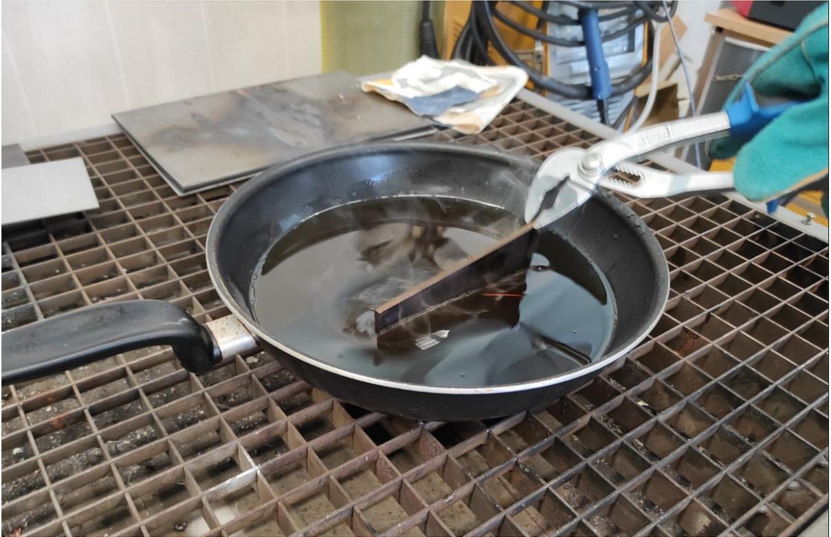
*Slika 6.7. uranjanje zagrijane pločice u ulje*
