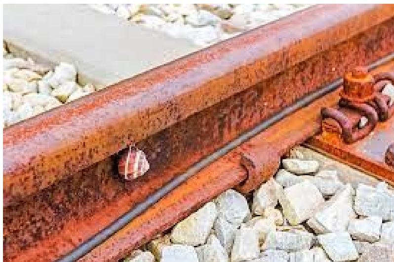
Slika 2.5. Prikaz opće korozije [7]
