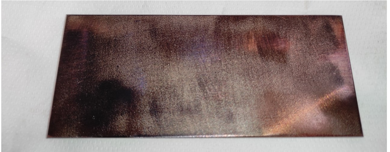
Slika 6.9. Prikaz brunirane pločice 25CrMo4
