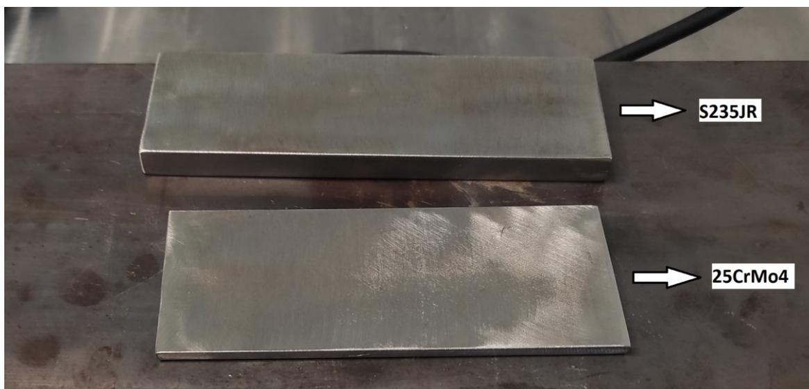
*Slika 6.1. Ispitni uzorci prije provođenja eksperimenta*
