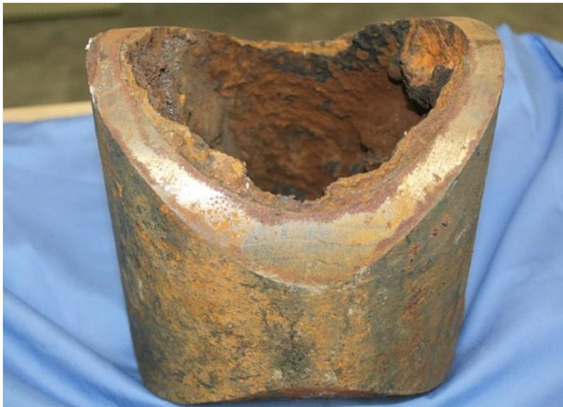
*Slika 2.6. Primjer grafitizacije na cijevi od lijevanog željeza [8]*
