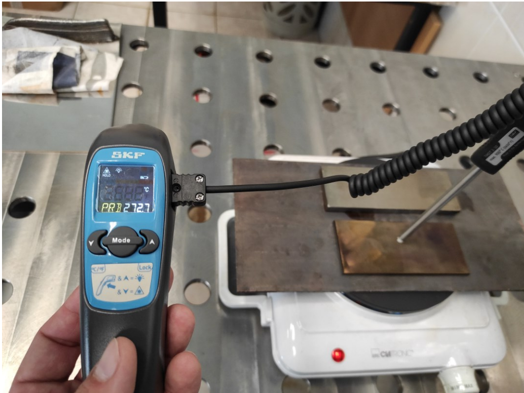
Slika 6.6. Zagrijavanje pločica na temepraturu od 300 °C
