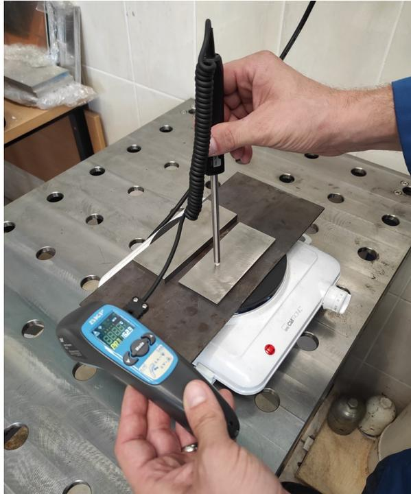
*Slika 6.4. Mjerenje temperatura pločica prilikom njihovog zagrijavanja*
