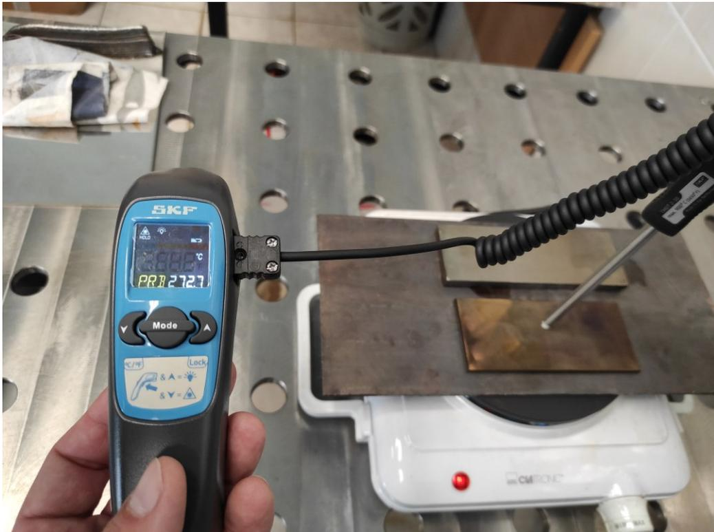
*Slika 6.6. Zagrijavanje pločica na temepraturu od 300 °C*
