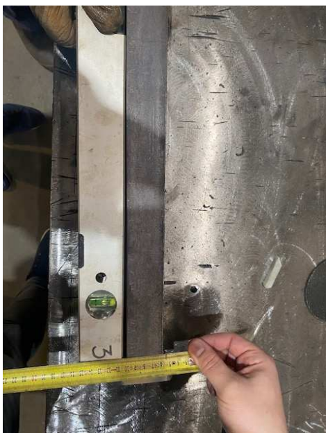
Slika 19. Mjerenje deformacije nakon zavarivanja
