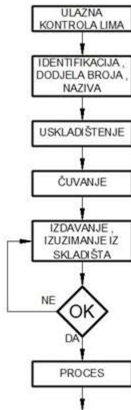
Slika 4.3: Dijagram tijeka ulazne kontrole lima
