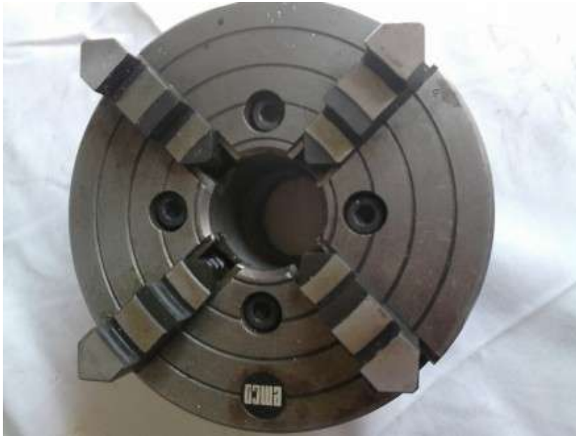
Slika 4.14: Stezna glava za sirovac prirubnice
