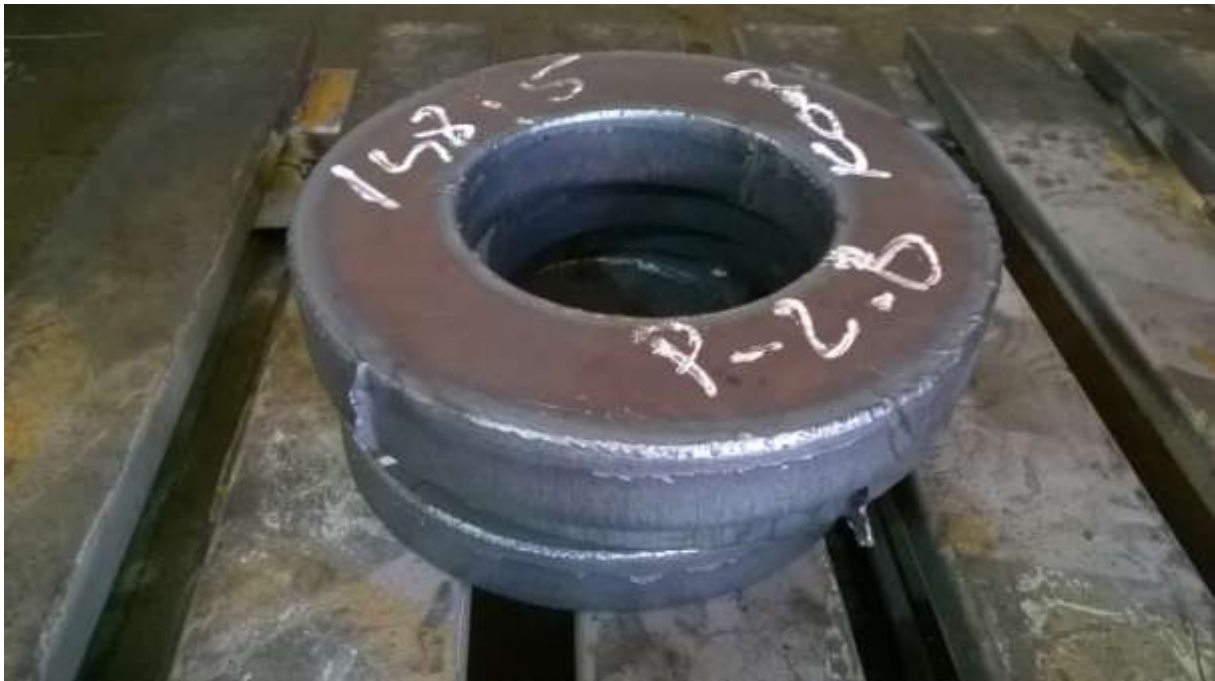
Slika 4.12: Plazmom izrezani sirovac prije obrade tokarenjem
