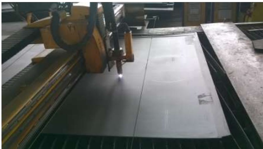
Slika 4.7: Markiranje ploče poklopca plazmom
