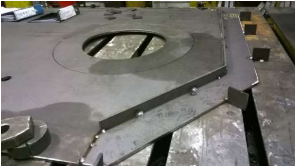
Slika 4.11: Pritezanje ploče poklopca i spajanje s okvirom
