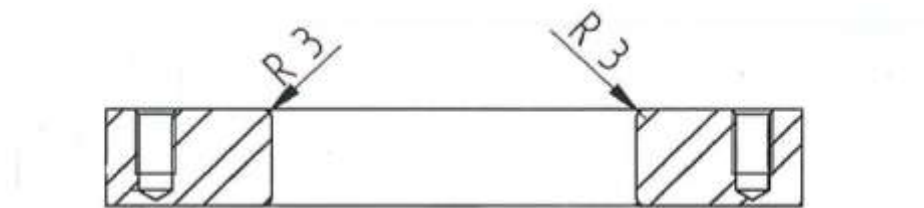
Slika 4.18: Tokarenje radijusa R3
