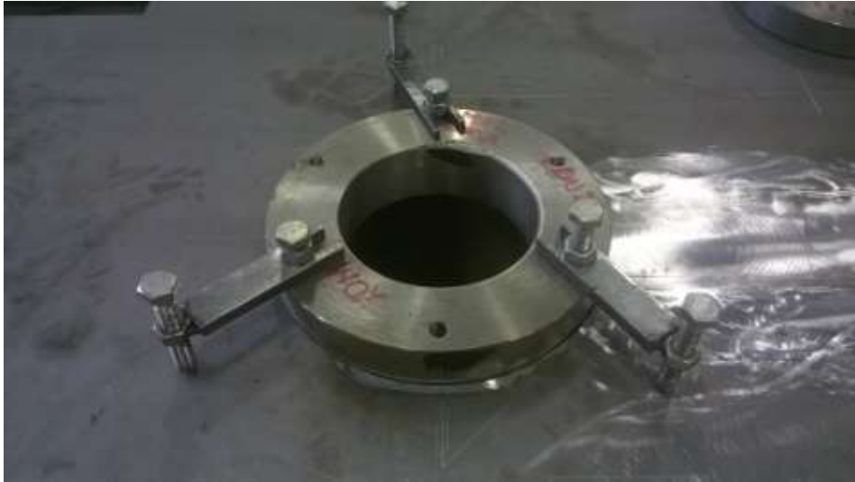
Slika 4.67: Način postavljanja prirubnice nisko naponske strane
