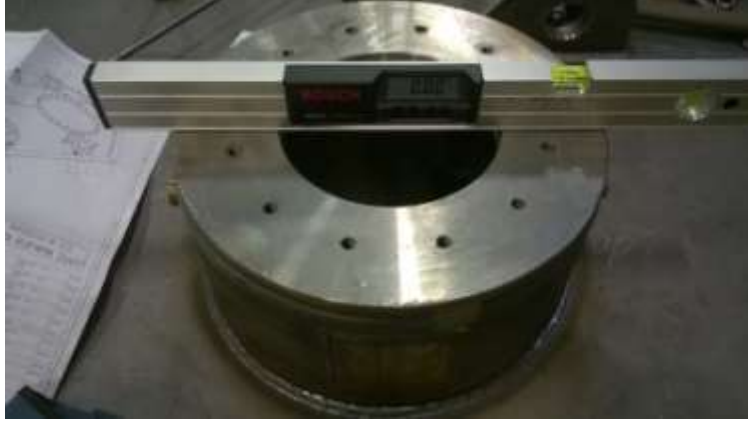
Slika 5.2: Kontrola zračnosti na prirubnicama visokonaponske strane
