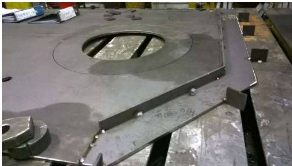
Slika 4.11: Pritezanje ploče poklopca i spajanje s okvirom
