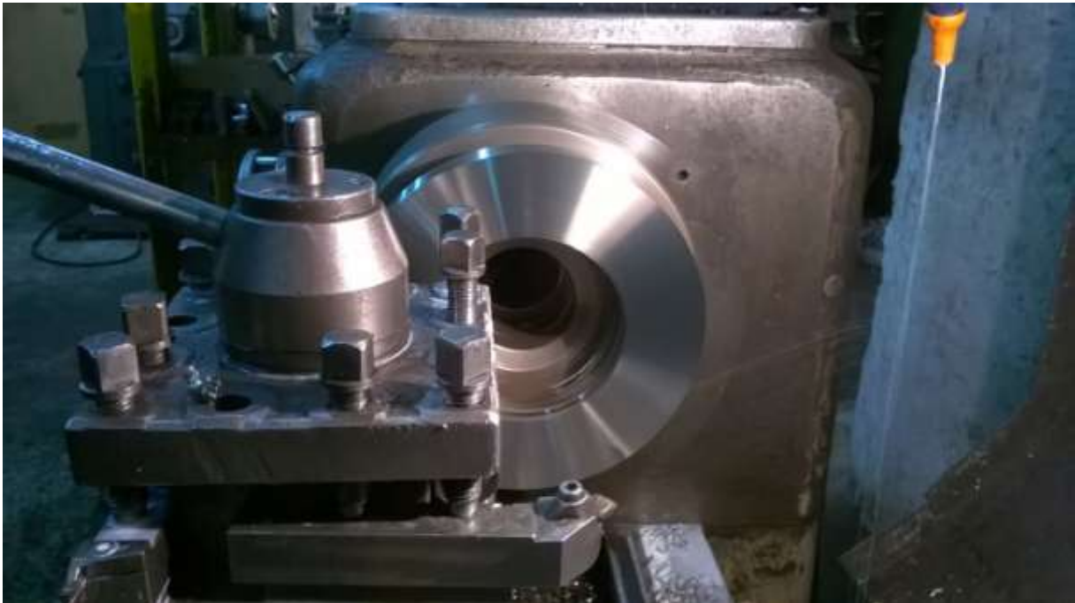
Slika 4.17: Poprečno tokarenje sirovca prirubnice
