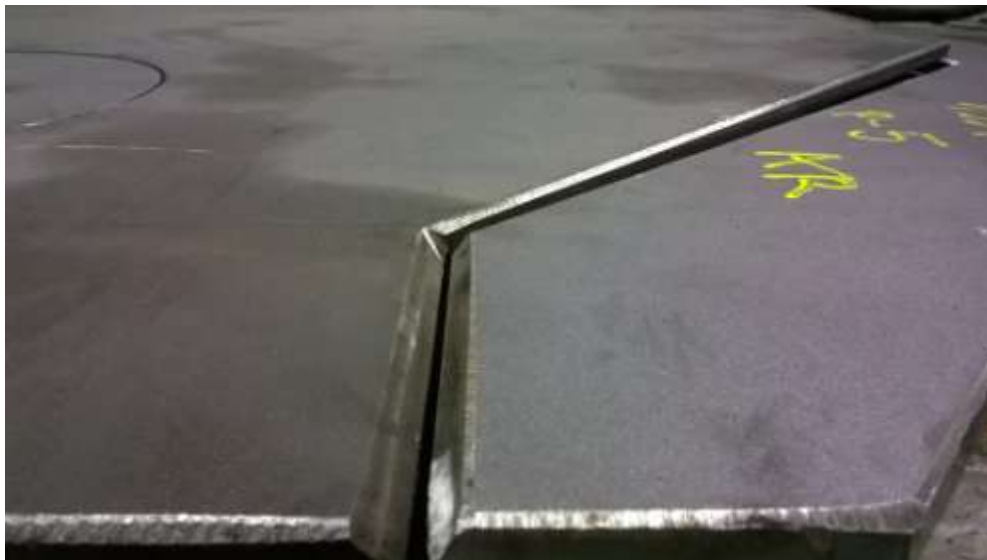
Slika 4.10: Izbrušena priprema za „x“ zavar
