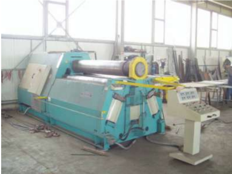
Slika 4.29: Stroj za kružno savijanje limova
