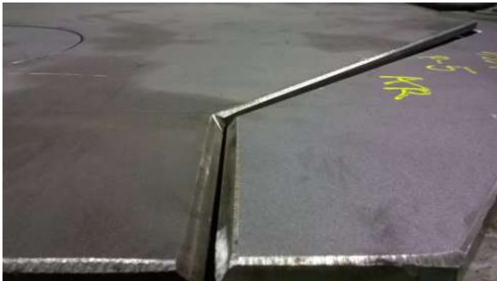
Slika 4.10: Izbrušena priprema za „x“ zavar
