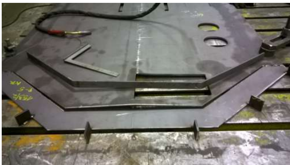
Slika 4.9: Prikaz bombirane ploče poklopca
