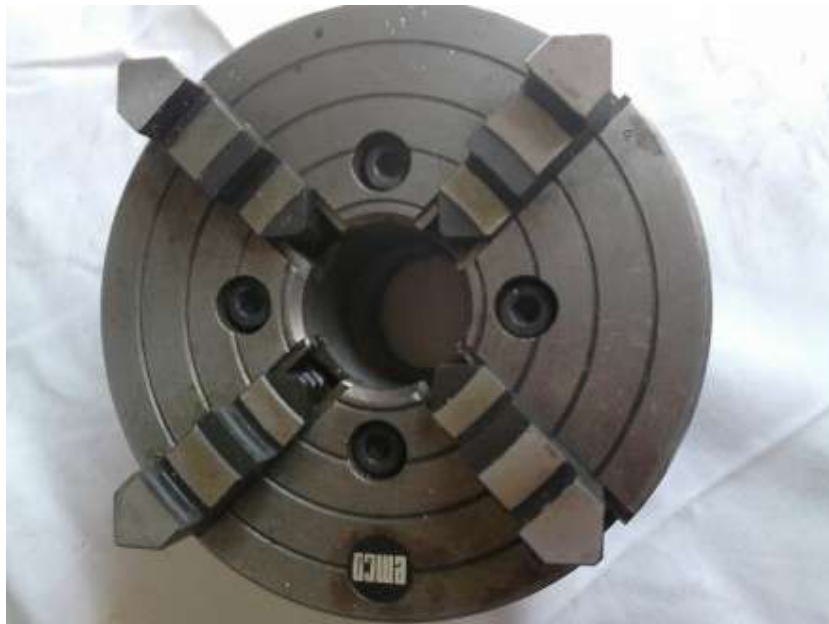
Slika 4.14: Stezna glava za sirovac prirubnice
