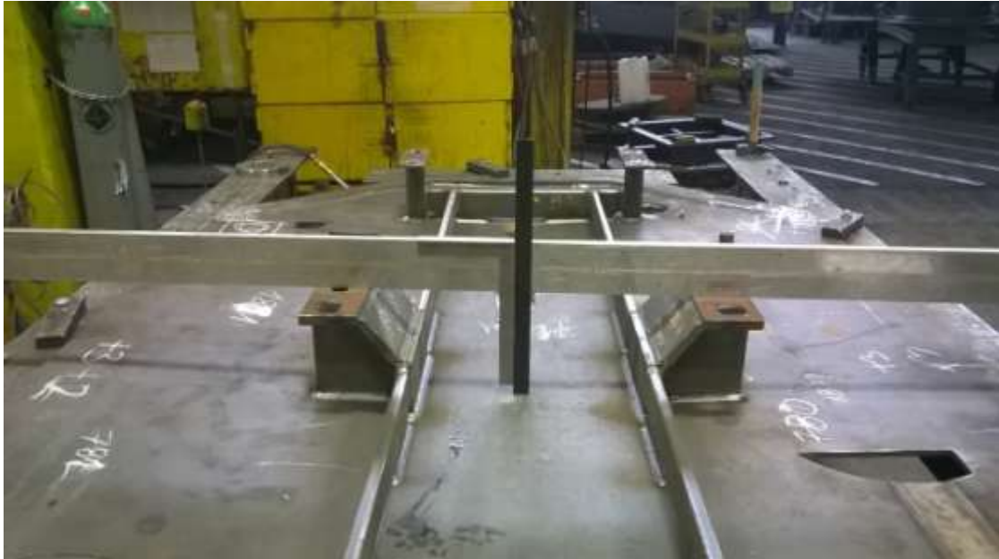
Slika 4.59: Prikaz načina mjerenja nosača jezgre
