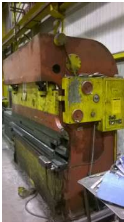
Slika 4.65: Hidraulična preša za Kutno savijanje
