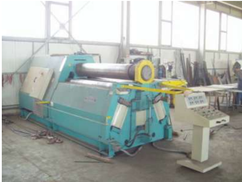
Slika 4.29: Stroj za kružno savijanje limova
