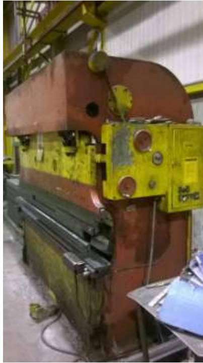
Slika 4.65: Hidraulična preša za Kutno savijanje
