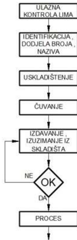
Slika 4.3: Dijagram tijeka ulazne kontrole lima
