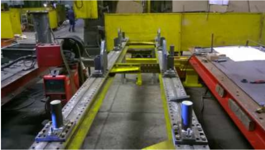
Slika 4.57: Šablona s montiranim nosačima jezgre
