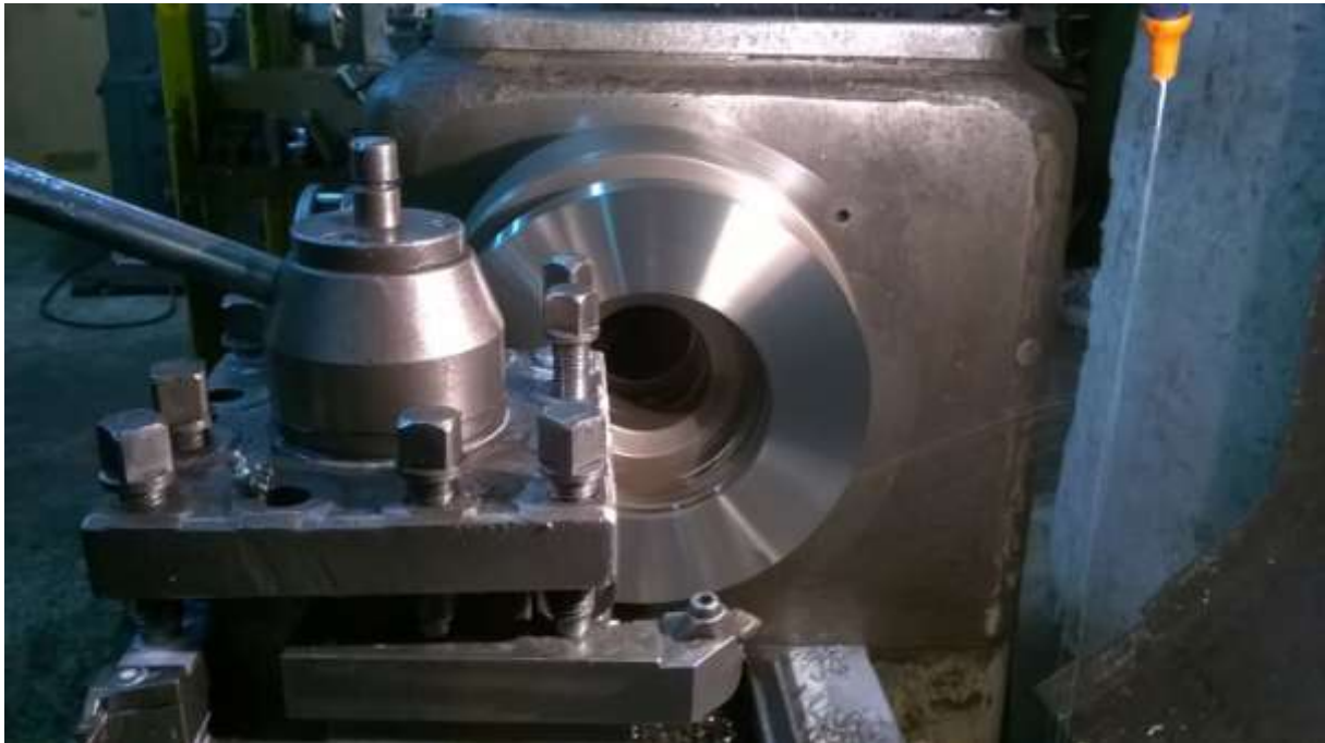
Slika 4.17: Poprečno tokarenje sirovca prirubnice
