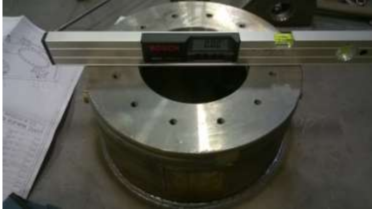
Slika 5.2: Kontrola zračnosti na prirubnicama visokonaponske strane
