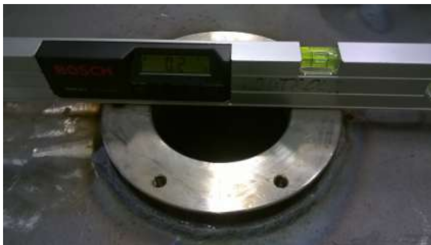
Slika 4.68: Kontrola ravnosti pomoću digitalne libele
