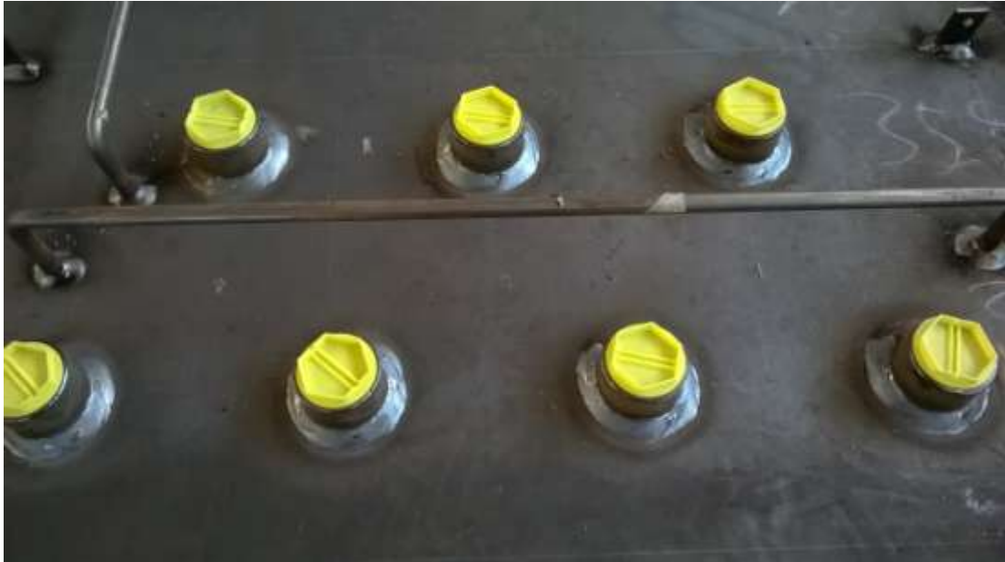
Slika 6.2: Zaštita čahura za termometar prije sačmarenja
