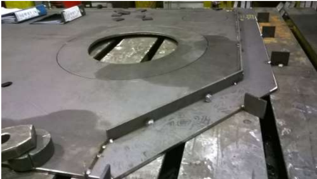
Slika 4.11: Pritezanje ploče poklopca i spajanje s okvirom
