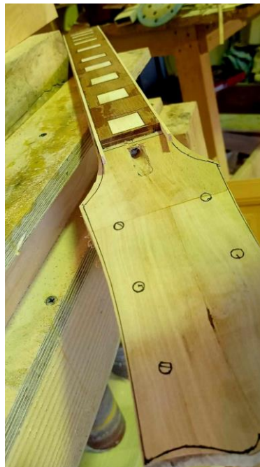
Slika 23. Vrat gitare sa truss rod-om
