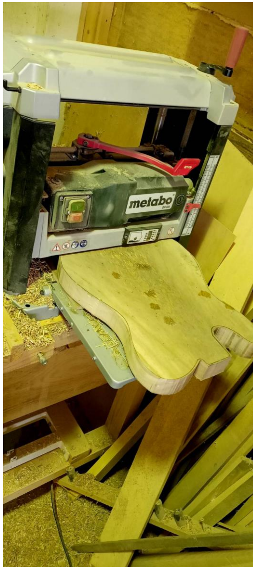
Slika 15. Prikazuje blanjanje tijela gitare
