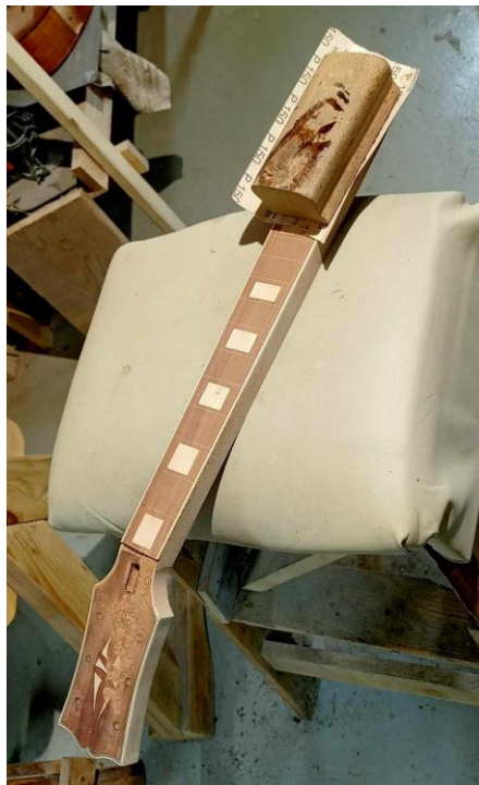
Slika 25. Brušenje vrata gitare
