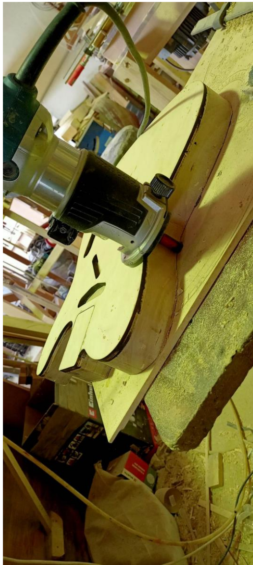
Slika 17. Prikazuje glodanje tijela gitare
