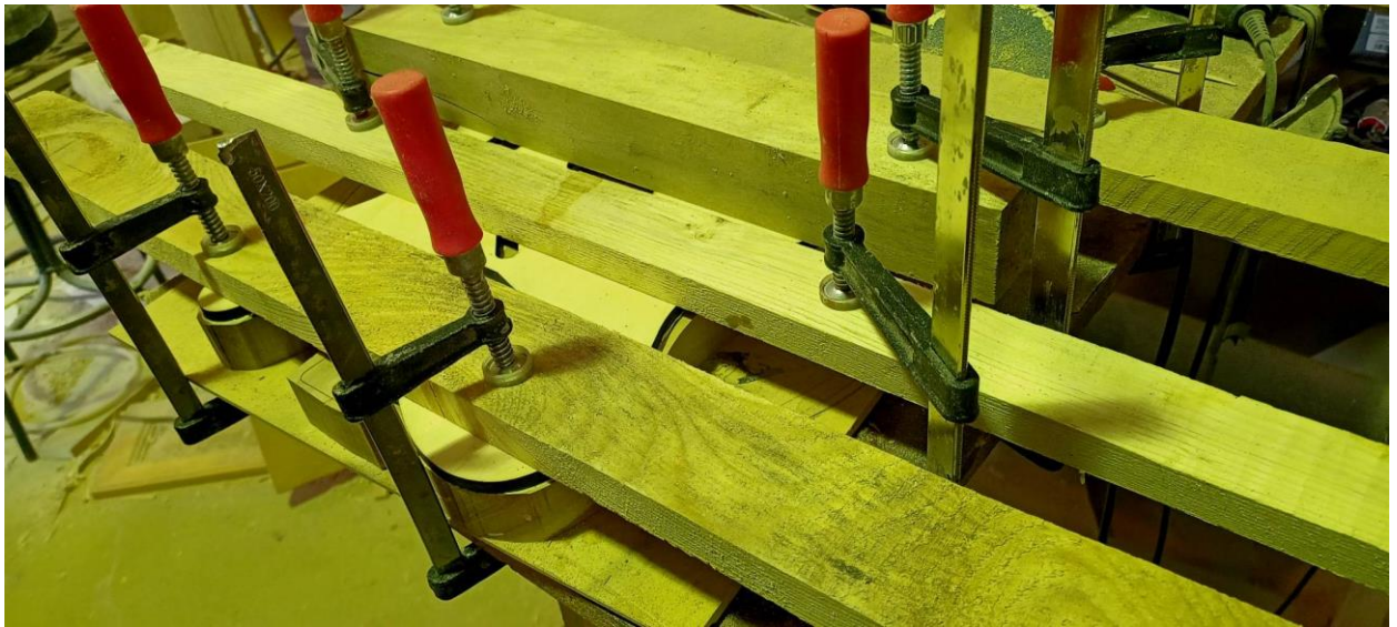
Slika 16. Fiksiranje kritičnih dijelova gitare.
