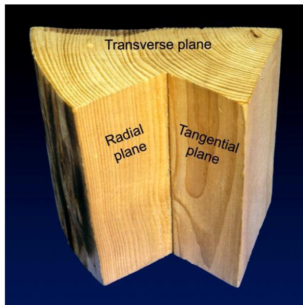
Slika 4. Prikazuje presjeke drva [12]
