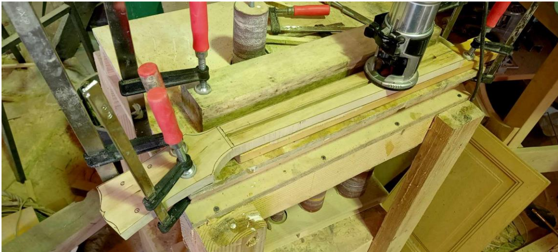
Slika 22. Glodanje utora za truss rod
