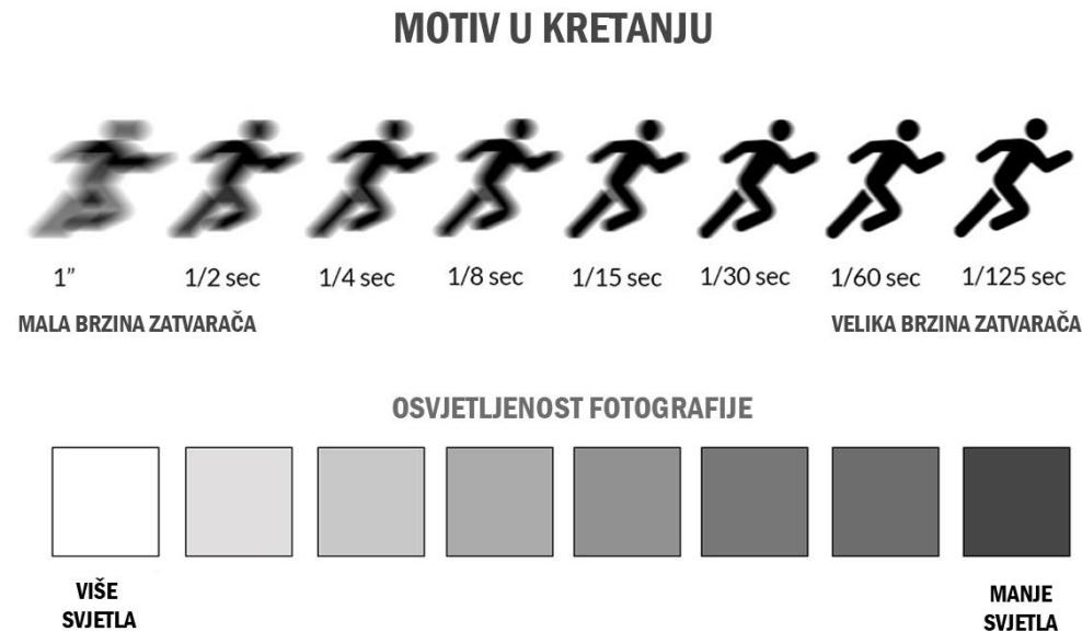
Slika 3.6 Brzina zatvarača
