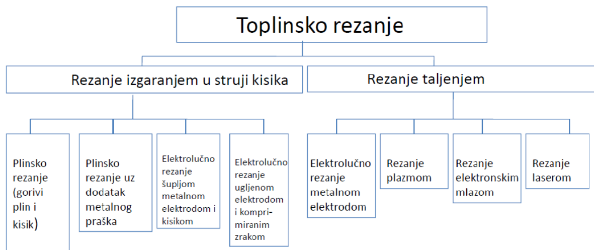
Slika 1. Podjela toplinskih postupaka rezanja [1]
