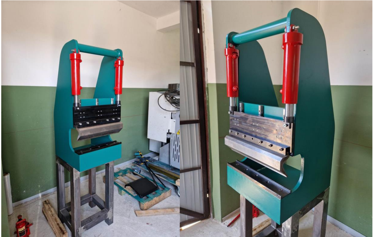
Slika 25. Prikaz probne montaže glavnih komponenata(5)(1)
