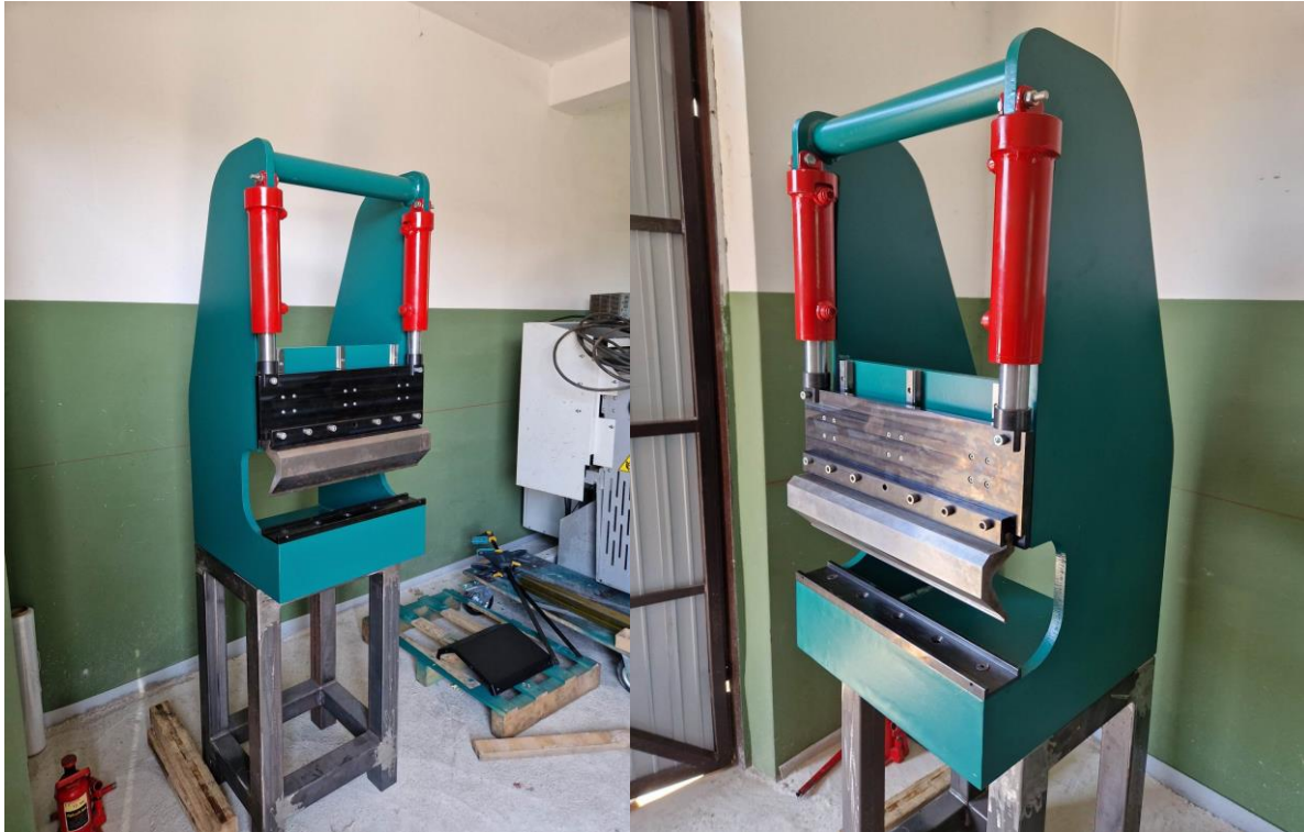
Slika 25. Prikaz probne montaže glavnih komponenata(5)(1)
