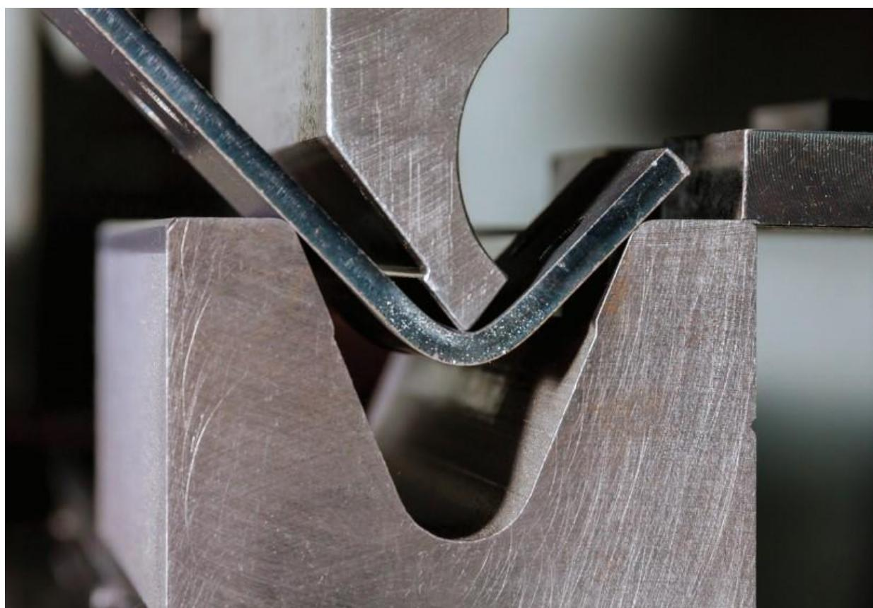
Slika 6. Prikaz alata u procesu deformacije(1)(6)
