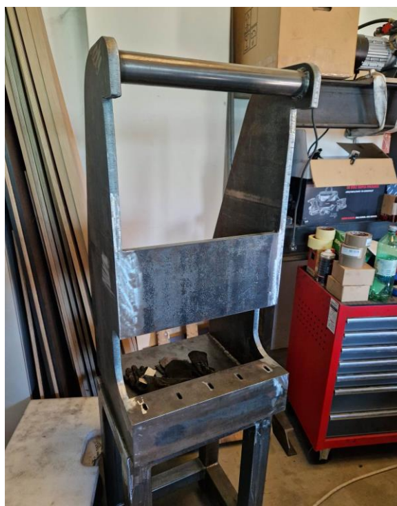
Slika 17. Prikaz zavarene konstrukcije(2)(8)
