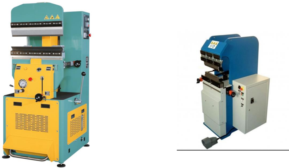
Slika 10. Prikaz preša sa pomicanjem prizme(2)(1)
