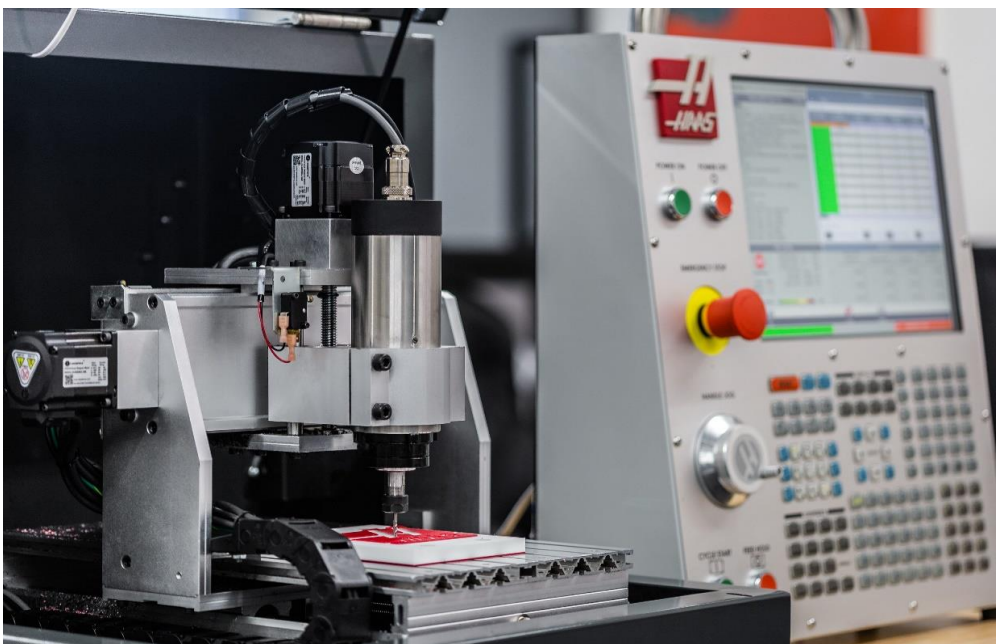
Slika 4.5 Glodalica s podignutim poklopcem [15]
