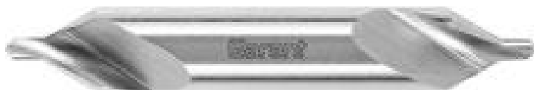
Slika 3.2 Zabušivač ili svrdlo za centriranje
