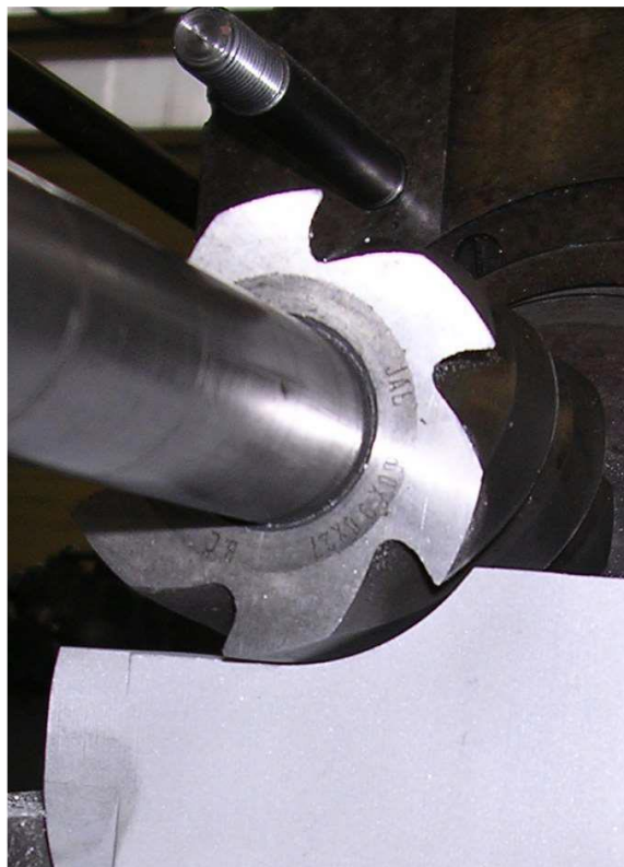
Slika 2.2 Istosmjerno obodno glodanje [2]
