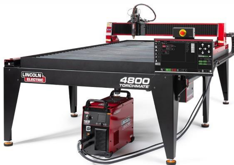
Slika 20. CNC sustav za plazma rezanje [13]
