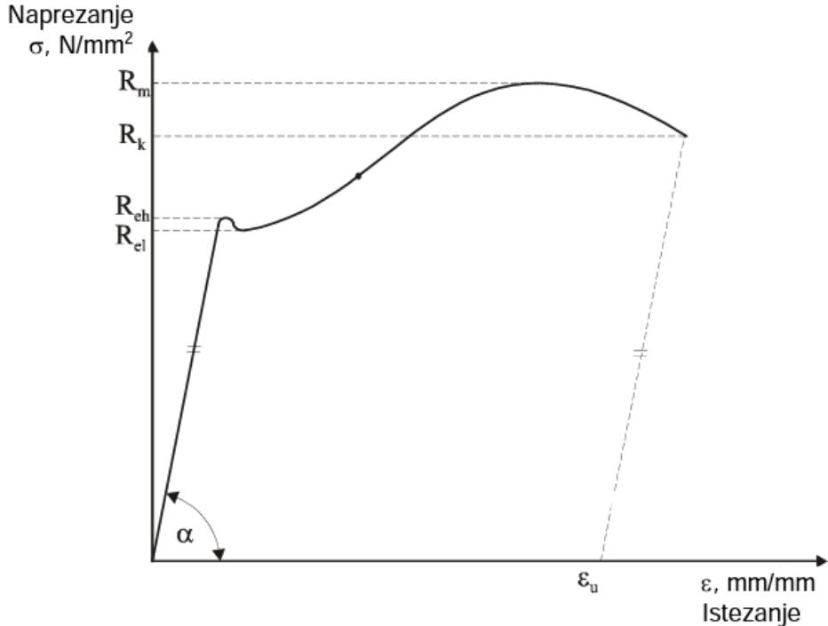
Slika 24. Konvencionalni dijagram naprezanje  $\sigma$  - istezanje  $\varepsilon$  [17]
