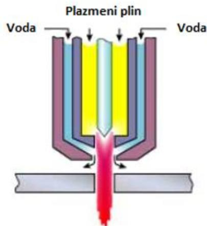
*Slika 9. Plazma rezanje s injektiranim vodom [8]*
