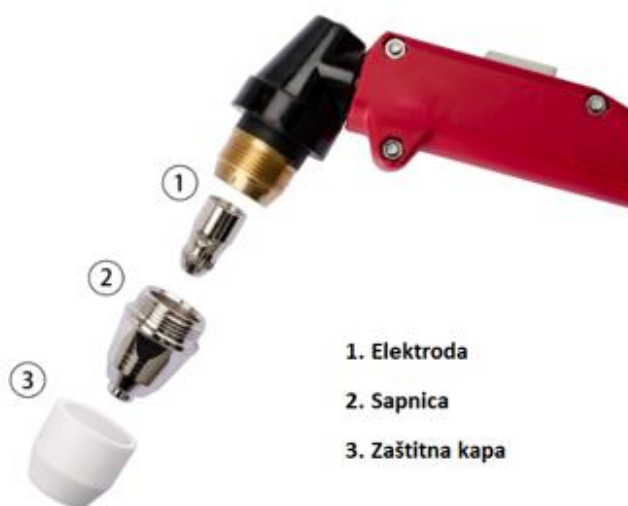
Slika 17. Glavni dijelovi gorionika plazma rezača [12]
