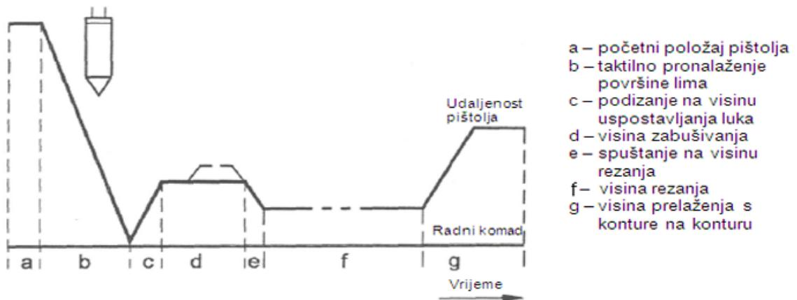
Slika 15. Kretanje plazma rezaca prilikom CNC upravljanog plazma rezanja [10]
