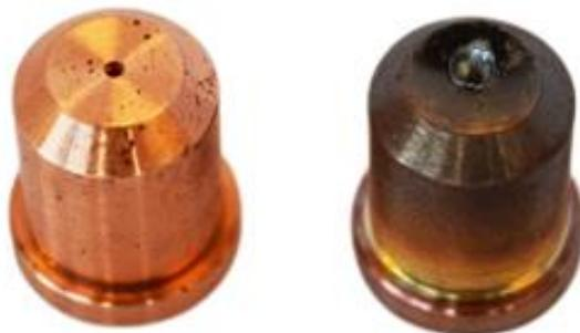
Slika 19. Nova i istrošena sapnica [13]
