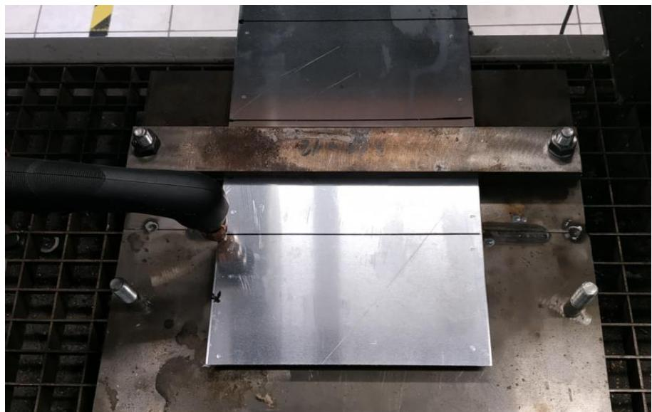
Slika 29. Plazma rezanje rezanja ispitnih uzoraka [21]
