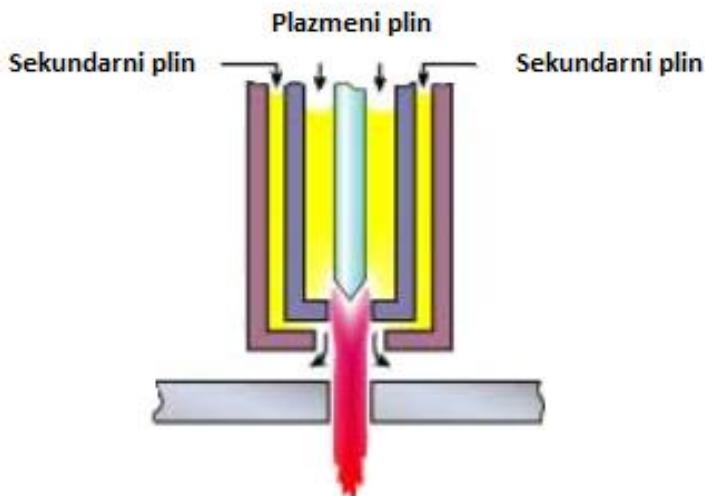
Slika 6. Plazma rezanje sa sekundarnim plinom [8]
