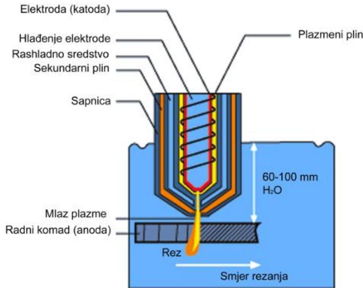
Slika 7. Podvodno plazma rezanje sa sekundarnim plinom [7]
