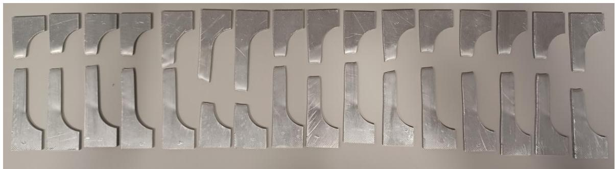
Slika 36. Epruvete nakon ispitivanja [21]
