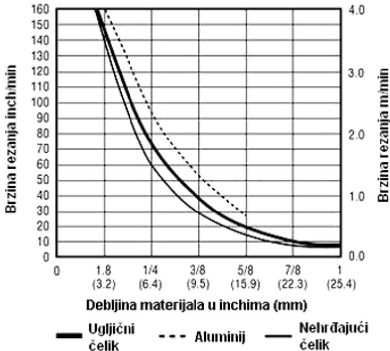
Slika 14. Ovisnost brzine rezanja o debljini materijala [10]
