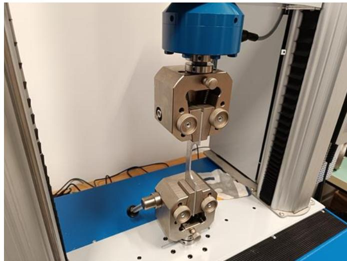
Slika 33. Kidanje epruvete [21]
