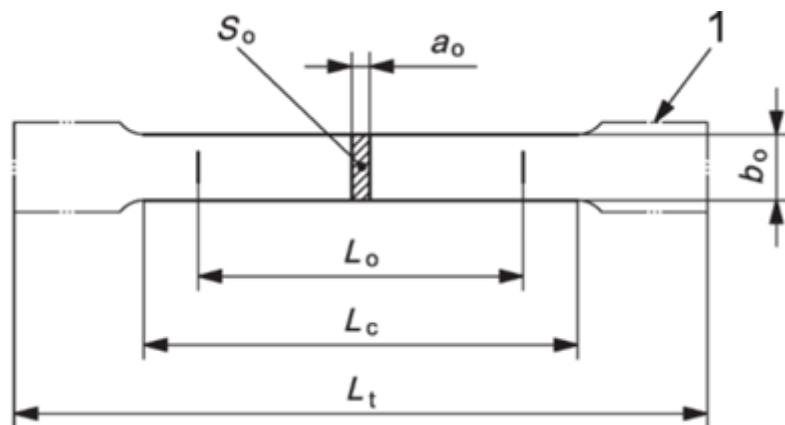
Slika 23. Pravokutni uzorak za ispitvanje prema normi EN ISO 6892-1 [18]
