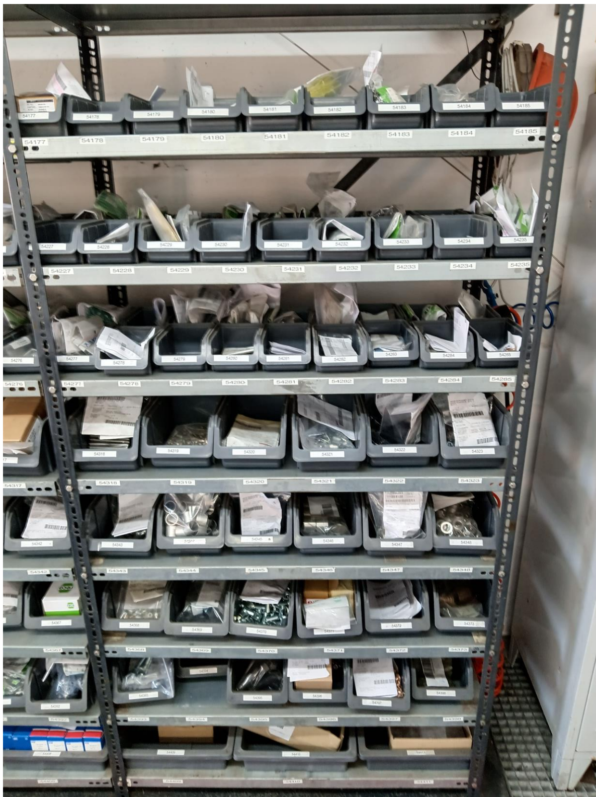
Slika 3.3.4.6. Prikaz primjene 5S metode na policama skladišta (vlastiti rad autora)
