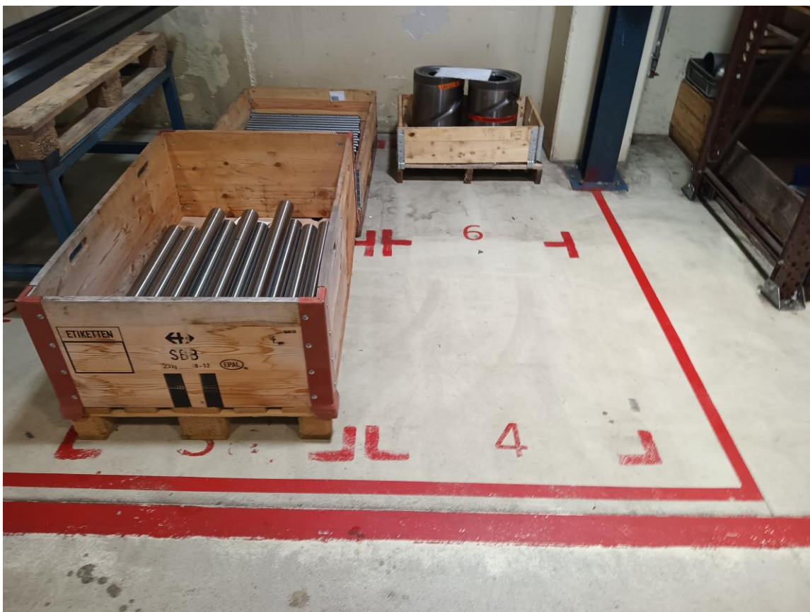
Slika 4.1.2. Oznake na podu za prohodne puteve i palete s gotovim komadima (vlastiti rad autora)
