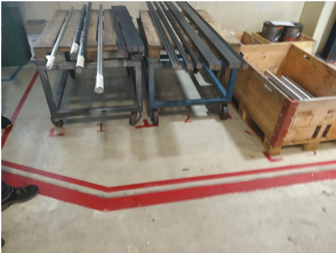
Slika 4.1.1. Oznake na podu za prohodne puteve i kolica s materijalom (vlastiti rad autora)
