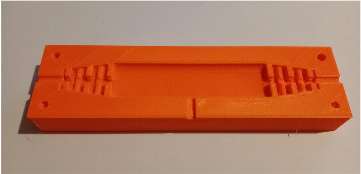
*Slika 65. Prototip donjeg dijela drugog kalupa*
