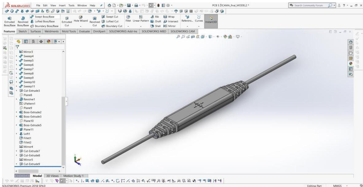
Slika 30. 3D model lijevanog kućišta
