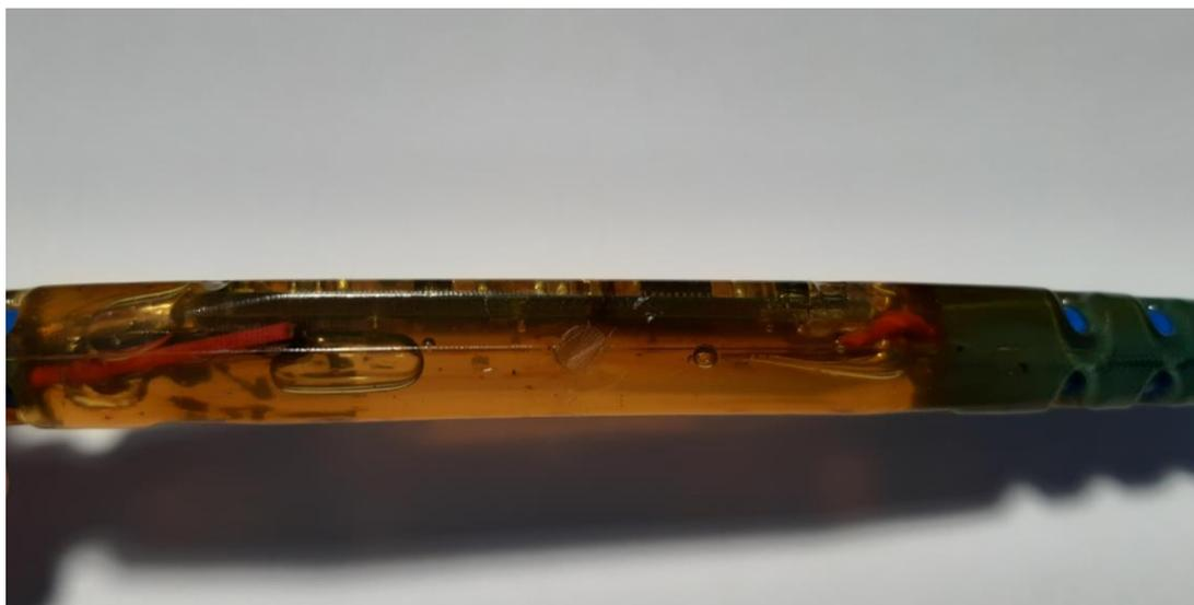
*Slika 18. Greška kod niskotlačnog lijevanja PCB pločice*
