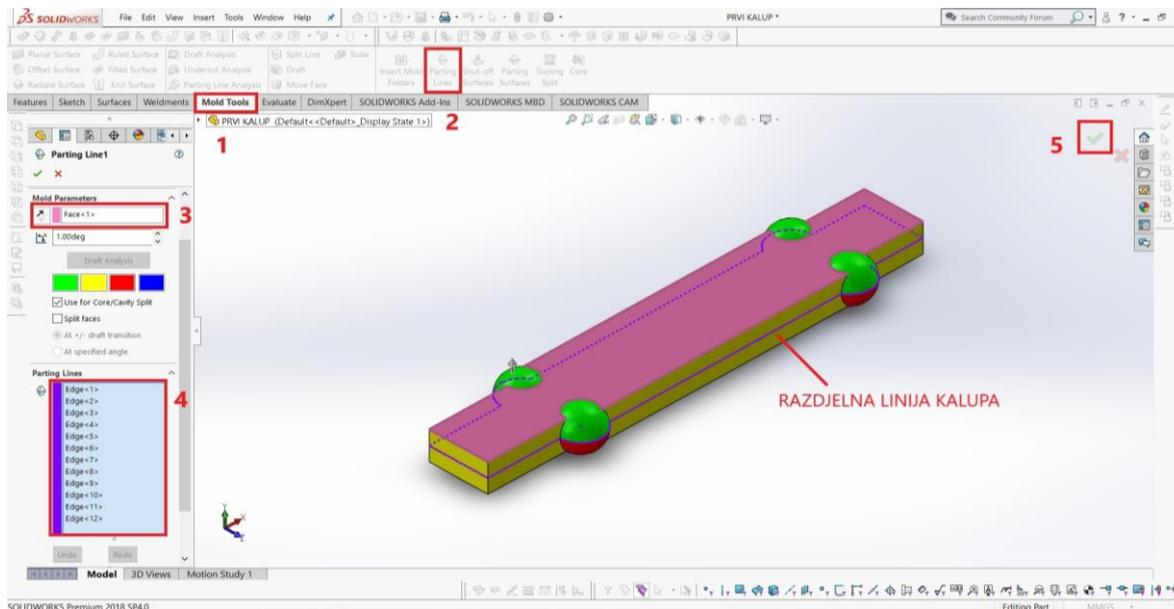
Slika 22. Izrada Razdjelne linije kalupa (*Parting Line*)
