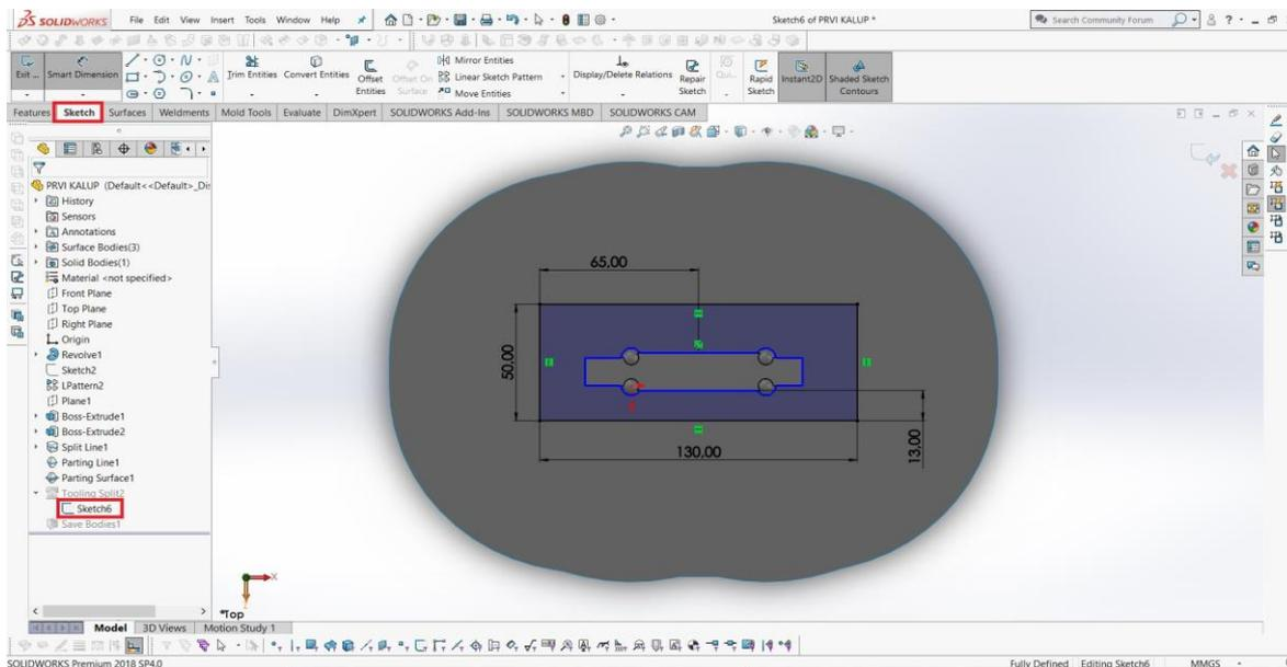
Slika 24. Skica vanjskih dimenzija kalupa na razdjelnoj površini
