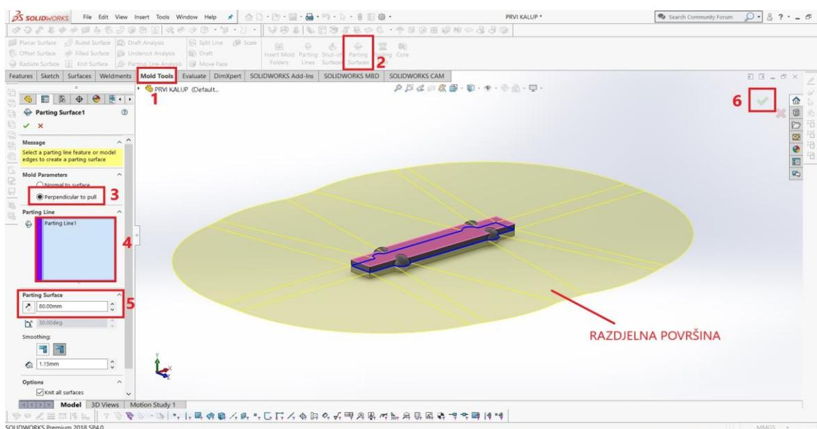
Slika 23. Izrada Razdjelne površine kalupa (*Parting Surface*)
