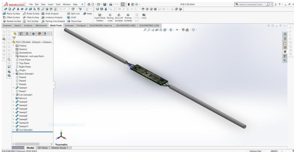
Slika 43. 3D model PCB pločice sa vodičima
