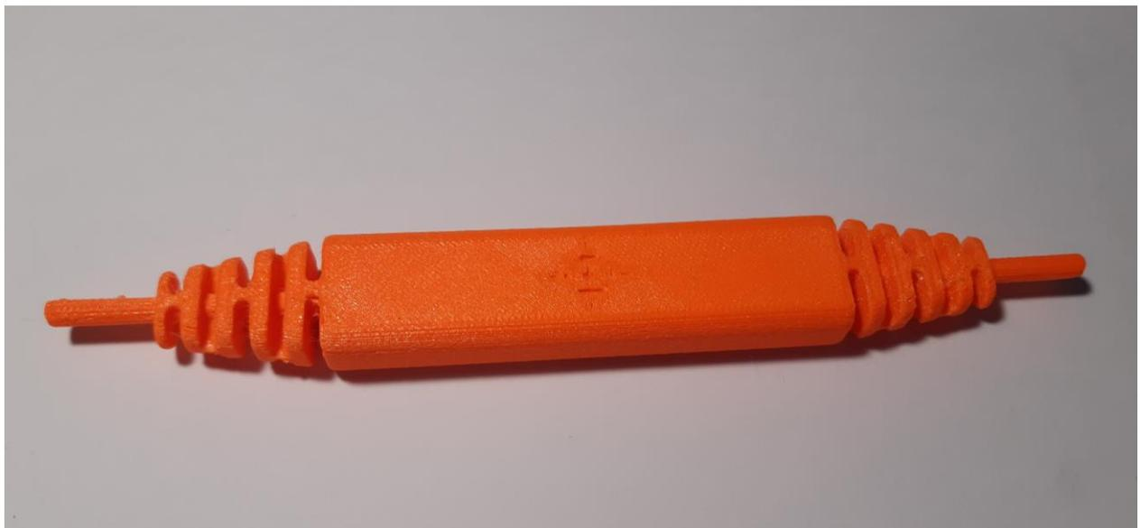
*Slika 60. 3D tisk završnog modela V1.0*
