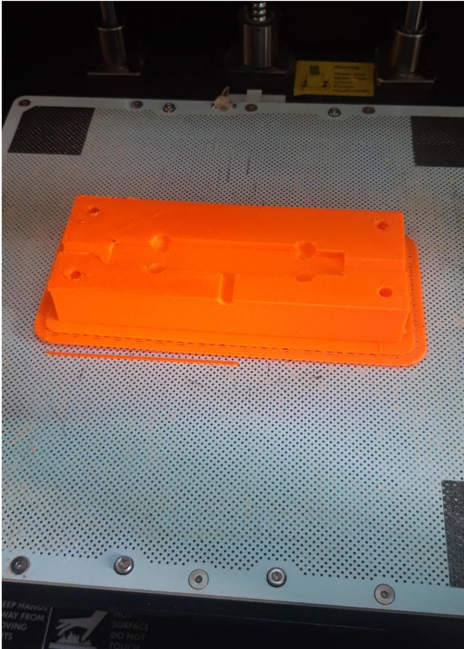
*Slika 61. Prototip donjeg dijela prvog kalupa*
