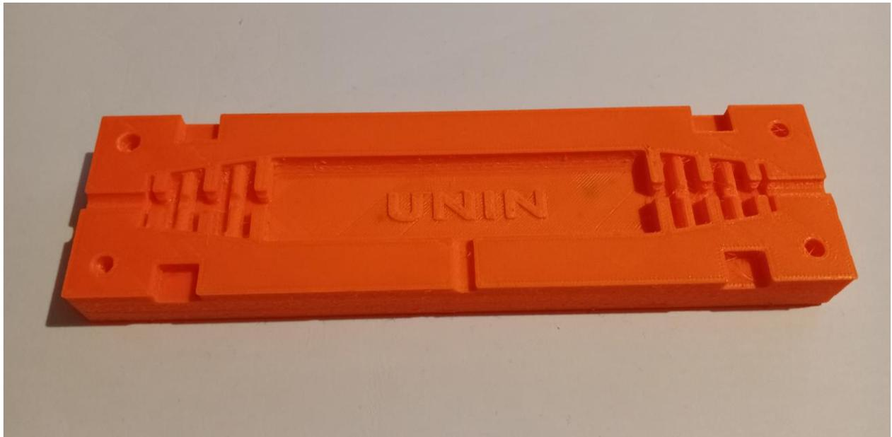
*Slika 66. Prototip gornjeg dijela drugog kalupa*
