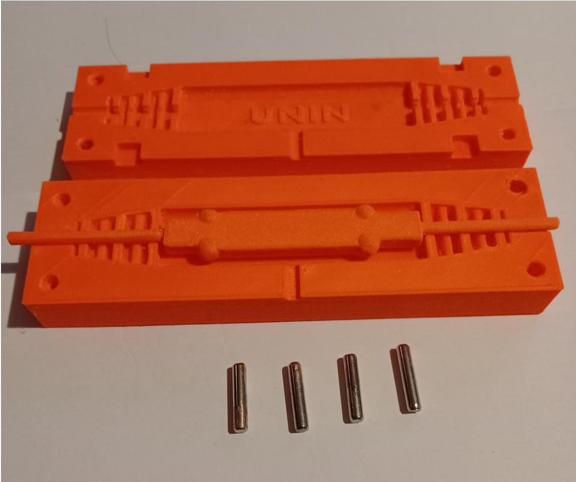
*Slika 67. Prototipovi dijelova sklopa drugog kalupa sa prototipom prvog lijevanog modela*
