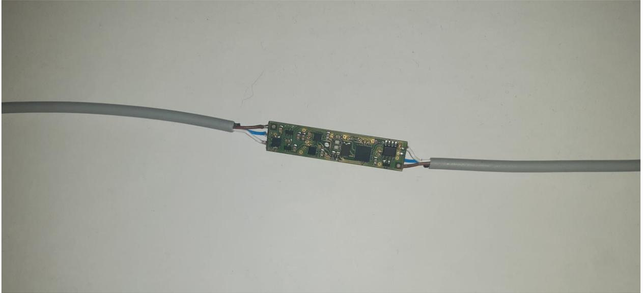
*Slika 17. Stvarni model PCB pločice sa vodičima*
