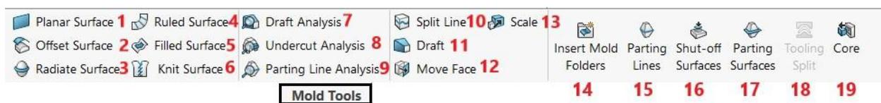
Slika 13. Kartica **Mold Tools** SolidWorks 2018
