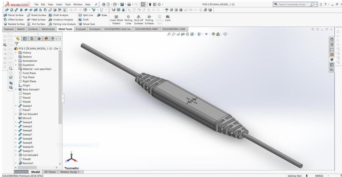
*Slika 47. 3D prikaz drugog lijevanog modela V1.0*
