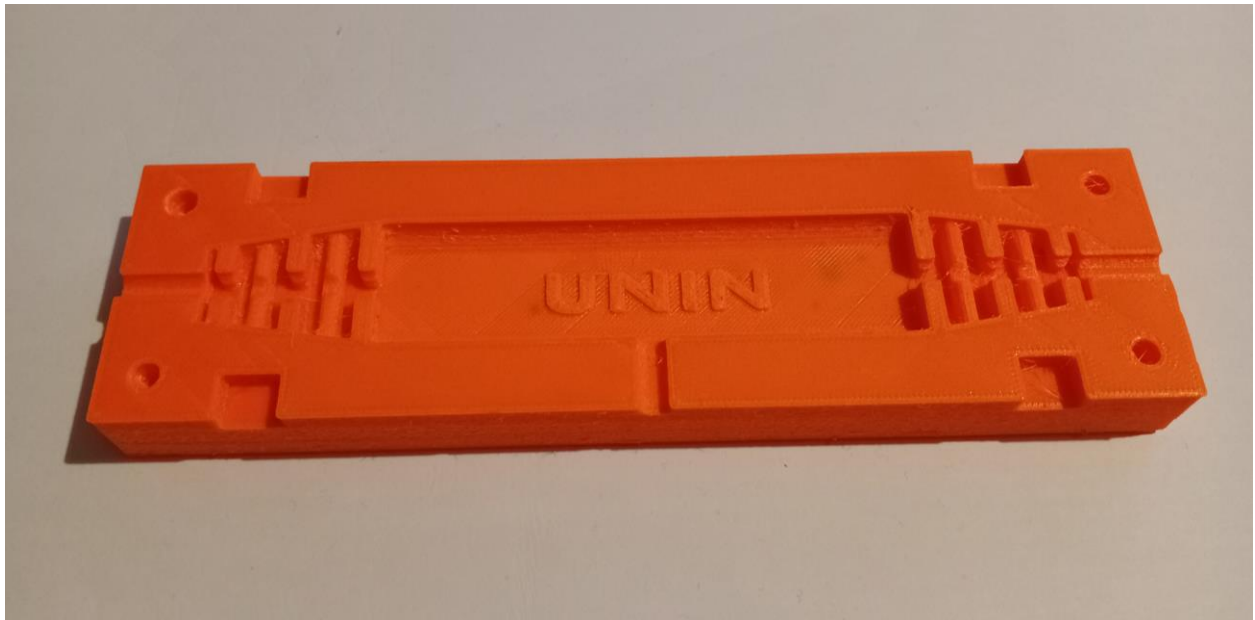
Slika 66. Prototip gornjeg dijela drugog kalupa
