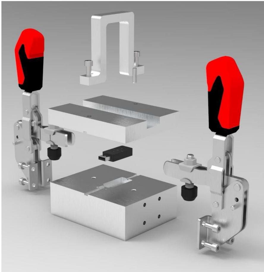
Slika 4. Fotorealističan prikaz 3D sklopa kalupa [1]
