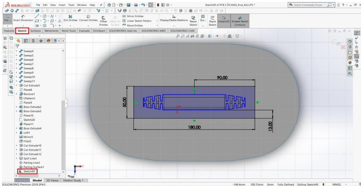
Slika 35. Skica vanjskih dimenzija kalupa na razdjelnoj površini
