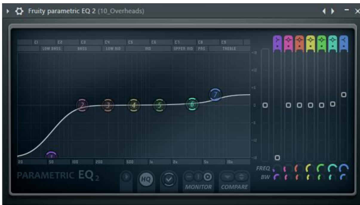
Slika 45. EQ2 primijenjen na stereo viseće mikrofone
