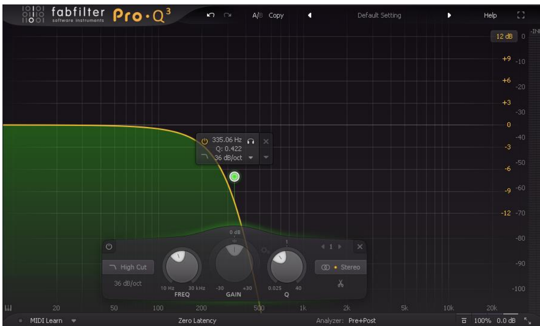
Slika 15. Fabfilter Q3 -Niskopropusni filter
