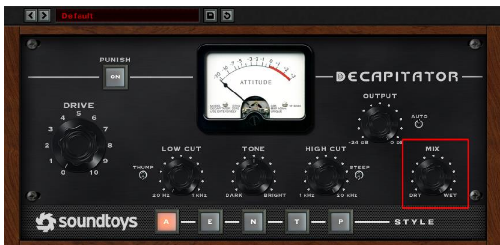
Slika 23. Soundtoys Decapitator – paralelna saturacija - 100% postavka saturacije
