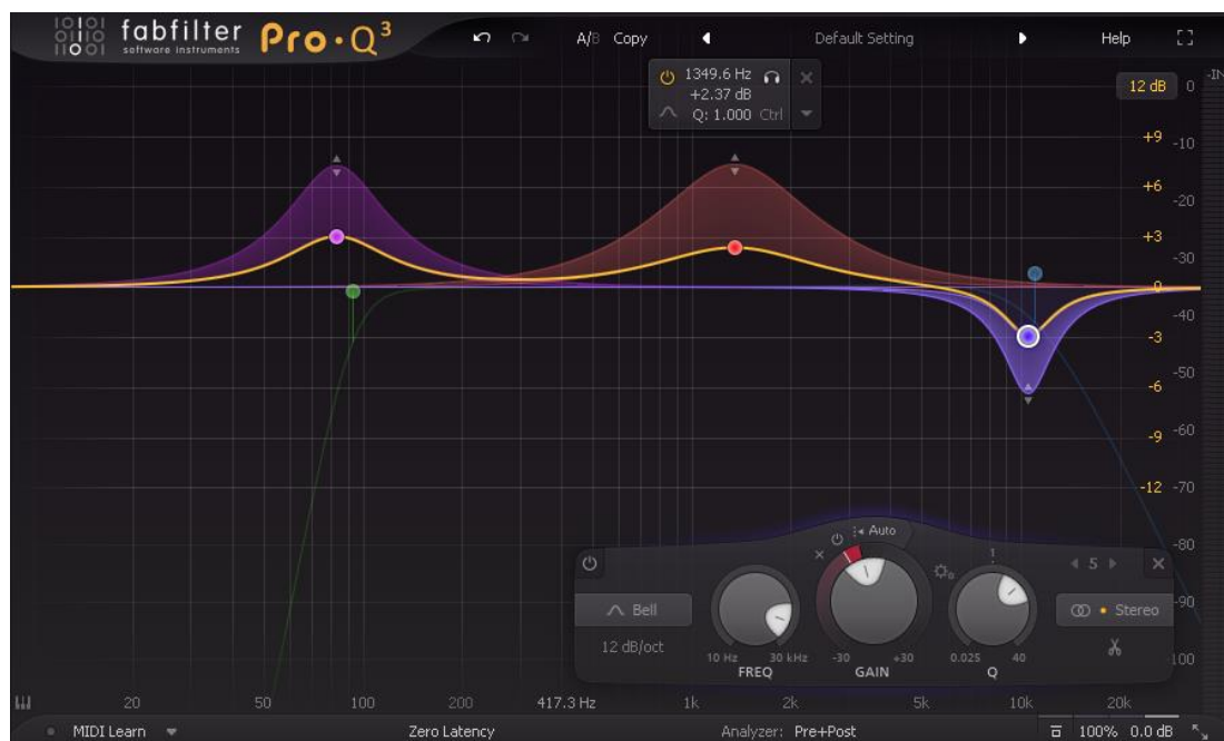
Slika 16. Fabfilter Q3 -Dinamički EQ
