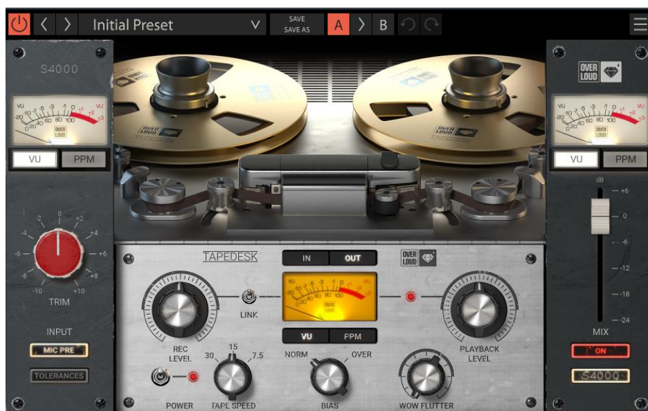
Slika 20. Gem TAPEDESK – digitalni dodatak – digitalni emulator saturacije analogne trake
