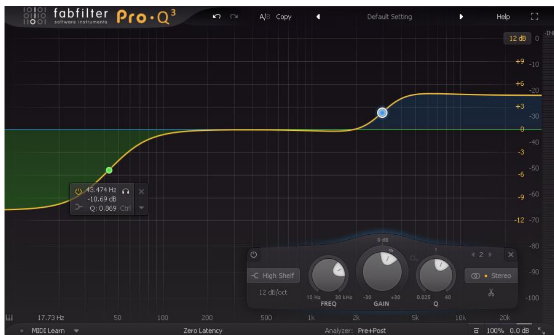
Slika 14. Fabfilter Q3 - Filter niske (lijevo) i visoke police (desno)
