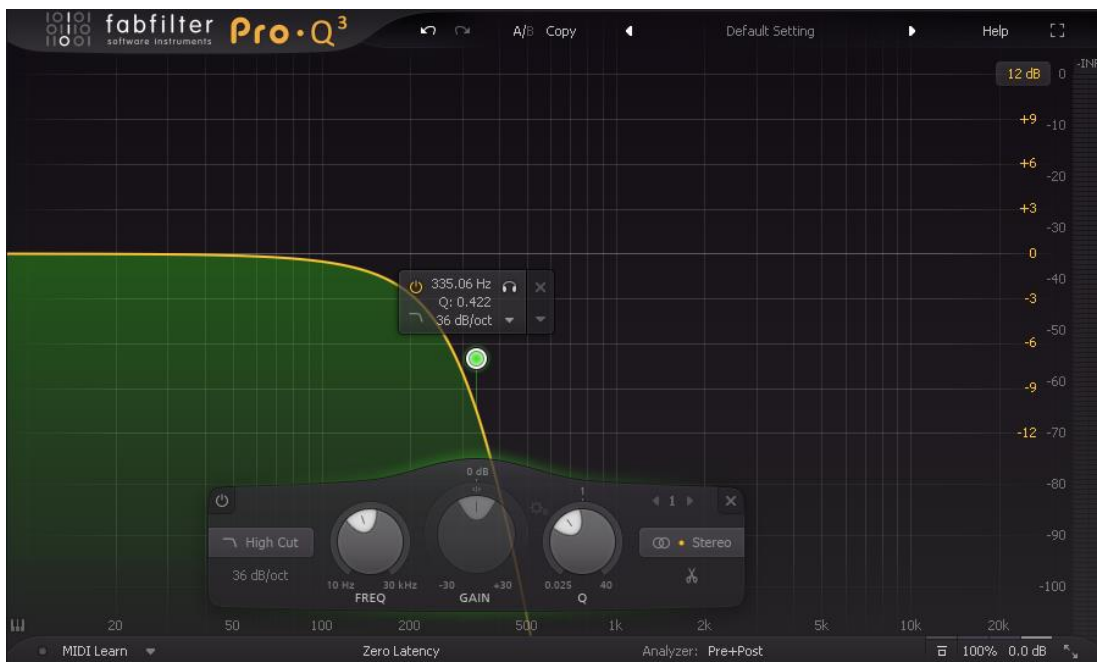
Slika 15. Fabfilter Q3 -Niskopropusni filter
