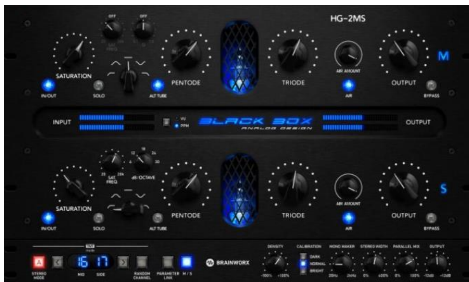
Slika 21. Black Box Analog Design HG-2MS– digitalni dodatak – emulator saturacije cijevi
