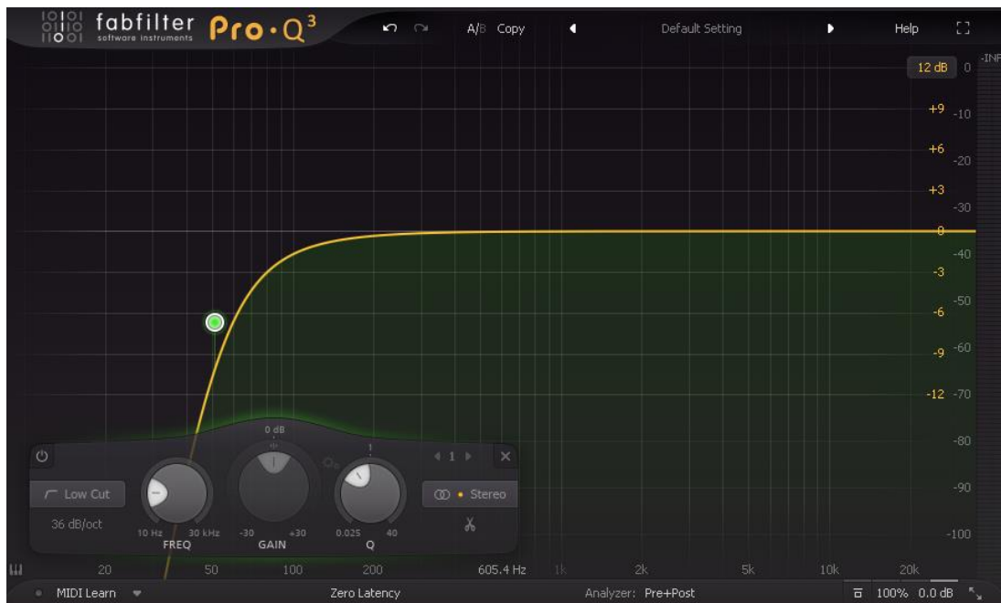
Slika 14. Fabfilter Q3 -Visokopropusni filter
