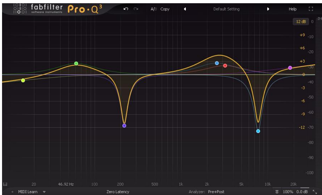
Slika 13. Fabfilter PRO Q3 – parametarski EQ
