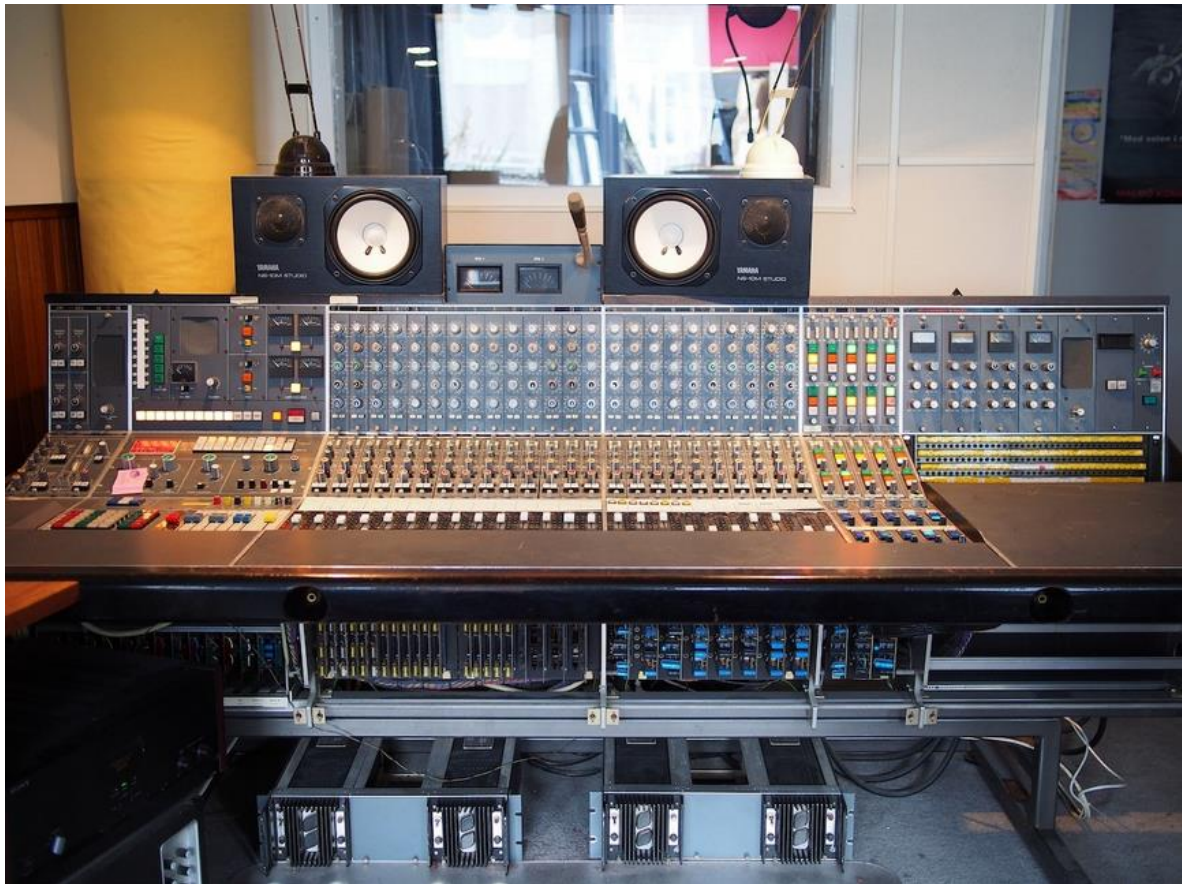
Slika 2. 24 kanalna analogna konzola - Neve 24 Channel BBC Console (Vintage)
