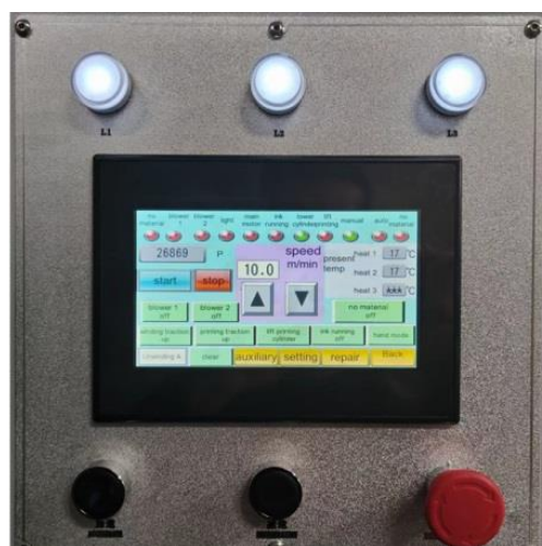
Slika 24 Zaslon stroja fleksotiska
