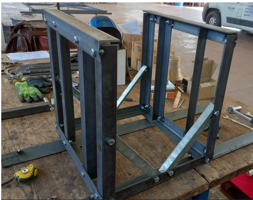
Slika 2.3.1. Izrada postolja za zvono
