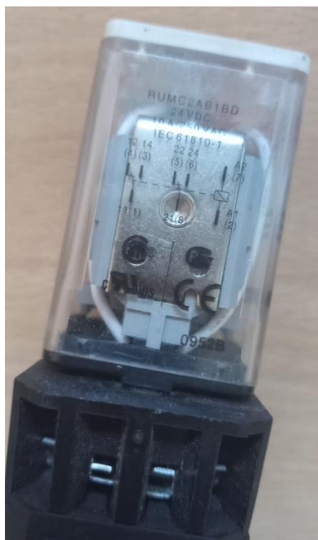
Slika 3.5.2. Shema spajanja releja otisnuta na releju
