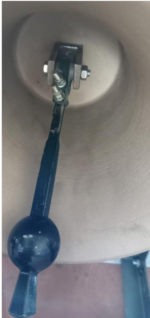
Slika 2.2.1. Čekić postavljen u zvono
