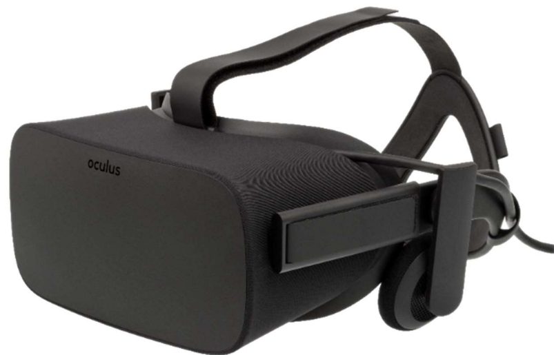
Slika 2.4 Primjer HMD zaslona – Oculus Rift
