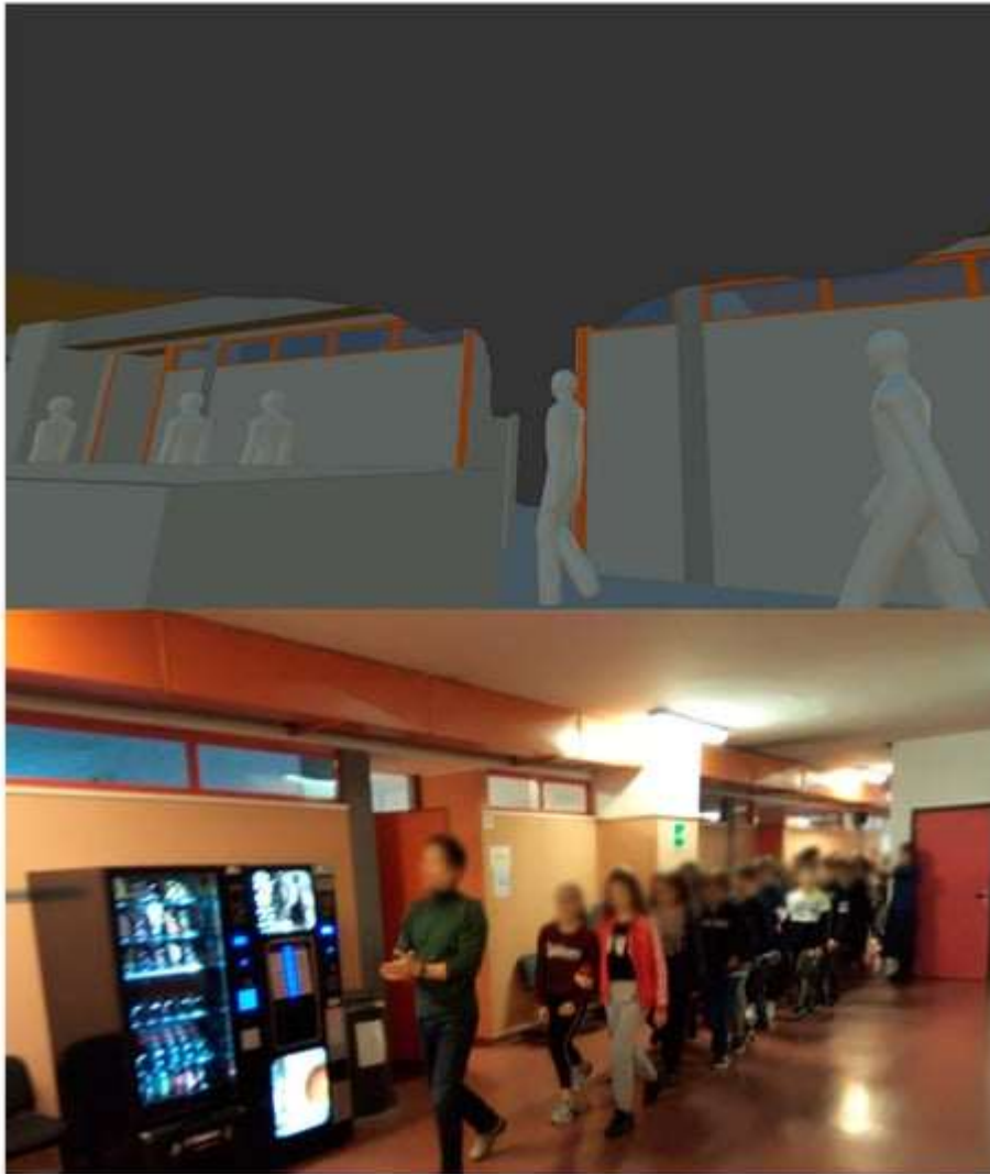
Slika 4.11 Scenarij hitne evakuacije u slučaju požara u modelu virtualne stvarnosti ( gore ), scenarij stvarnog svijeta ( dolje ).
