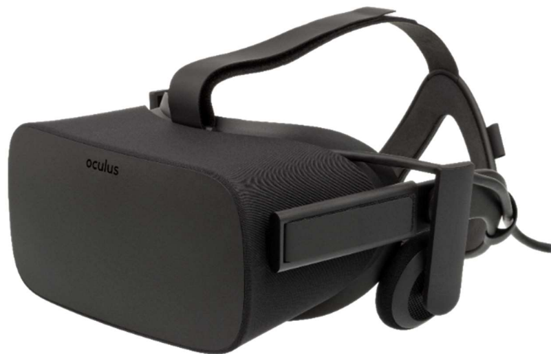
Slika 2.4 Primjer HMD zaslona – Oculus Rift
