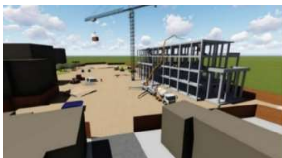
Slika 4.8 3D model scenarija 1 plana gradilišta
