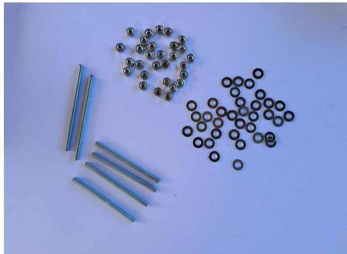
Slika 37. Navojne šipke M4, matice M4, podloške M4
