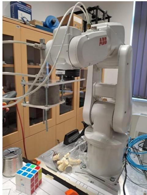
Slika 43. Prototip prihvavnice montiran na robota
