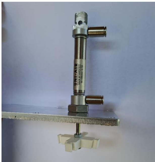
Slika 40. Montaža cilindra i središnje vodilice
