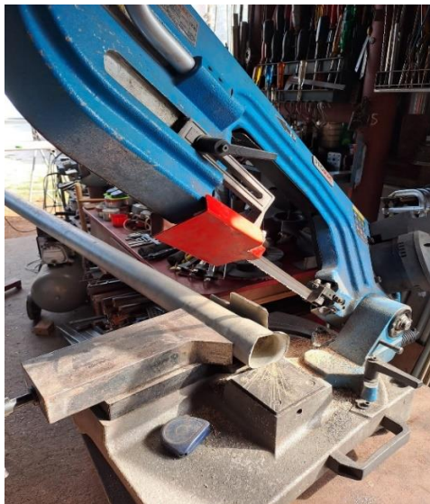
Slika 35. Rezanje PVC cijevi
