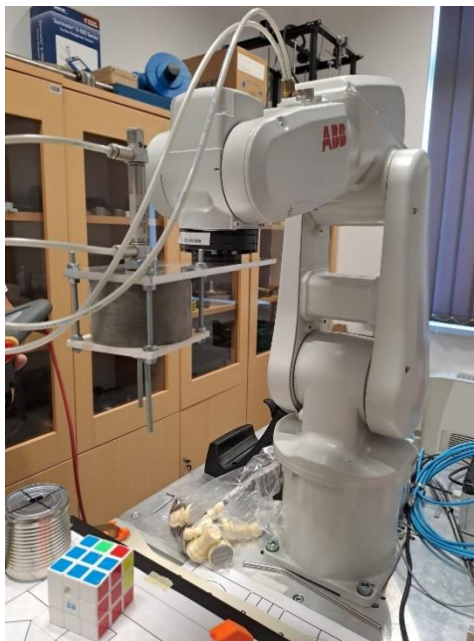
Slika 43. Prototip prihvatnice montiran na robota
