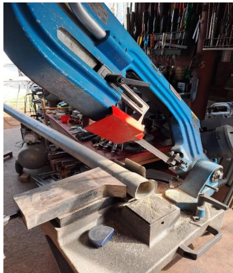
Slika 35. Rezanje PVC cijevi
