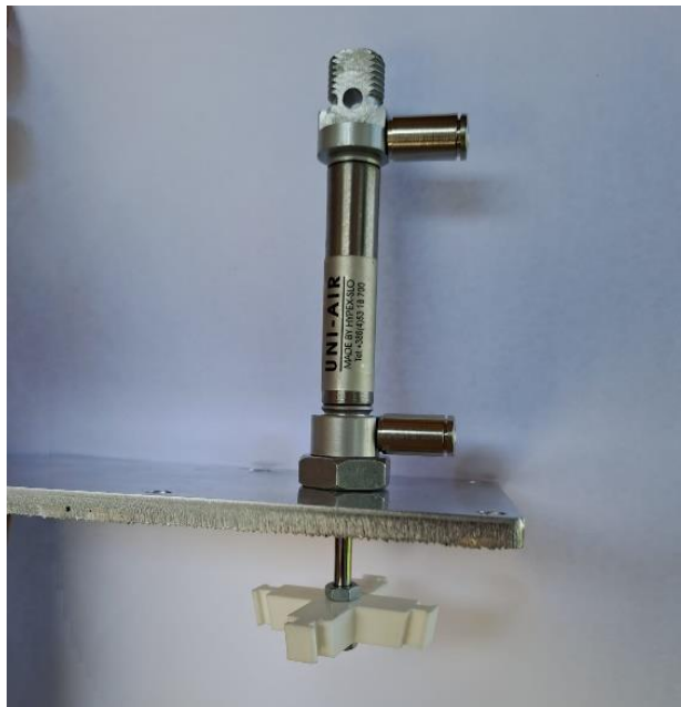
Slika 40. Montaža cilindra i središnje vodilice
