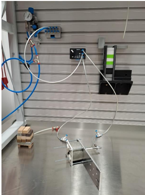
Slika 42. Test funkcionalnosti prototipa prihvatnice
