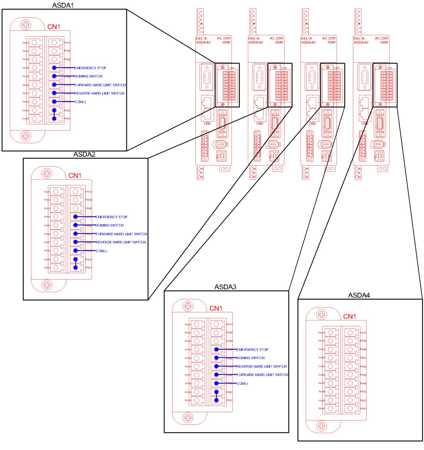
Shema digitalnih ulaza CN1 konektora na ASDA-A2 servo pogonu
