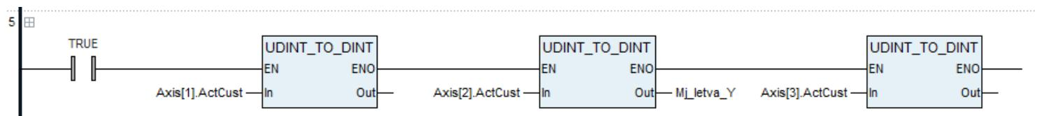
Slika 6.4 Izvedba dohvata ulaznih impulsa s mjerne letve u CANopen Builder programu [6]
