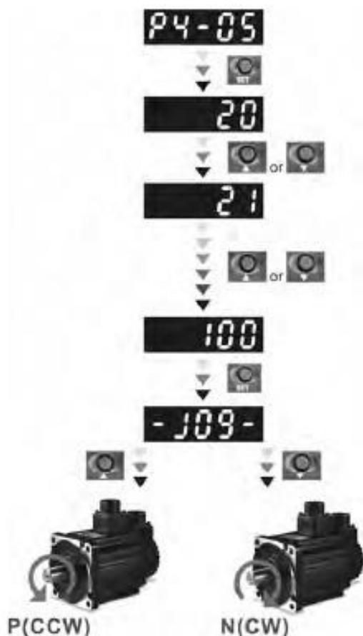
Slika 3.1 JOG motora direktno na servo pogonu [2]
