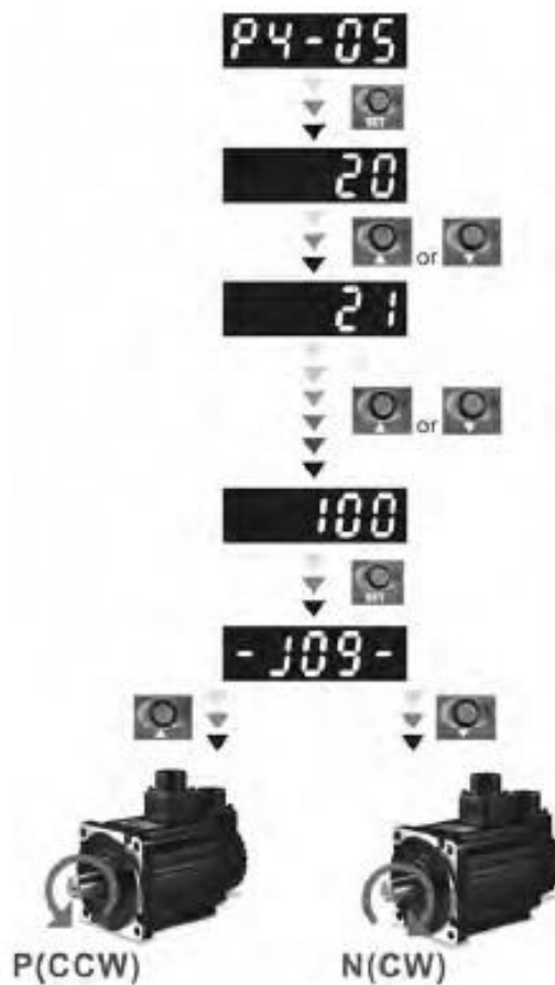
Slika 3.1 JOG motora direktno na servo pogonu [2]
