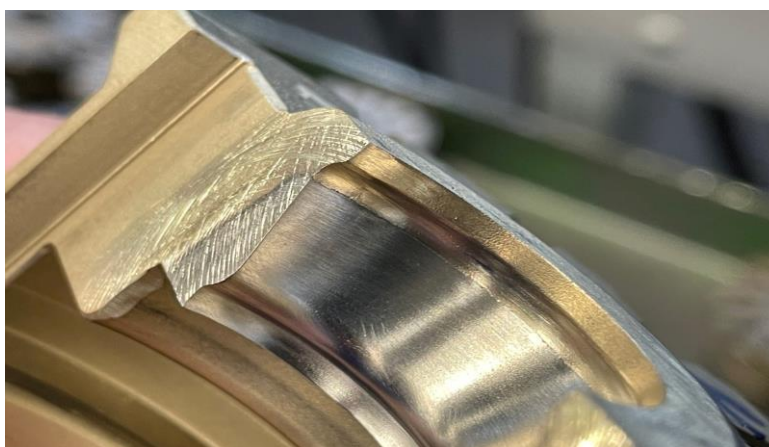
Slika 18. Primjer otpadanja metalizacije [27]
