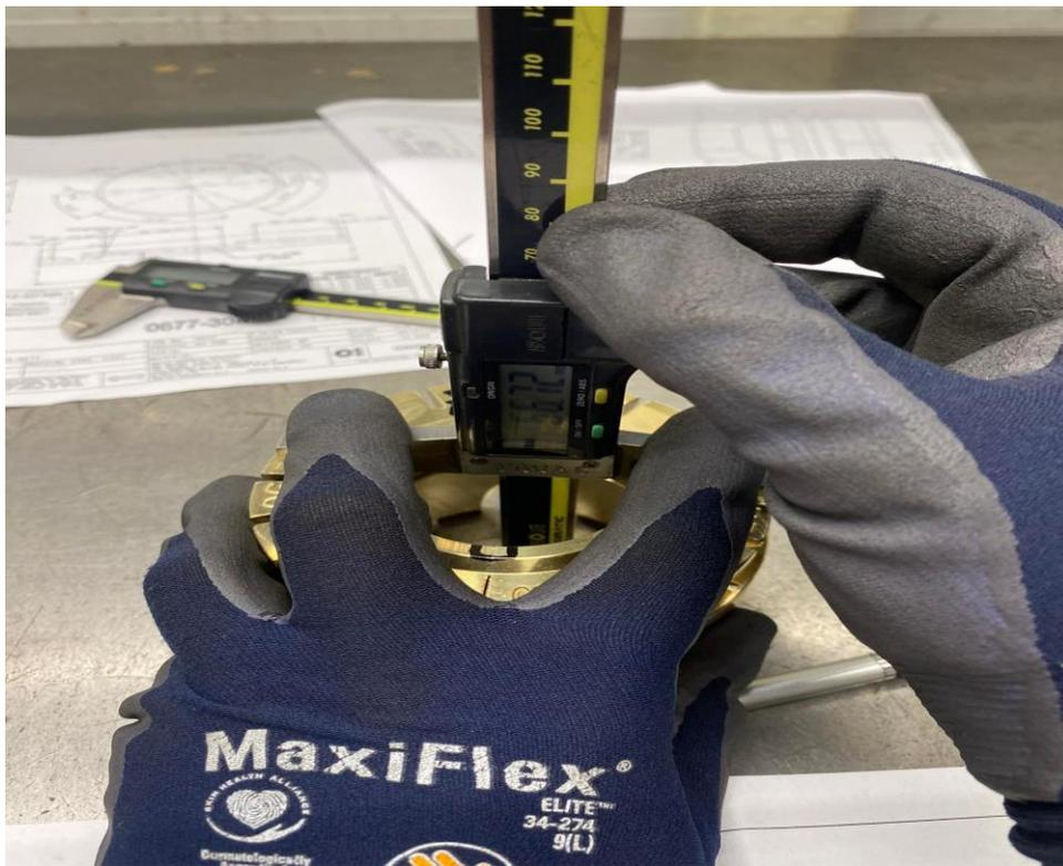
Slika 27. Mjerenje ukupne visine pomičnim mjerilom [28]
