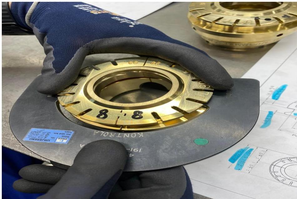
Slika 28. Mjerenje promjera prizme kalibrom [28]
