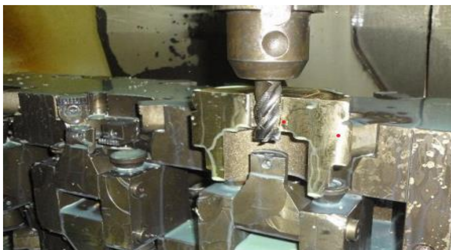
Slika 21. Glodanje promjera do metalizacije [27]
