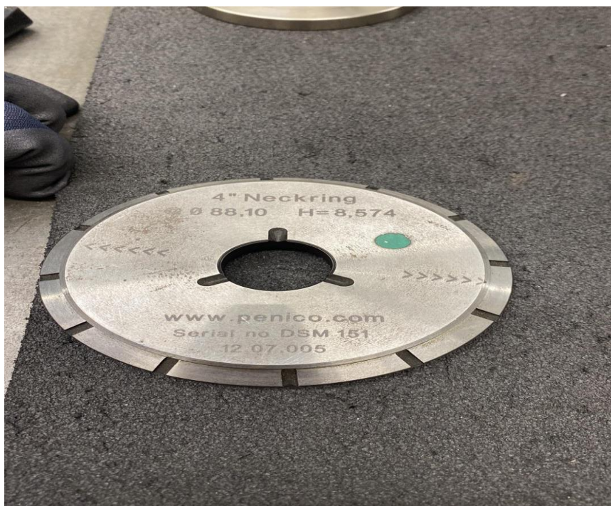
Slika 30. Etalon za provjeru [28]
