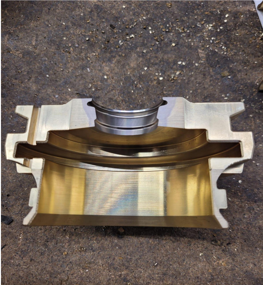
Slika 24. Grlo nakon tokarenja [28]
